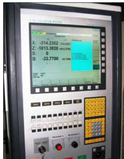
Eine moderne Dialogsteuerung auf Sinumerik-Basis sorgt für jede Menge Power beim CNC-Schleifen.
