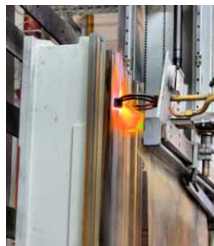
Via Flammhärten erhalten die Führungsbahnen der Betten die benötigte Härte.
