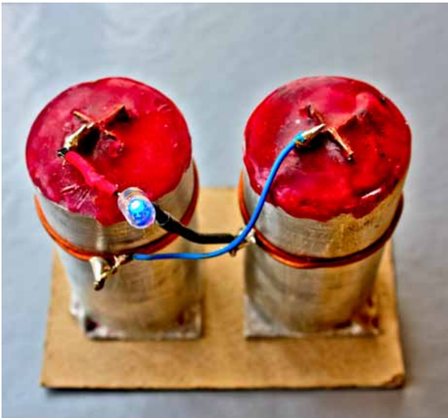
Die von Marcus Reid gebaute Kristallzelle ist bereits seit 13 Jahren in der Lage, eine LED-Lampe ununterbrochen zu betreiben.
