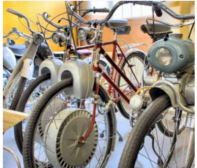
Ob Nabenmotor oder Fahrrad-Hilfsmotor, schon in den 1950er Jahren war die Wadenmuskeln entlastende Technik ähnlich populär wie heute E-Bikes.
