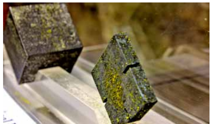
Als „Brennmaterial“ für den Forschungsreaktor in Haigerloch dienten Uranwürfel von fünf Zentimeter Kantenlänge. Die beiden hier ausgestellten Exemplare sind Originale von damals.
