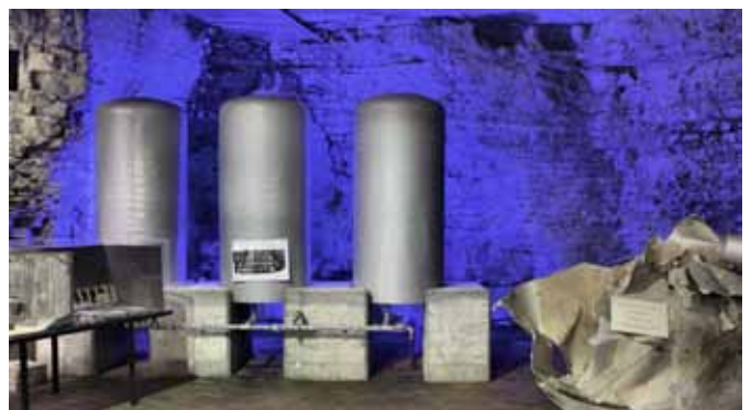
Schweres Wasser diente im Haigerlocher Reaktor als Regulator der Neutronen. Dieses wurde in Behältern gelagert, von wo aus es für Experimente in den Reaktor gefüllt wurde.
