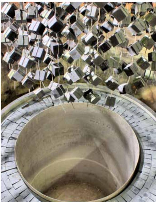
Der Reaktor von Haigerloch bestand aus einem Aluminiumkessel, der mit Kohleblöcken ummantelt war. Nach dem Fluten mit schwerem Wasser wurden die Uran-Würfel darin eingetaucht.
