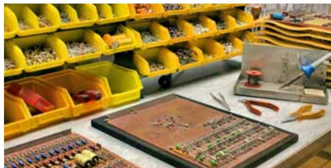
**Transistoren wurden früher von Hand auf Platinen verlötet.**
