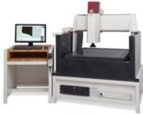
Messmaschine mit Anspruch: Die ›WM1 G‹ von Schneider.
