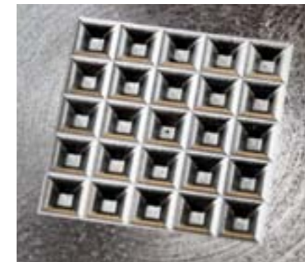
Ein winziger 0,2 mm Kugelfräser kam bei diesem Werkzeugteil zum Einsatz.
