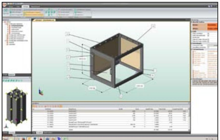
«iCAD Assembler» von Minitec ist ein leistungsstarkes 3D-Programm, dessen Datenbank mit allen Minitec-Bausteinen und Profilen bestückt ist, um daraus sehr einfach und rasch automatisierte Anlagen, Handarbeitsplätze oder Ähnliches zu konstruieren.
