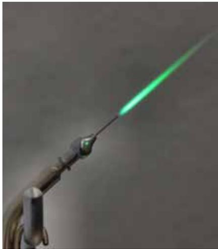
**Wird Gas durch einen mit Flussmittel gefüllten ›Booster‹ geleitet, wird die Flamme weicher und mit Flussmittel versetzt.**
