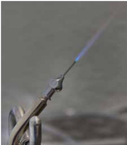
**Bis zu 2860 Grad Celsius erreicht eine Wasserstoff-Flamme. Deren nur geringe Größe ist ideal für kleine Werkstücke.**
