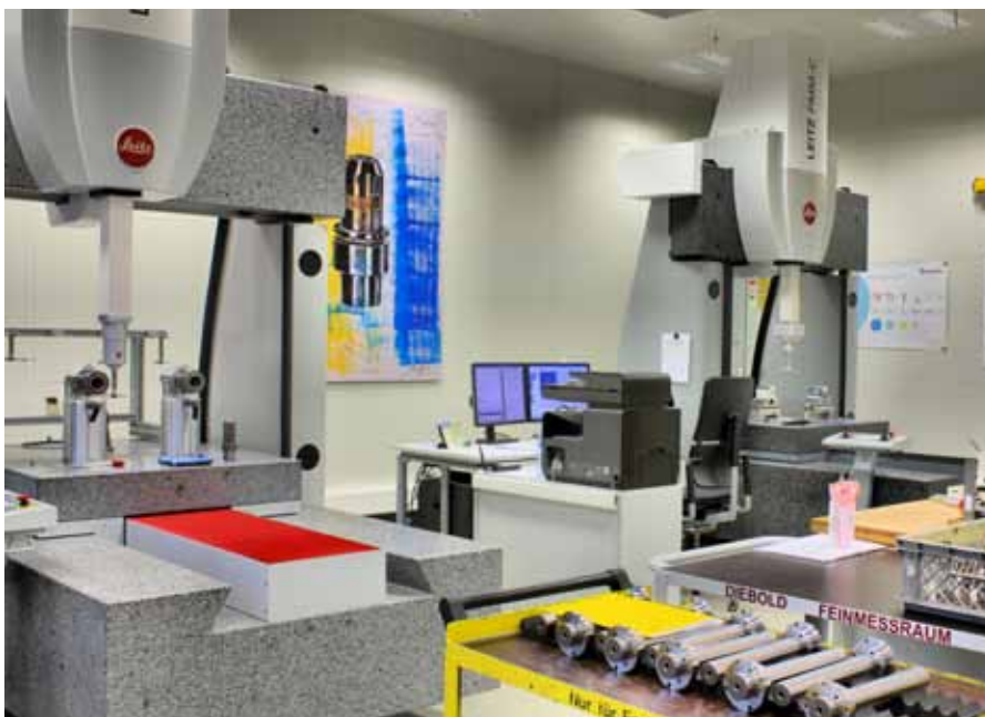
Zwei mittels Luftlager vom Boden entkoppelte Leitz PMM C-Messmaschinen sorgen dafür, dass Teile mit maximaler Präzision vermessen werden.
