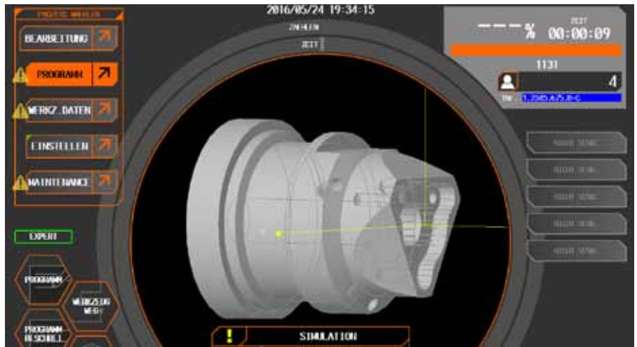
Eine räumliche Simulation erlaubt eine erste Einschätzung der Korrektheit des entworfenen NC-Codes.
