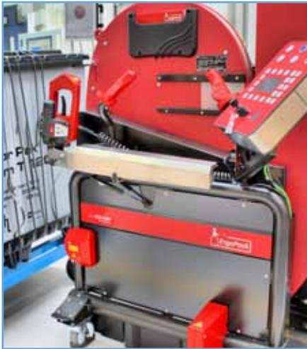
Mit einem Umreifungsgerät von Ergo-pack sind Behälter rasch verschlossen.
