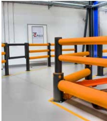
**Anfahrtschutzsysteme von A-Safe leiten Routenzüge sicher durch die Fertigung.**
