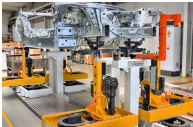
**Zahnstangengetriebe von Leantechnik machen Karosserie-Spannvorrichtungen flexibel. So werden auf demselben Montageband unterschiedliche Karosserievarianten fertigbar.**
