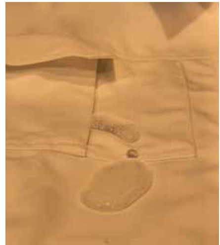
Spezielle Ausrüstungen und Gewebekonstruktionen machen die Arbeitskleidung schmutz- und wasserabweisend.
