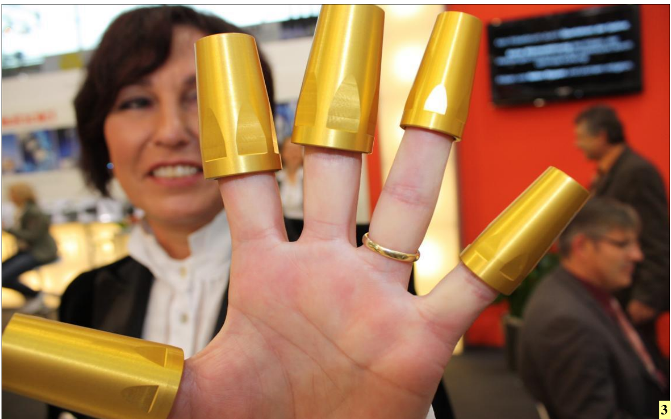
3 Die wichtigsten fünf Trümpfe des JetSleeve: 1. Der JetSleeve sorgt dafür, dass Fräserstandzeiten mindestens verdoppelt werden. 2. Fräserbruch durch überfahrene Späne gehört der Vergangenheit an. 3. Teure Schwallspülung wird durch günstige Minimalmengenschmierung ersetzt. 4. Die Anschaffungskosten sind sehr gering, da anders als beim Mediumverteiler keine Maschinenumbauarbeiten nötig sind. 5. Der JetSleeve ist robust konstruiert und kommt mit geringster Pflege und Wartung aus.
