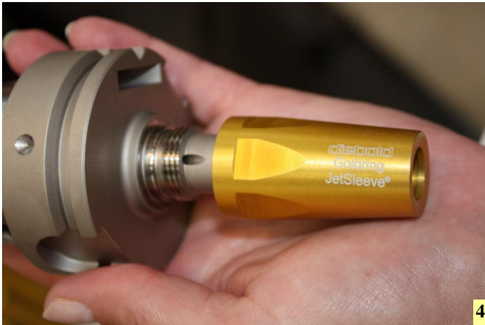
4 Der JetSleeve besteht aus einem Schrumpffutter mit drei eingebrachten Druckluftöffnungen und einer Hülse aus Aluminium. Mittels eines Drehmomentschlüssels werden die Komponenten absolut sicher verschraubt, sodass selbst kurz hintereinander erfolgende Abbrems- und Beschleunigungsvorgänge der Arbeitsspindel die Verbindung nicht lösen können.
