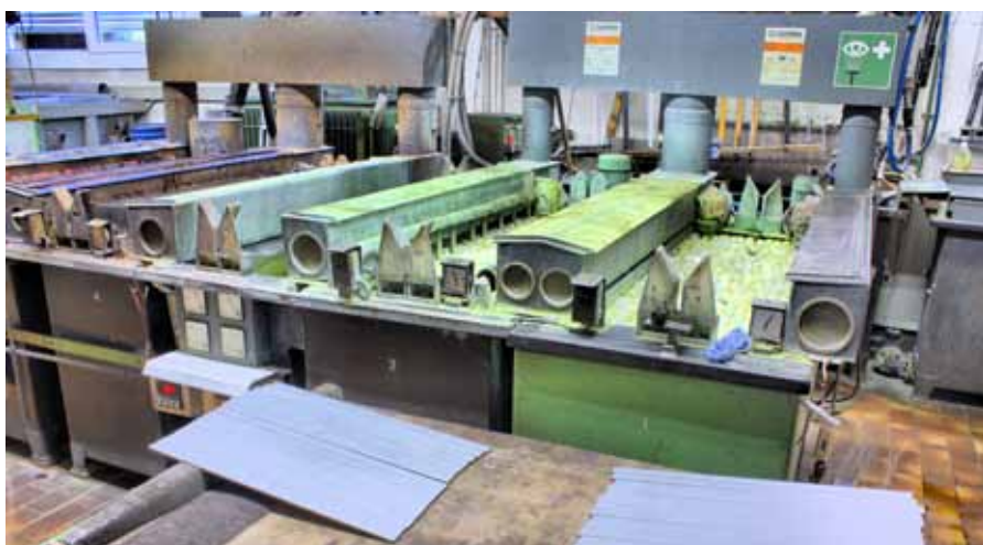
Eine eigene, vollautomatische Galvanikanlage sorgt dafür, dass die Messschieber eine Beschichtung erhalten, die das blendfreie Ablesen der Skala erlaubt.
