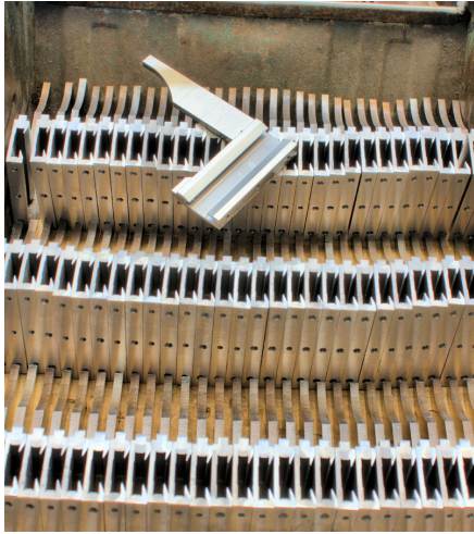
Engste Toleranzen des Schiebers sind Voraussetzung, sollen Messschieber bis auf 0,05 Millimeter genau messen.
