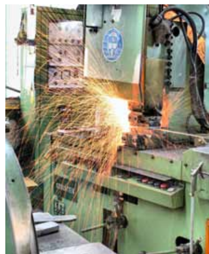
Per Abbrennstumpfschweißen werden die Messschieberteile zusammengeführt.
