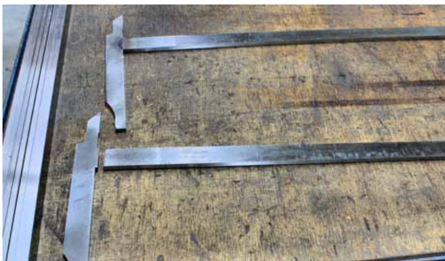
Die Produktion von Messschiebern ist ein Akt, zu dem viel Erfahrung gehört. Das beginnt bereits beim Fügen von festem Messschenkel und Stab.
