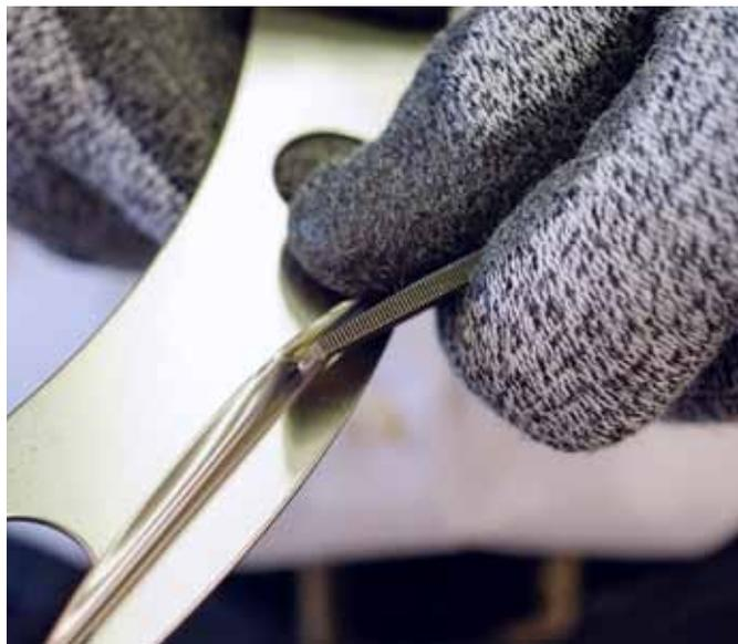
Manuelles Abschälen eines laminierten Passrings vom Typ »M-Tech L« in der Wälzlagermontage.
