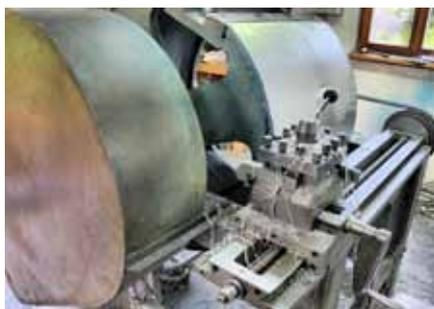
Die selbst gegossenen Bleche werden auf eine Trommel aufgespannt und per Drehbank auf die gewünschte Dicke abgedreht.
