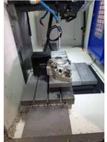
Die Rückseitenbearbeitung übernimmt das Brother-BAZ ›Speedio S 700 X1‹, das mit einem CNC-Drehtisch ›EA-510‹ von pL Lehmann ausgerüstet ist.
