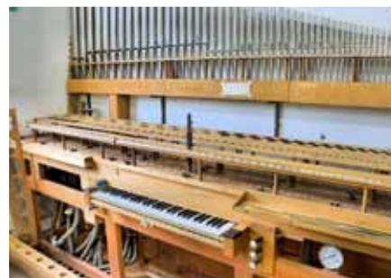
Fertig produzierte Orgelpfeifen können bei Eisenbarth mittels einer Testorgel ausführlich und sehr einfach auf ihren Klang geprüft werden.
