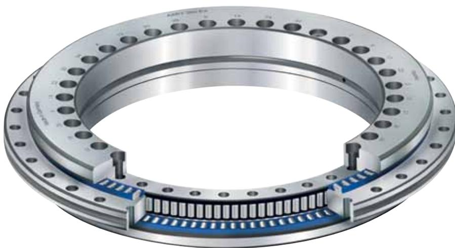
Höchste Genauigkeit wird mitgeliefert: Die zweiseitig wirkenden, anschraubbaren und einbaufertigen Lagereinheiten der AXRY-Reihe bestehen aus zwei Axial- und einem Radiallager, die zum Beispiel bei Rundtischen oder Fräsköpfen Verwendung finden.
