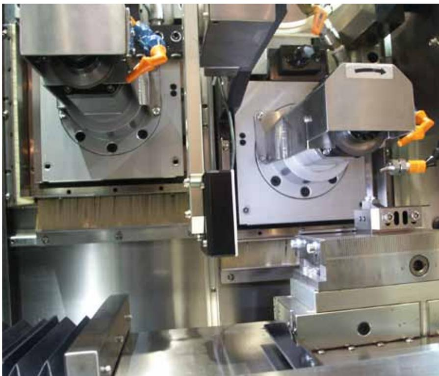
Die ›UPZ210 Lill-2 Double Eagle‹ ist ausgerüstet mit zwei Schleifspindeln. Damit entfällt die Notwendigkeit zum Scheibenwechsel beim Vor- und Fertigschleifen.
