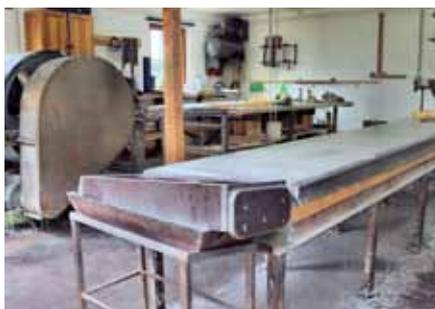
Die besonderen Legierungen für die hochwertigen Pfeifenbleche werden bei Eisenbarth mittels eines Gasofens sowie einer Gießbank selbst hergestellt.
