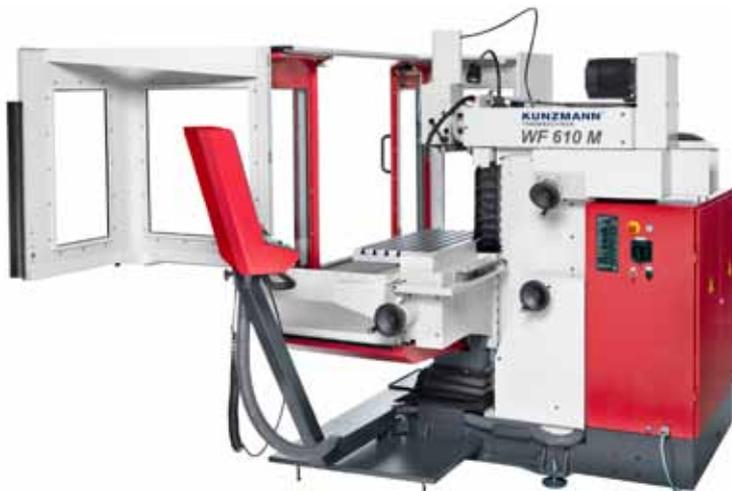
Während Werkstücke im Automatikbetrieb mit geschlossenen Türen bearbeitet werden, wird beim manuellen Fräsen von Einzelteilen und Kleinserien oft ein offener Arbeitsraum gewünscht. Dadurch kann die Bearbeitung schneller beeinflusst werden. Voraussetzung ist jedoch, dass alle Betriebsarten ein sicheres Arbeiten erlauben.
