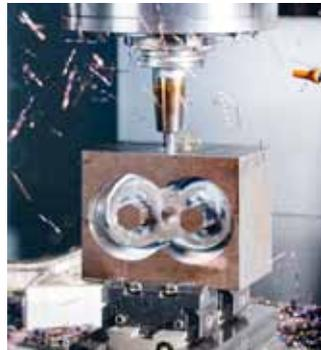
Durch das Trochoidalfräsen kann die Standzeit der Werkzeuge bis um ein Zehnfaches verlängert werden, die Bearbeitungszeiten reduzieren sich um 30 bis 40 Prozent.
