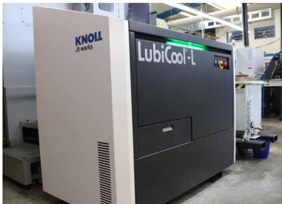
Die kompakte Hochdruckanlage ›LubiCool-L‹ von Knoll ist in erster Linie für Drehmaschinen sowie kleine und mittlere Bearbeitungszentren ausgelegt.
