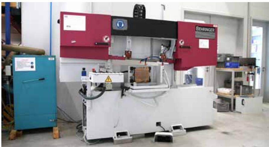
Die ›HBE320-523 3D‹ basiert auf der bereits etablierten HBE Dynamic-Baureihe und wurde von Behringer speziell zum Trennen additiv gefertigter Bauteile entwickelt.
