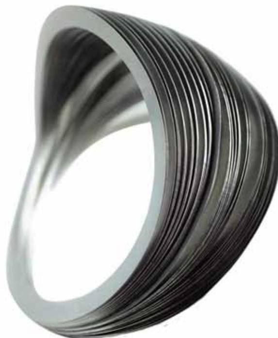
Die randverschweißten beziehungsweise laminierten Passringe lassen sich bis auf 0,005 mm genau abziehen oder abschälen.
