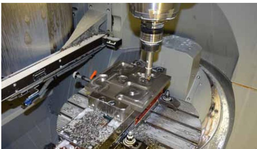
Mithilfe eines Referenzteils konnte das Dämpfungsverhalten der Fräser an unterschiedlichen Stahllegierungen ermittelt werden.
