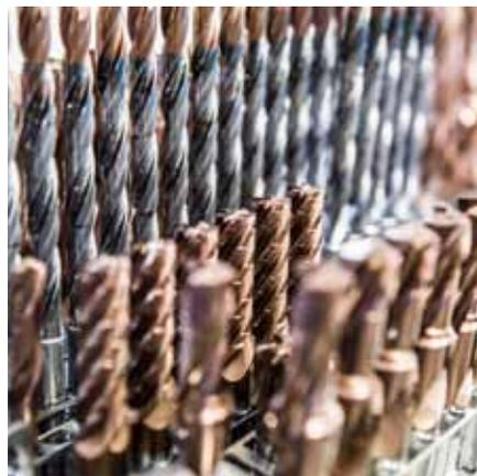
Tests zeigten, dass die Werkzeuge mit der Beschichtung ›MC 3100‹ doppelt so viele Bohrungen durchführen können.
