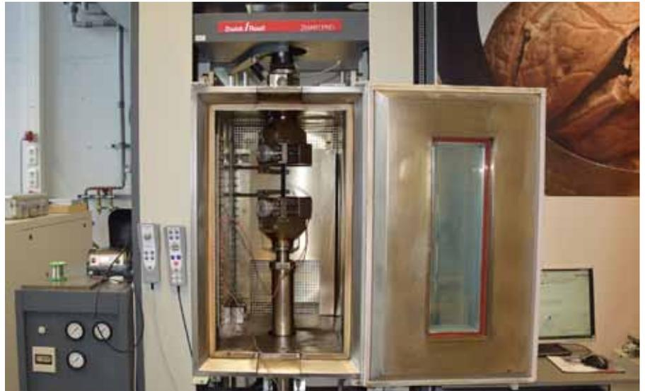
Die Zugversuche an den FVK-Prüfkörpern wurden mit einer Universalprüfmaschine Typ 1475 des Herstellers ZwickRoell mit mechanischen Keilspannbacken unter quasi-statischen Bedingungen nach Norm durchgeführt.
