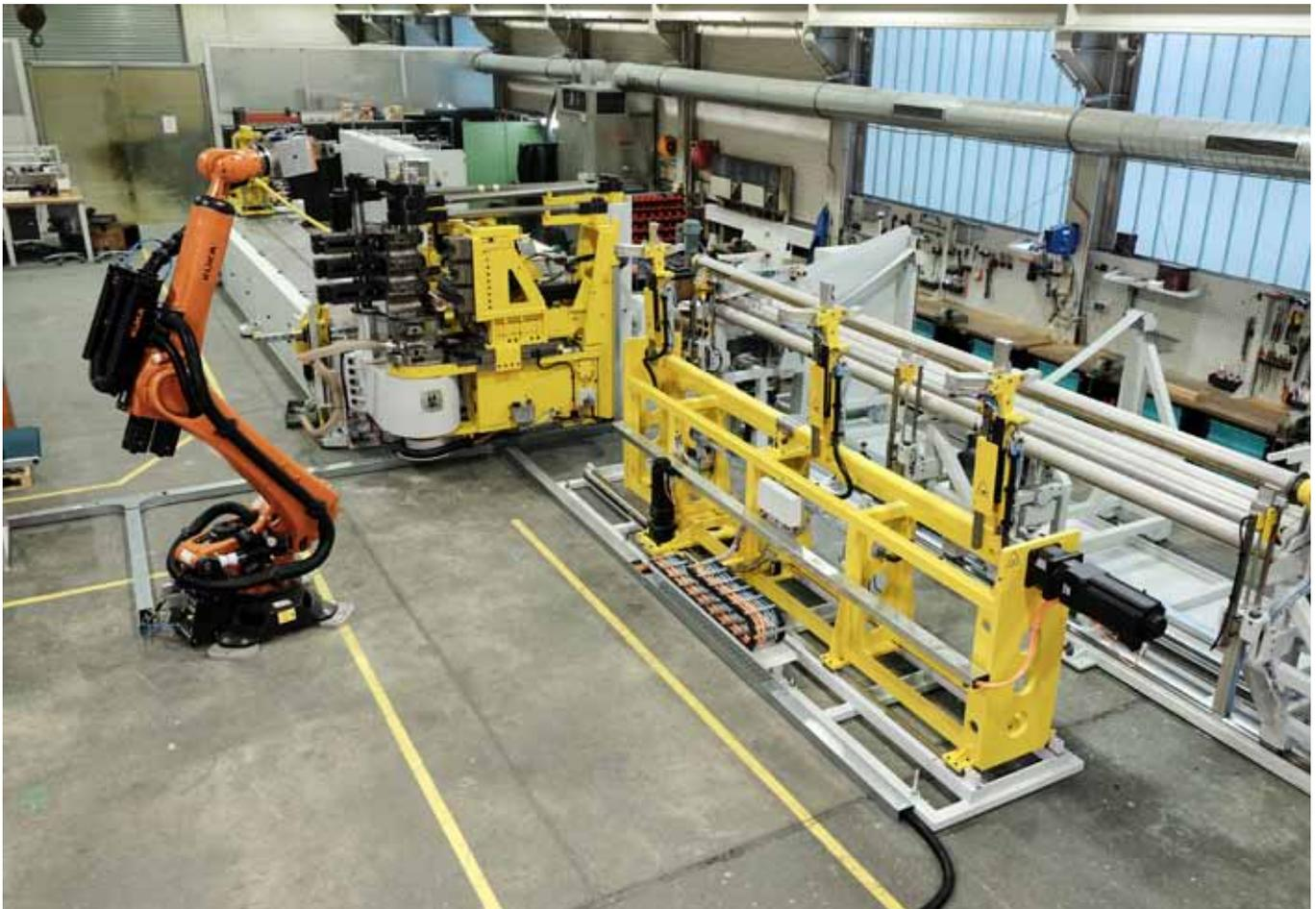
In der vollautomatisch ausgebauten Rohrbiegezone laufen alle Arbeitsschritte samt vor- und nachgeschalteten Prozessen sicher, fehlerfrei, wiederholgenau und schnell ab.
