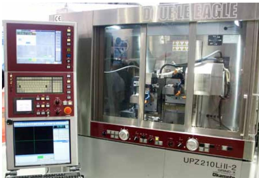
Mit der ›UPZ 210 Li II-2‹ erhält der Anwender ein Performance-Paket, mit dem er dank zweier Schleifspindeln die Produktivität deutlich steigern kann.
