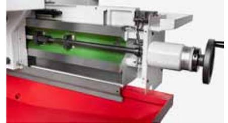
Bei Kunzmann-Maschinen wird die entkuppelte Position der Handräder ständig mit jeweils zwei Sensoren pro Achse überwacht.
