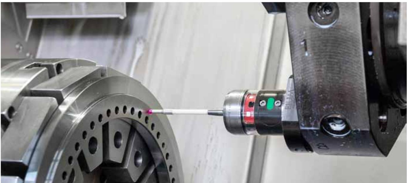
Antast sicher auch im Kühlmittel: Der Blum-Taster »TC52« wird auf den Hembrug Horizontal-Hartdrehmaschinen über den Revolver in Position gebracht. Deshalb muss der Taster nicht nur hochgenau, sondern mechanisch besonders robust ausgelegt sein.
