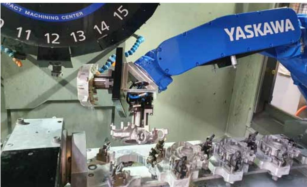
Vorderseitenbearbeitung mit der ›Brother Speedio S 1000 X1‹: Auf dem Lehmann-CNC-Drehtisch ›EA-520‹ ist eine Vierfach-Spannvorrichtung montiert, in die der Motoman-Roboter Rohteile einlegt und bearbeitet wieder entnimmt.
