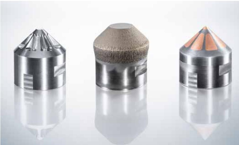
Nach dem Ausfräsen der Taschen trägt die ›C 42 U MPA‹ Kupferpulver auf. Im Anschluss wird überflüssiges Material wieder abgetragen.
