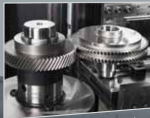
Prüfung von Härteverzügen mittels Helix-Test
