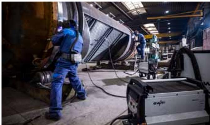
Bei der Gebrüder Stahl GmbH hat das WIG-Schweißen in großen Teilen das konventionelle MAG-Handschiessen abgelöst – und dank des WIG-Drahtvorschubsystems »tigSpeed« von EWM gleichzeitig sowohl die Schweißgeschwindigkeit als auch die Schweißqualität gesteigert.
