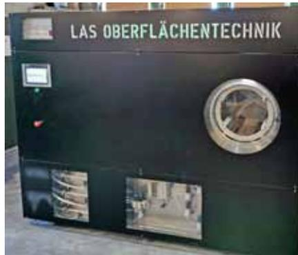
**Die neue, selbst entwickelte Universal-Reinigungsanlage mit drei unterschiedlichen Bädern kann vollautomatisch Ultraschallreinigen, Spritzen, Spülen und Trocknen.**
