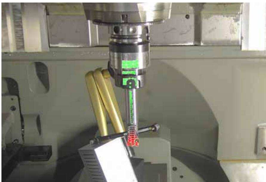
**Experimentelle Modalanalyse mittels moderner Messtechnik – Impulshammer und Laser-Doppler-Vibrometer.**
