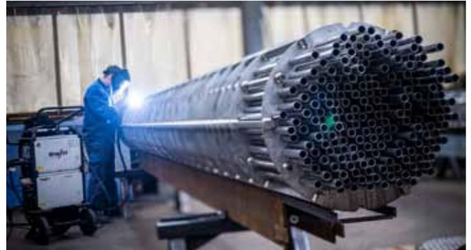
Auch das manuelle WIG-Schweißen kommt noch bei Gebrüder Stahl zur Anwendung. In diesem Fall bei Verstrebungen eines Rohrbündels aus Duplex 1.4462 mit 180 Röhren Ø25 x 2mm.
