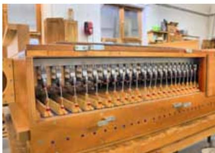
Moderne, elektromechanische Ventiltechnik wird im Orgelbau ebenso verwendet, wie Jahrhundertlang bewährte Schleifladentechnik, die mit besonders hoher Zuverlässigkeit überzeugt.
