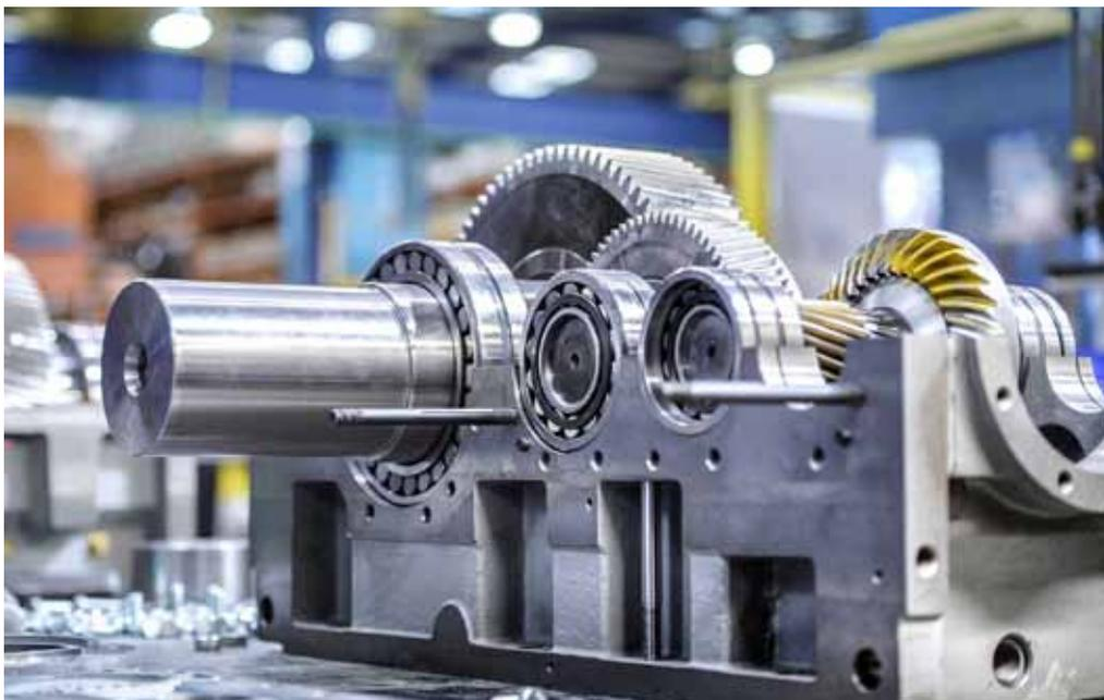
Wälzlager-Baugruppe im Getriebebau: Für die axiale Spieleinstellung in der Montage setzen Hersteller die anwendungsspezifisch konfigurierten Passringe und Zwischenlagern von Martin ein.
