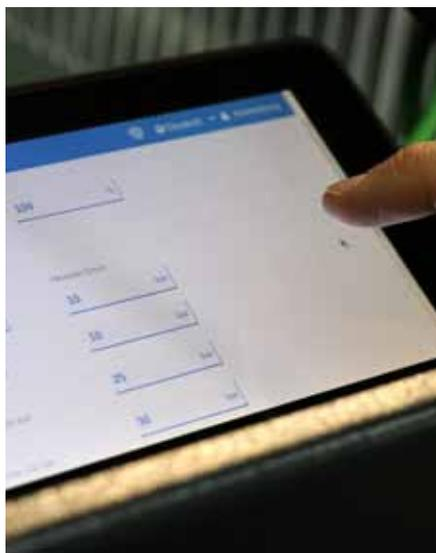
**Über das SmartConnect-Bedienfeld kann der Bediener die Druckstufe einfach und schnell auswählen.**
