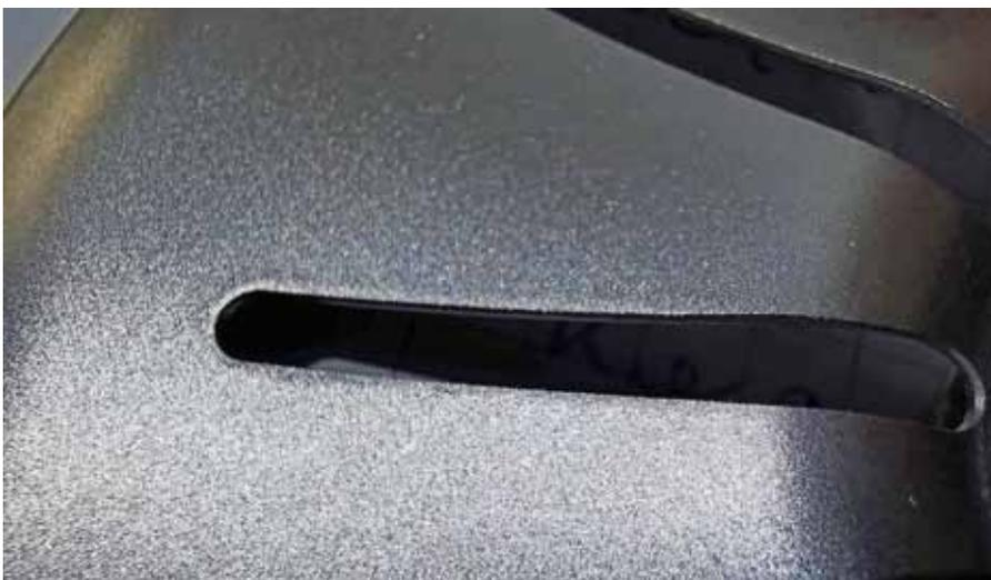
**Glatfrei, fleckenfrei und seidengmatt gestrahlt:** Typische Anforderungen an metallische Komponenten für die industrielle Fertigung.
