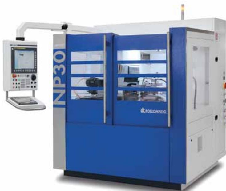
Die Rundschleifmaschine NP30 von Rollomatic unterstützt Werkzeughersteller mittels bekannter Schälschleifmethode bei gleichzeitigem Einsatz der Schrupp- und Schlichtscheibe bei der Bearbeitung von Rohlingen.
