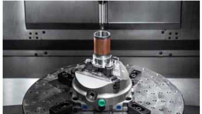
Ein Rohling mit gefüllten Kupfertaschen. Im nächsten Schritt werden diese durch Auftragen von Stahl verschlossen.
