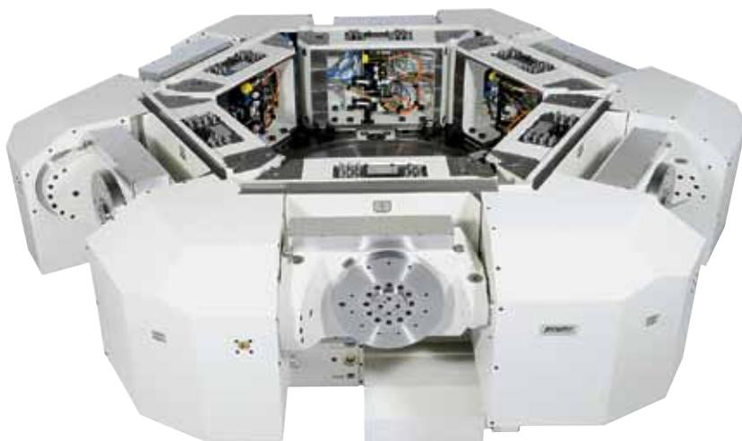
Der Rundtaktisch von Peiseler verfügt über sechs Zweiachs-Schwenkeinrichtungen vom Typ ›ZATC 300‹, die auf dem Basistisch ›ATU 1600‹ rotieren.
