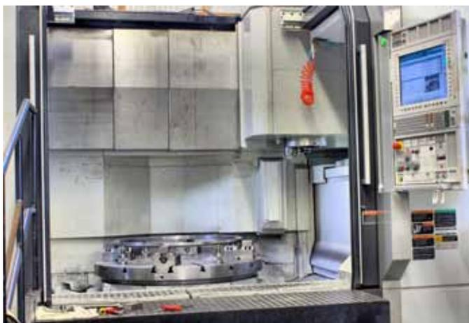
**Auf der Mori Seiki NVL 1350 MV können bis zu zwei Meter große Teile durch Drehen und Fräsen komplett bearbeitet werden.**
