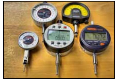
Digitale Anzeigen erleichtern auch bei Messuhren, die etwa in Prüfvorrichtungen Verwendung finden, das Ablesen.
