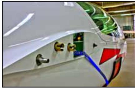
Eine ausgeklügelte Konstruktion erlaubt den raschen Zusammenbau eines DG-Segelflugzeuges via Stecksystem.
