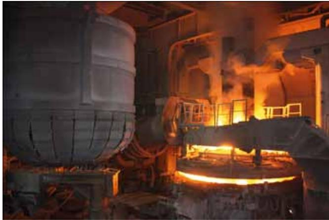
Im Elektrolichtbogenofen schmilzt Swiss Steel hochwertigen Eisenschrott – den Rohstoff für den ›Swissbain-7MnB8‹.
