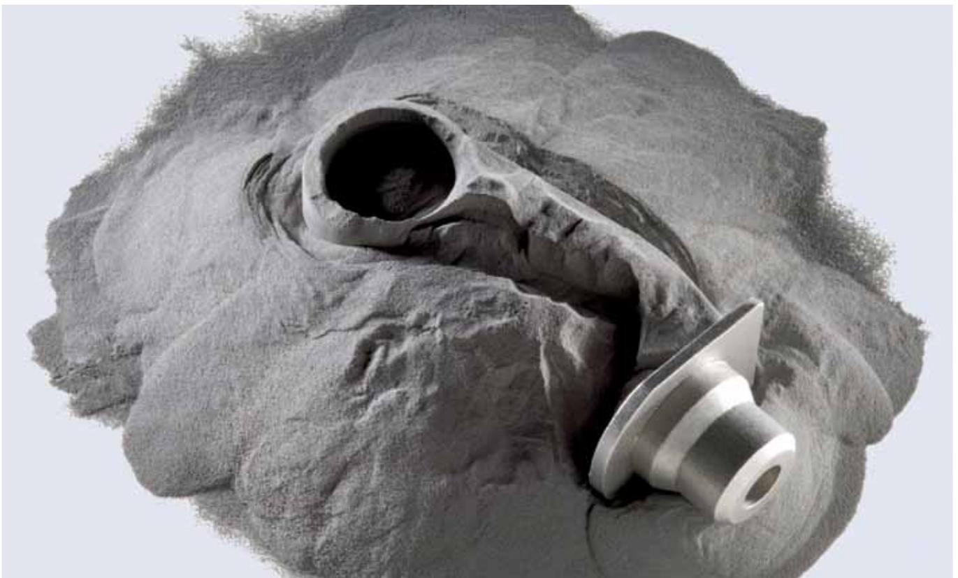
Für belastbare Bauteile, die per Laserschmelzen hergestellt werden sollen, benötigt die Industrie hochleistungsfähige Metalle und Legierungen in Pulverform.
