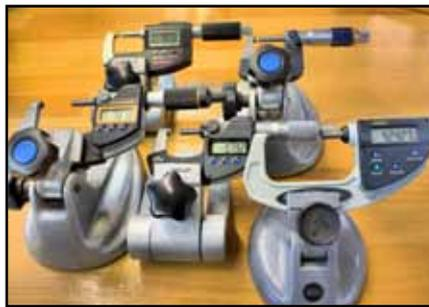
Digitale Bügelmessschrauben eignen sich besonders für exakte Messungen in der Maschine. Ablesung: bis zu 0,001 mm.
