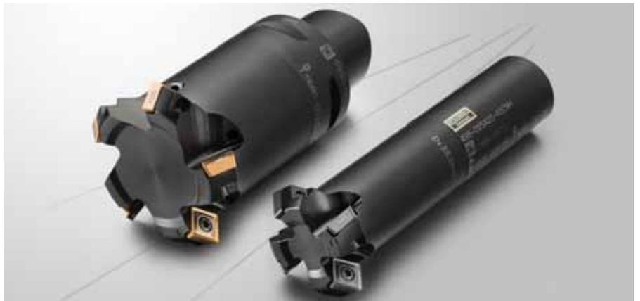
Schneidkanten und eine höchstmögliche Anzahl an Platten auf dem Fräser. Er ist sowohl für herkömmliche Fasanwendungen auf der Bauteiloberseite als auch für das rückwärtige Anfasen geeignet. Darüber hinaus kann der universelle Fräser sowohl für Vorarbeiten für das Schweißen und Entgraten als auch für Planfräsbearbeitungen eingesetzt werden. Der CoroMill 495 ist für die Herstellung von 15-, 30-, 45- und 60 Grad-Faswinkeln konzipiert.
