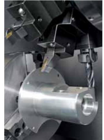
Flächen, Schlitze und auβermittige Bohrungen sind dank der Y-Achse präzise herstellbar.
