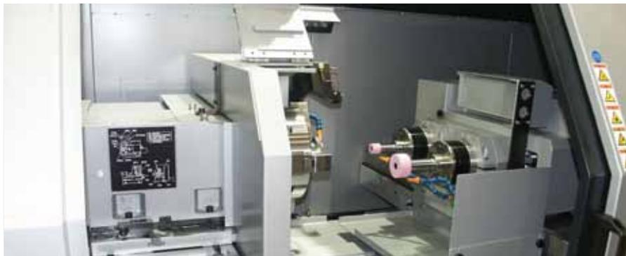
Schnelligkeit und Präzision vereint die Innenrundschleifmaschine ›IGM 15 NC III‹ von Okamoto. Hochfrequenzspindeln sorgen für die nötige Performance.
