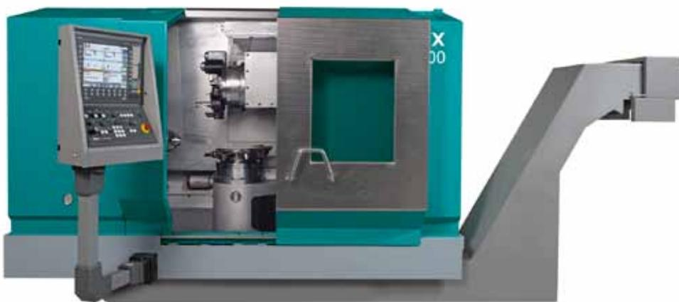
In Verbindung mit einer „Intelligenten Y-Achse“ im oberen Revolver und einem zusätzlichen unteren Multifunktionsrevolver bietet die IT600 von Index eine hohe Leistungsdichte.
