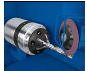
reichschleiffuttern sinkt die Rüstzeit mit Prismo3 um bis zu 70 Prozent. Zusätzlich sparen Anwender die Investition in Zwischenbüchsen und Spannzangen. Da die X-Achse unabhängig vom Werkzeugdurchmesser stets unverändert bleibt, ist es möglich, unterschiedlichste Bohr-, Reib- und Fräswerkzeuge auch in kleinen Stückzahlen ohne umständliche Neuprogrammierung des L1-Maßes mannos zu bearbeiten.
