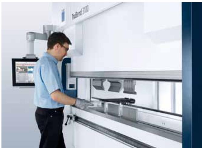
Die TruBend 3100 bietet einen sicheren Arbeitsplatz. Dafür sorgen der »BendGuard«, ein Fußtaster und die LED-Beleuchtung.
