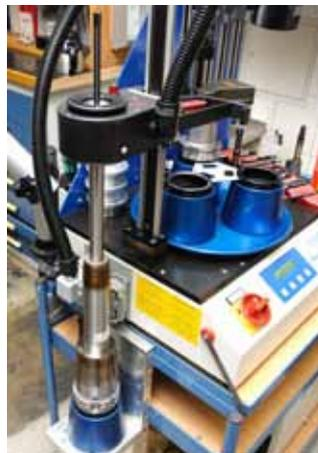
Ein drehbarer Turm ermöglicht das Schrumpfen sehr langer Werkzeuge.
