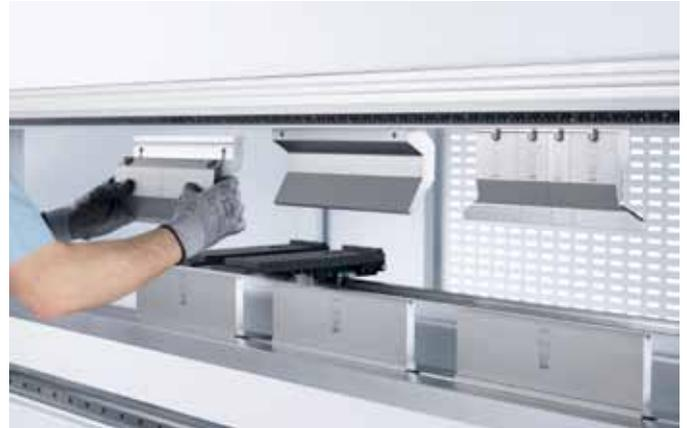
Das Rüsten der TruBend 3100 ist einfach, denn ein vertikales Einsetzen der Werkzeuge ist möglich.
