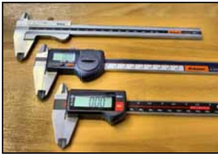
Auch für Messschieber mit Digitalanzeige gilt die DIN 862. Eine Messgenauigkeit von 0,01 mm ist daher ausgeschlossen.
