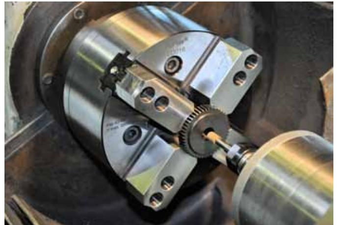
Mit dem Vierbackenfutter ›InoFlex‹ von HWR können Zahnräder nach der Wärmebehandlung exakt zentrisch gespannt werden.
