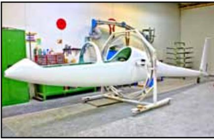
Die beiden Flugzeughälften werden in einem Ofen bei 60 Grad Celsius getempert und so unlösbar verbunden.
