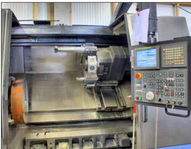
Eine ›Puma‹ von Doosan sorgt mit zwölf angetriebenen Werkzeugen für Effizienz beim Zerspanen anspruchsvoller Drehteile.
