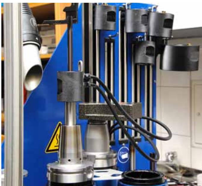
**Schnelles Erkalten:** Für unterschiedliche Schrumpfaufnahmen sind maßgeschneiderte Kühlkörper vorhanden, um die Wärme per Kontaktkühlung über einen Wasserkreislauf abzuführen.
