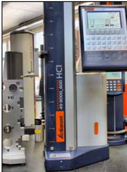
Moderne digitale Höhenmessgeräte, wie das »HC1«, bieten eine Luftlagerung und einen Betrieb mit motorischer Antastung.
