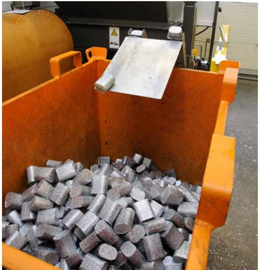
Bei Alcutec werden die Frässpäne vollautomatisch verpresst. Sobald ein Sensor Aluminiumspäne im Sammeltrichter erkennt, startet die Spänpresse von Ruf.
