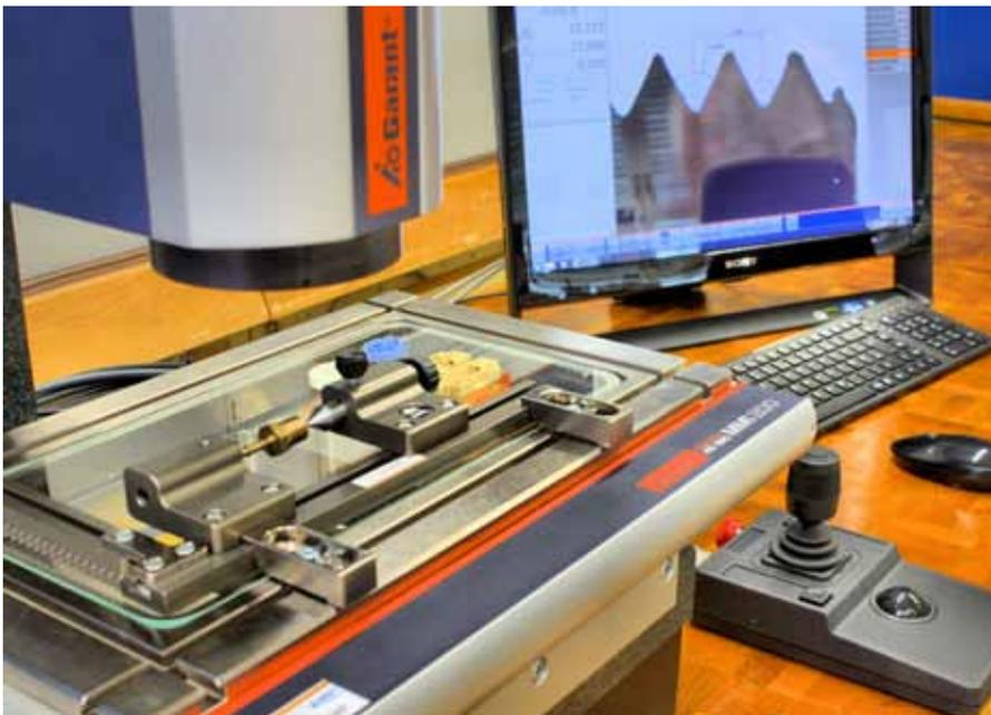
Moderne Messmikroskope, wie das Modell ›MM1/200CNC‹ der Hoffmann Group, ermöglichen auch das präzise Messen von Wellen. Sogar die Gewindemessung ist damit rasch und irrtumsfrei möglich.
