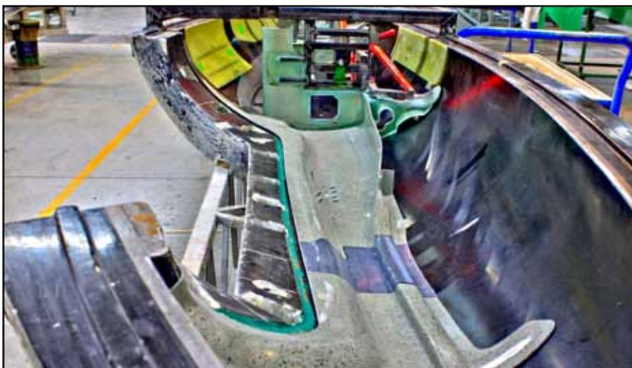
Das Cockpit muss besonders stabil gebaut sein, weshalb in diesem Bereich die High-tech-Materialien ›CFK‹ und ›Kevlar‹ eingesetzt werden.
