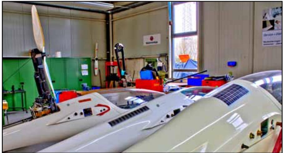
Moderne Bautypen, wie etwa die »DG 1001 M«, besitzen nicht nur Solarzellen für die Unterstützung der Stromversorgung, sondern auch einen ausklappbaren Motor.
