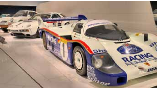
Der Unterboden des Rennwagens ›956‹ wurde speziell geformt, sodass dieser an die Fahrbahn gesaugt wird, was es Fahrern ermöglicht, mit höherer Geschwindigkeit durch Kurven zu fahren.
