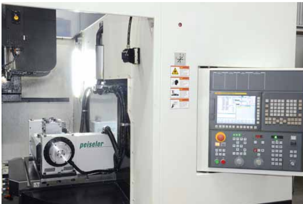
Die eine Hälfte des Wechsellisches mit einer der beiden Zweiachs-Schwenkeinrichtungen von Peiseler. Hinter der Plexiglasscheibe ist die gerade im Bearbeitungsraum positionierte Seite des Palettenwechslers zu sehen. Durch diese hauptzeitparallele Spannmöglichkeit konnte AVCI den Output um 20 Prozent steigern.
