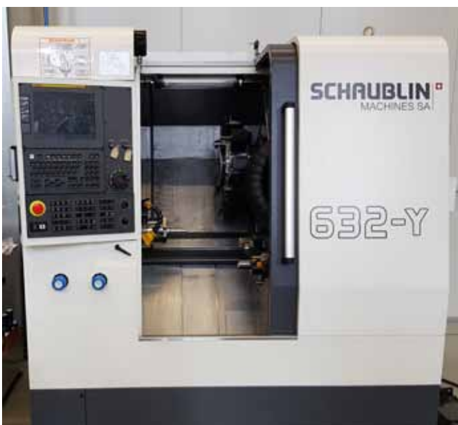
Schaublins Hochpräzisions-Drehmaschine ›632-Y‹ erlaubt die Bearbeitung von Stangenmaterial bis zu Härten von 65 HRC.
