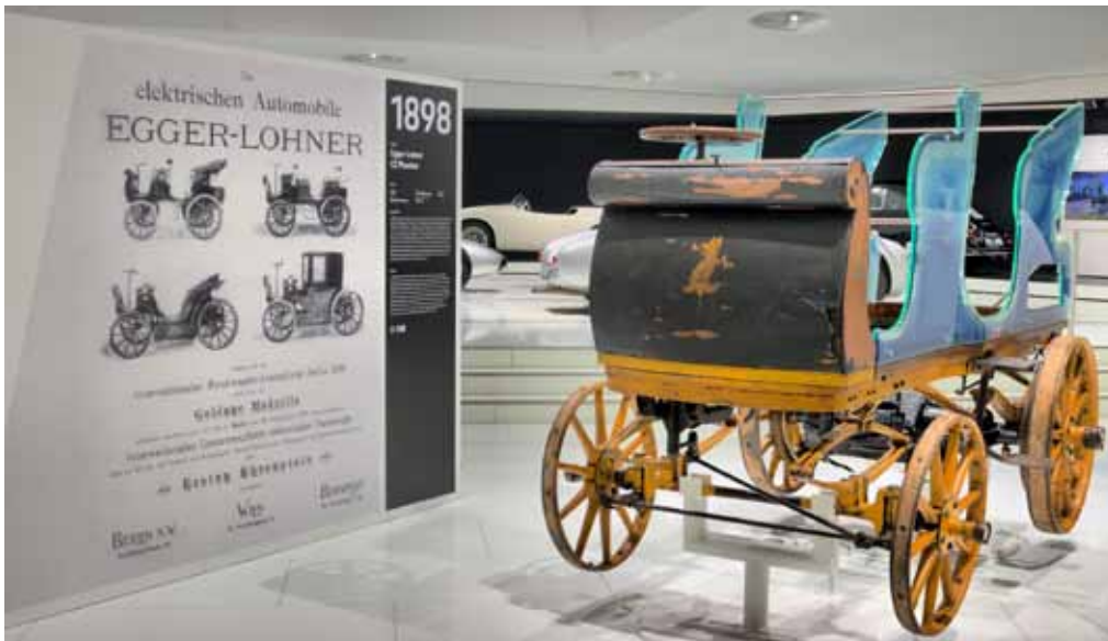
Beim Kutschenfabrikanten Lohner baute Ferdinand Porsche im Jahre 1898 sein erstes Elektroauto. Dieses besaß eine Reichweite von 80 km und erreichte eine Höchstgeschwindigkeit von 25 km/h.
