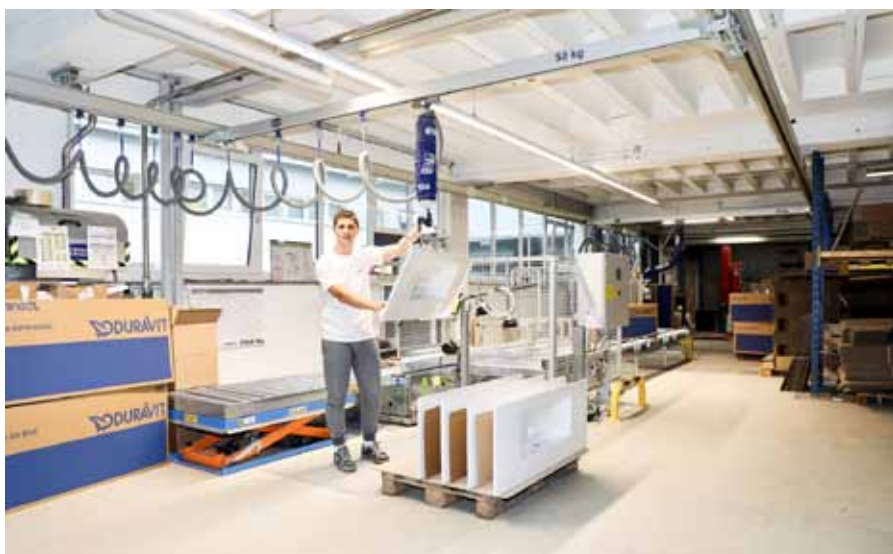
Die Duravit AG setzt beim Verpacken auf Schlauchheber von Schmalz. Das reduziert körperlich anstrengende Tätigkeiten und krankheitsbedingte Ausfälle.
