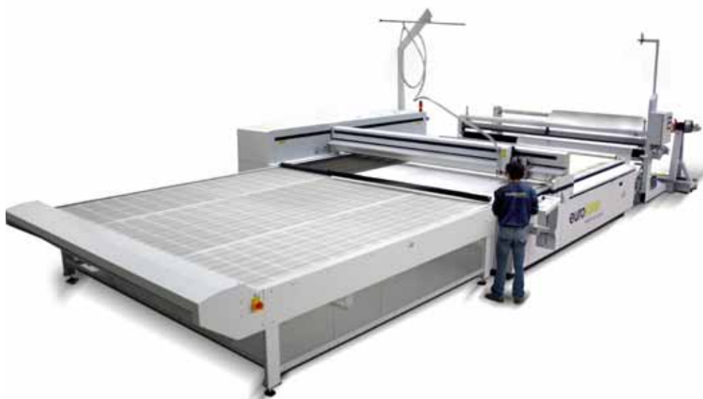
Der Riese unter den eurolaser-Schneidsystemen: ›3XL-3200 Conveyor‹ mit Abwickleinheit. Die Maschine ist spezialisiert auf das Schneiden von Textilien mit Rollenbreiten von bis zu 3400 mm.
