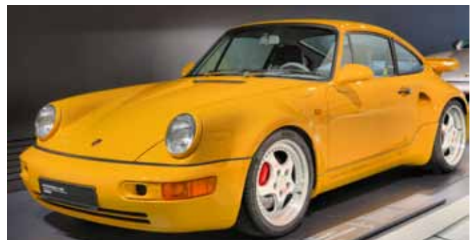
Die Grenzen des Leichtbaus lotete Porsche mit dem im Jahre 1992 gebauten Modell ›911 Turbo S 3,3 Leichtbau‹ aus. Hier wurde aus Gewichtsgründen etwa auf elektrische Fensterheber verzichtet.
