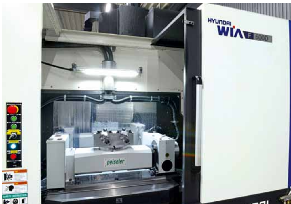
Die Peiseler-Schwenkeinrichtung in der Werkzeugmaschine von Hyundai WIA bei AVCI in Solingen. Erstmals setzte das Remscheider Unternehmen mit dieser Lösung eine mittig platzierte Planscheibe um und realisiert damit einen größeren Störkreis.
