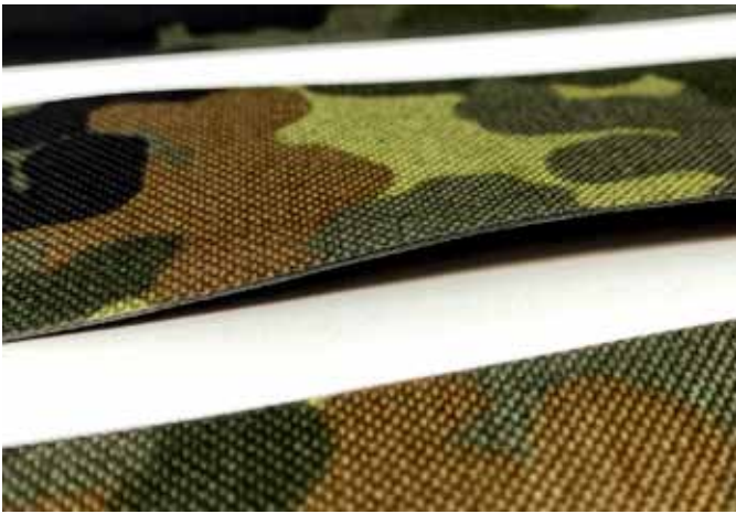
Saubere Schnittkanten bei PSA-Textilien: Herkömmliche Messer oder Stanzen wären sehr schnell stumpf, zudem können die Kanten ausfransen.
