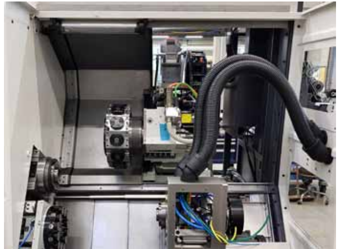
Haupt- und Gegenspindel sowie ein motorisierter Hauptrevolver mit 12 x 12 Werkzeugpositionen bieten die Möglichkeit angetriebener Werkzeuge.
