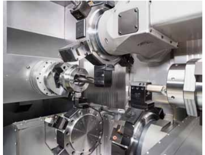
Die G400 bietet drei VDI-40-Revolver mit zwölf Stationen für die ausgesprochen produktive Bearbeitung langer und schwerer Werkstücke.
