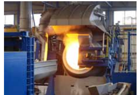
Den Kipp-Drehtrommelöfen werden Späne nur in brikettierter Form zugeführt.
