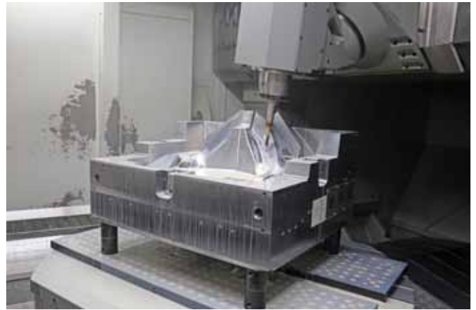
Gerade bei großen Bauteilen trägt das FCS-Nullpunktspannsystem zu störkonturfreier Fünfseiten-Bearbeitung bei.
