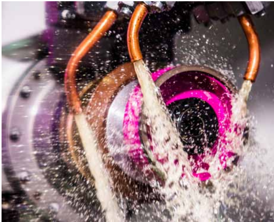
Ein Vorteil des ›ToolGrind HSS-X 1400‹ der oelheld GmbH ist die deutliche Reduzierung von Schleifbrand und eine geringe Gratbildung.
