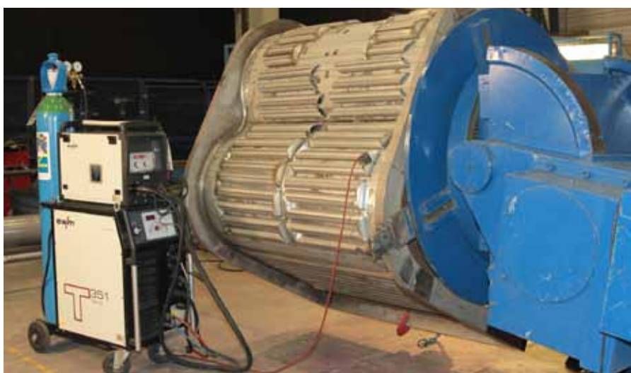
Die Kombination aus WIG-Heißdraht und ›tigSpeed‹ reduziert bei AST die Schweißzeit um bis zu 40 Prozent.
