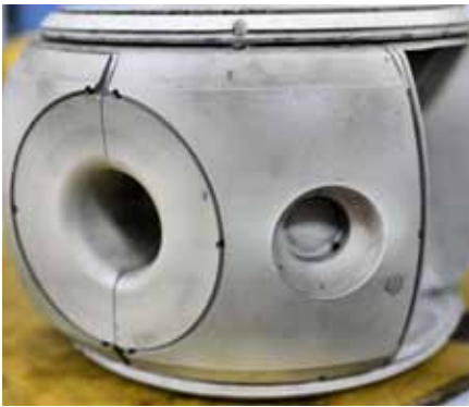
Die linke, trichterförmige Öffnung dient zum Ansaugen des vom Vergaser kommenden Gemisches.
