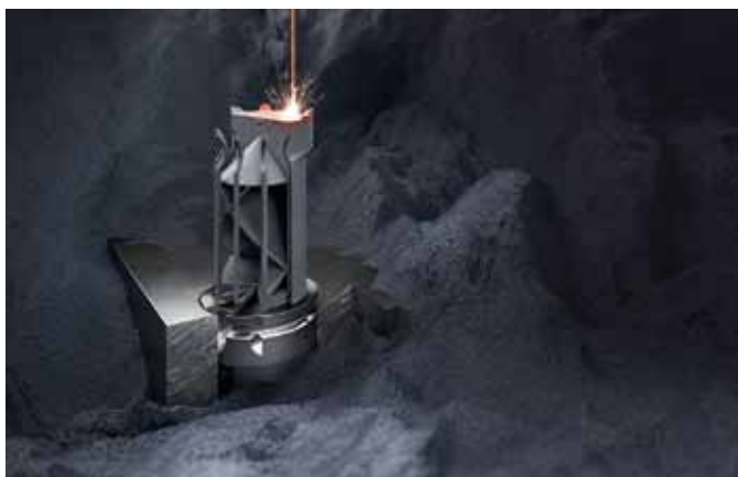
Funktionsintegration und Leichtbaustrukturen sichern kürzere Zykluszeiten dank dem selektiven Laserschmelzen.
