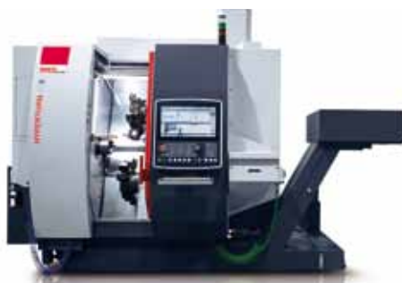
Die ›Hyperturn 45|G3‹ von Emco ist ein hochleistungs-Drehzentrum für die Komplettbearbeitung.
