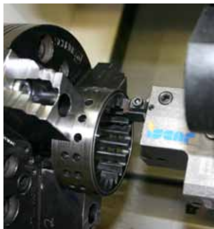
Drallfreies Hartstechwerkzeug von Iscar bei der Bearbeitung eines innenverzahnten Getriebebauteils.
