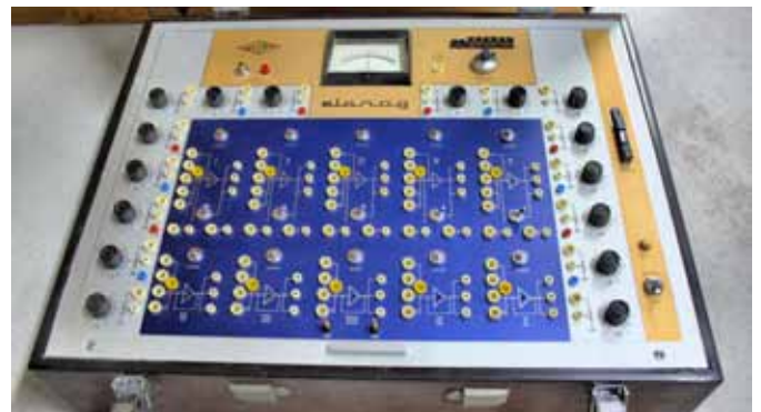
Der Ausbildungsrechner »Elanag« ist der wohl der schönste tragbare, analoge Rechner. Er ist in einem Holzgehäuse untergebracht und konnte so nach Unterrichtsende rasch verstaut werden.
