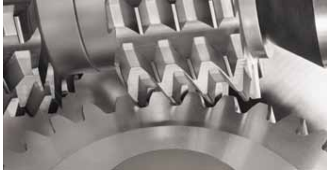
Das Anfaswälzfräsen von Gleason ermöglicht präzise Fasen nach Kundenspezifikation – bei minimalen Werkzeugkosten.
