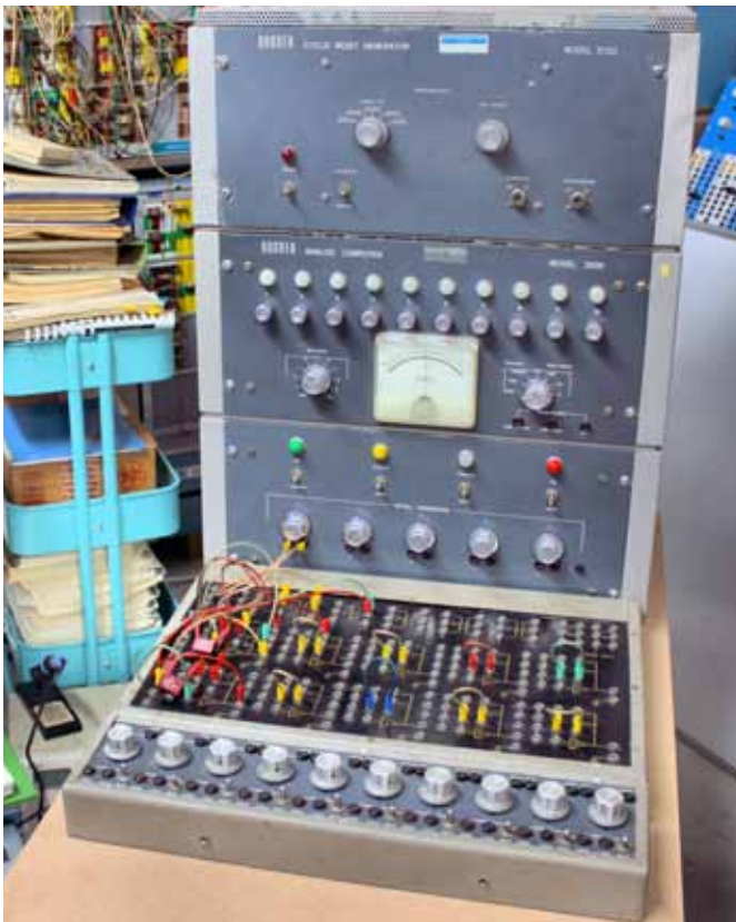
Das Unternehmen Donner war ein bekannter US-Hersteller analoger Rechner und baute Ende der 1950er Jahre das Modell 3000, das mit zehn Verstärkern ausgestattet war.
