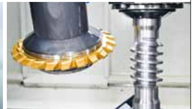
Schneckenfräsmaschine LC 80 WD Hauptzeitparalleles Anfasen und Bürsten
