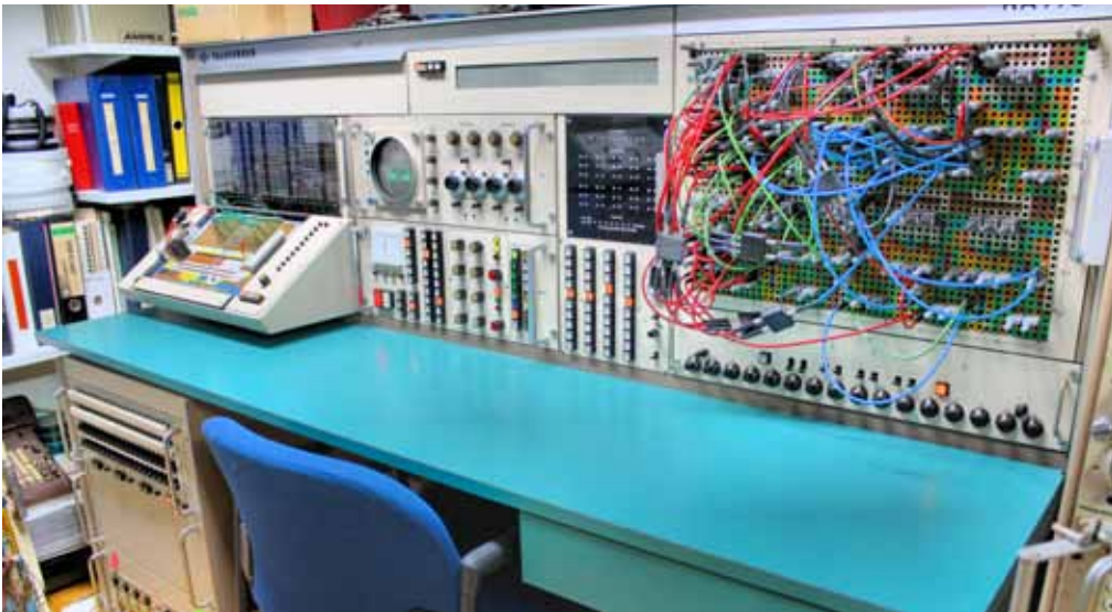
Der »RA 770« von Telefunken wurde Anfang der 1970er Jahre gebaut und ist ein Präzisionsanalogrechner, der im Forschungszentrum Jülich im Einsatz war. Da Mäuse viel Schaden am Innenleben angerichtet hatten, war die Restaurierung sehr aufwendig.
