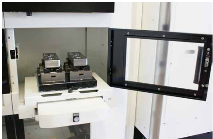
VARIAXIS j-600 – Jede Palette kann individuell hauptzeitparallel gerüstet werden
