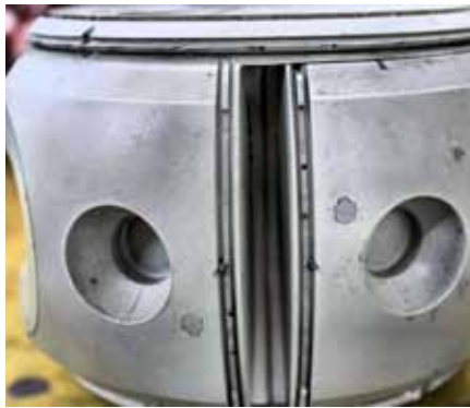
Während der Weiterbewegung verdichten die zusammengehenden Hälften der Kugelkolben das Gemisch.
