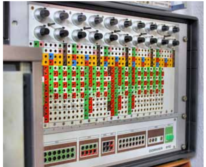
Der »DO 910« von Dornier ist ein Hybridrechner – besteht also aus einem Analogrechner, der mit einem Digitalrechner verzahnt ist – und wurde für Pharmakologie-Berechnungen verwendet.
