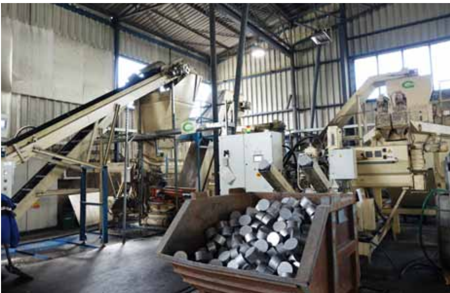
Bei MT Comax sind zwei Ruf-Brikettieranlagen im Einsatz, die dafür sorgen, dass aus lose zugelieferten Aluminiumspänen kompakte Briketts werden.
