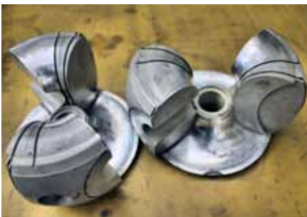
Die zwei Kugelkolben werden auf einer Schwenkachse ineinander gesteckt.
