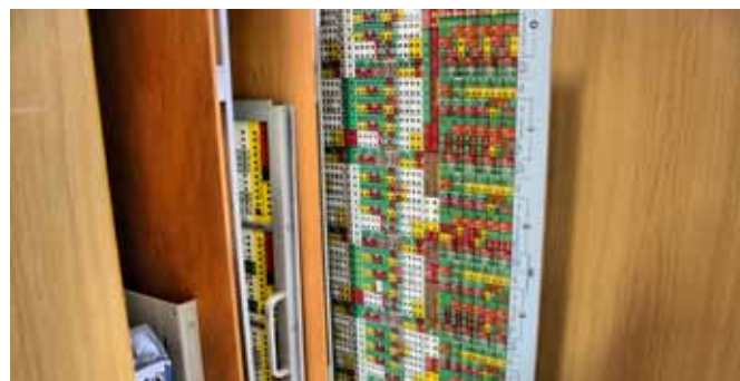
Abnehmbare Steckbretter waren „Speicher“ für Analogrechner.
