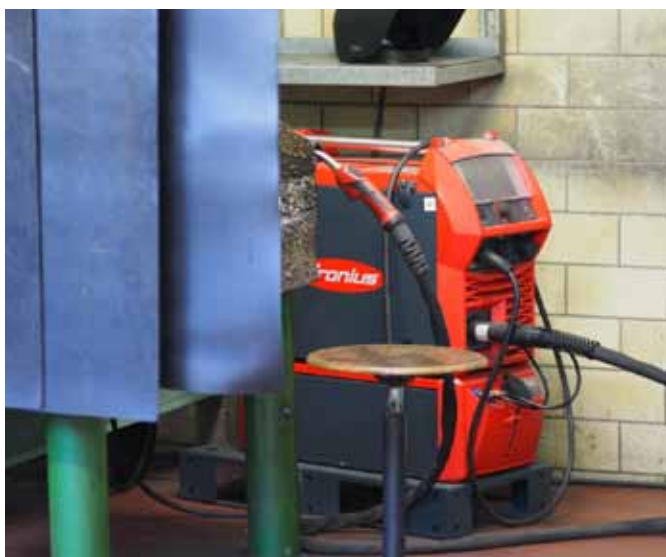
Im Standby-Modus warten acht ›TPS 320i‹ auf Teilnehmer und sind bei Betätigung des Brenntasters sofort schweißbereit.
