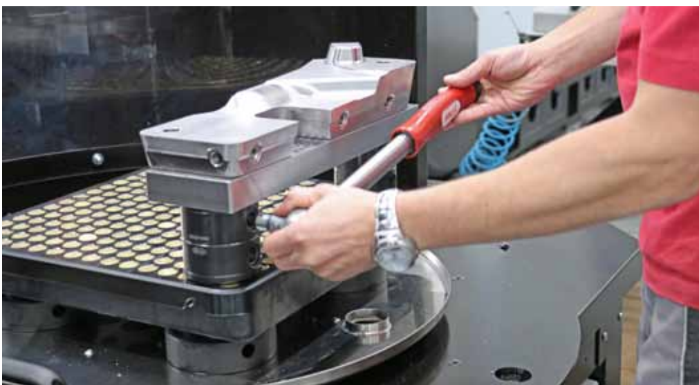
Mit dem Nullpunktspannsystem von FCS lassen sich kleine und große Bauteile schnell und einfach rüsten. Wenige Handgriffe genügen, um das Bauteil zu spannen.
