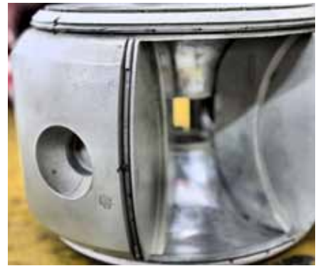
Das Gemisch wird von den Zündkerzen zur Explosion gebracht, wodurch die Kugelkolben auseinandergetrieben werden.
