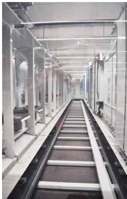
Palletech High Rise System mit 2 Ebenen im Einsatz bei einem Hersteller von Pumpengehäusen. Das System versorgt 5 verkettete Maschinen vom Typ HCN6800
