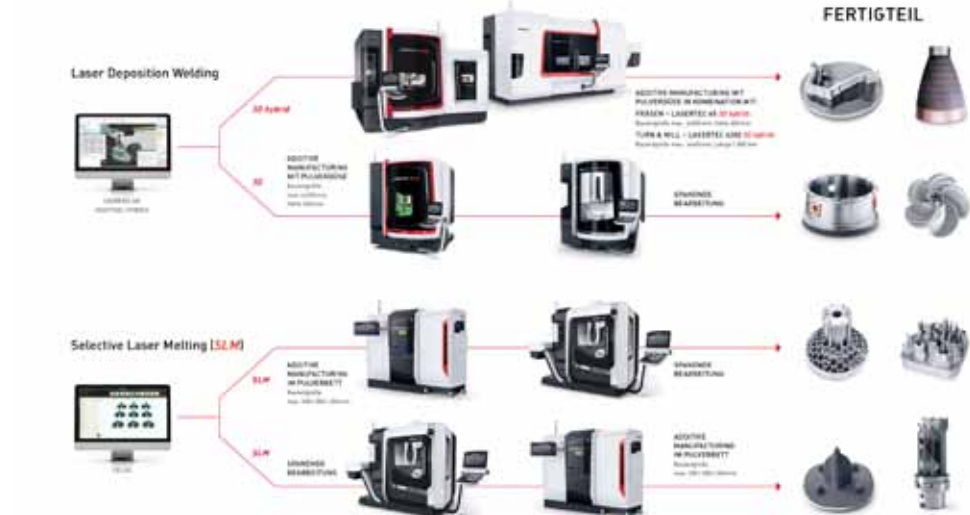
Das Portfolio von DMG Mori umfasst vier vollständige Prozessketten für additive Verfahren mit der Pulverdüse und im Pulverbett.
