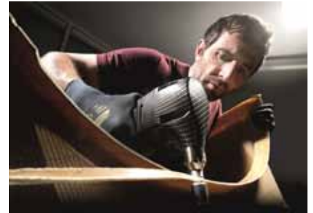
Das ›Trutool FCN 250‹ von Trumpf ermöglicht exakte Trennschnitte.
