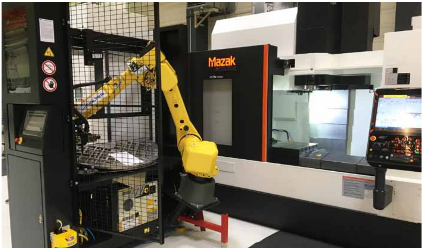
Hochproduktives vertikales Bearbeitungszentrum VCN mit direkt integriertem Beladeroboter. Die Mazak RL 60-3-Zelle integriert einen Knickarmroboter, der den Werkzeugwechsel und das Be- und Entladen der Teile übernimmt.
