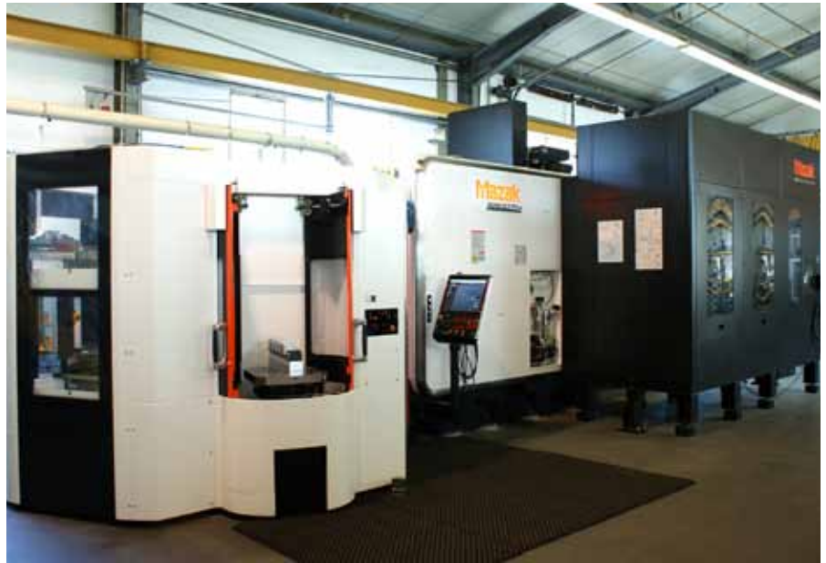
VARIAXIS i-700 mit 12-fach MPP-Palettenspeicher auf der linken und einem Werkzeugmagazin ›Tool Hive‹ auf der rechten Seite.
