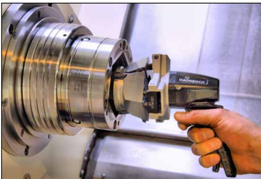
Mit seinem Spannmittel-Baukasten hat Hainbuch ein innovatives System im Angebot, das für Spannzangen- beziehungsweise Spannköpfe-, Spanndorn- und Backenspannungen gleichermaßen geeignet ist.
