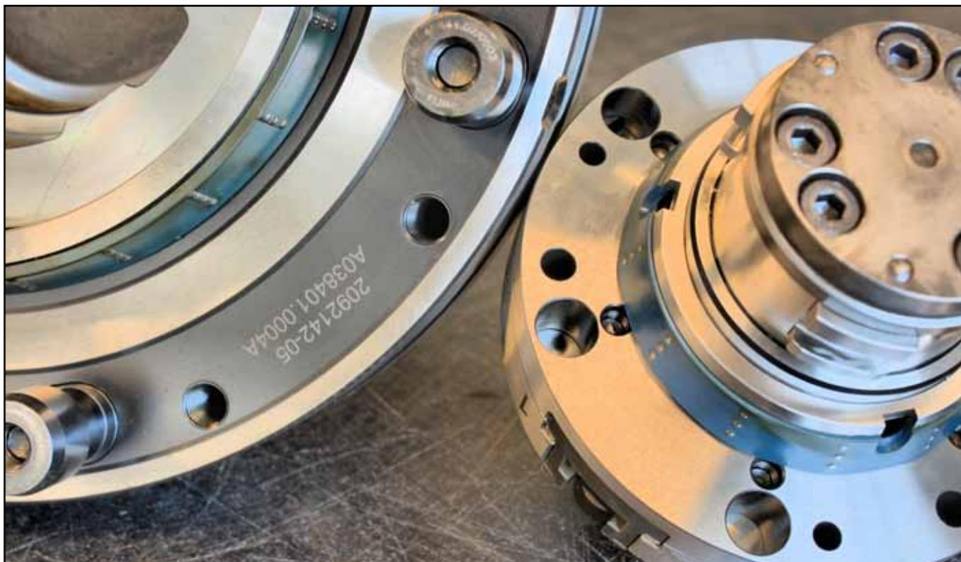
Das Geheimnis der hochgenauen Zentrierung: Die Centrex-Schnittstelle mit kleinen Kugeln in einer vulkanisierten Fassung. Schmutz hat kaum Möglichkeiten, sich negativ bemerkbar zu machen. Der Lohn: Eine Wiederholgenauigkeit besser als 0,002 Millimeter.
