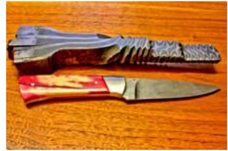
Geschickte Hände formen aus geschmiedeten und verdrehten Werkzeugstahl-Blechen hochwertigen Damaszenerstahl für ausgesprochen edle Messer mit hohem Sammlerwert.
