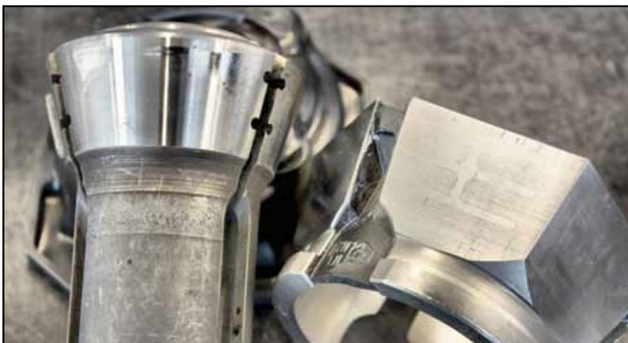
**Im Vergleich zu einer herkömmlichen Spannzange, bei der vor allem im vorderen Bereich punktuell Spannkraft übertragen wird, zeigt das Tragbild eines Toplus-Kopfes (rechts) die bessere Kraftübertragung über die gesamte Spannlänge.**
