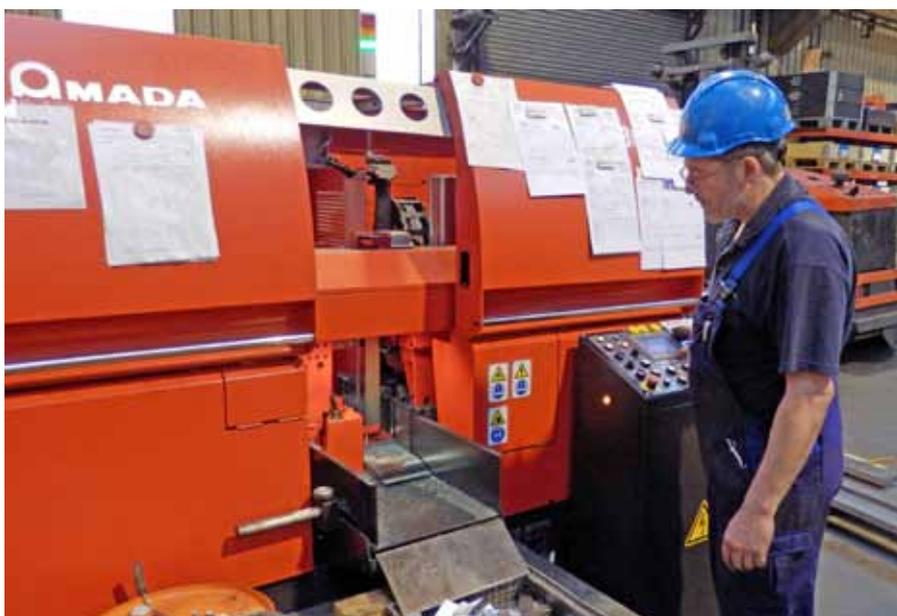
Kurze Abschnittlängen werden auf der ›PCSAW 330‹ von Amada mit hoher Wiederholgenauigkeit in Serie gesägt. Der Sägebereich ist gut zugänglich.
