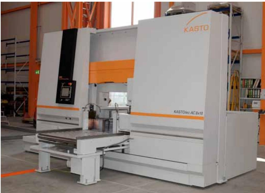
Der Hochleistungs-Bandsägeautomat ›Kastotec A 8x10‹ besitzt einen großen Arbeitsbereich und wartet mit einem Vorschub-Spannstock für die reproduzierbare Material-Positionierung auf.
