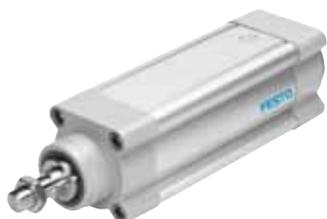
newton ungewöhnlich starke Zylinder hat einen 1500 mm langen Hub und erreicht eine Geschwindigkeit von 1,35 m/s. Er legt dabei über sein gesamtes Läuferleben etwa 10 000 Kilometer klaglos zurück. Beim Positionieren mit dem Elektrozyylinder »ESBF« mit Kugelgewindespindel bieten sich viele Alternativen. Unterschiedliche Motoren und Controller erlauben frei wählbares Positionie-
