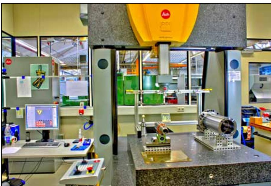
Eine luftgelagerte CNC-Messmaschine von Leitz, die in einem Messraum der Güteklasse 2 steht, garantiert, dass ausschließlich Gutteile in die Montage kommen, wo sie zu kompletten Spindeln montiert werden.
