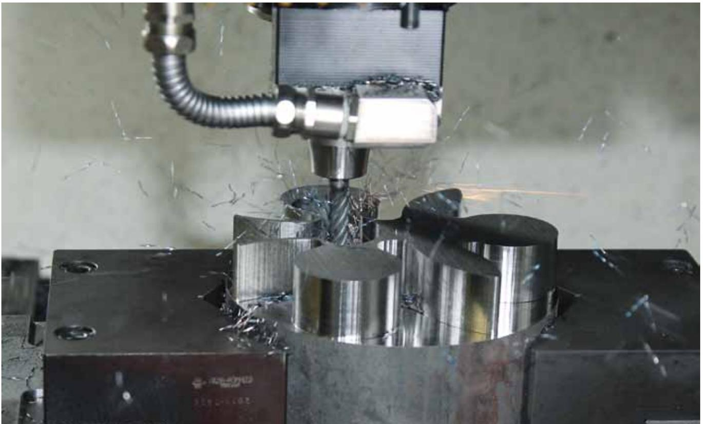
Der OptiMill-Trochoidfräser von Mapal im Einsatz: Da der Fräser die Nut oder Tasche nicht vollständig ausfüllt, ist ein Spänestau und erneutes Schneiden der Späne so gut wie ausgeschlossen. Durch das Umgehen des Vollschnitts sind selbst ohne speziell entwickelte Fräser Schnitttiefen von bis zu  $2 \times D$  erreichbar.
