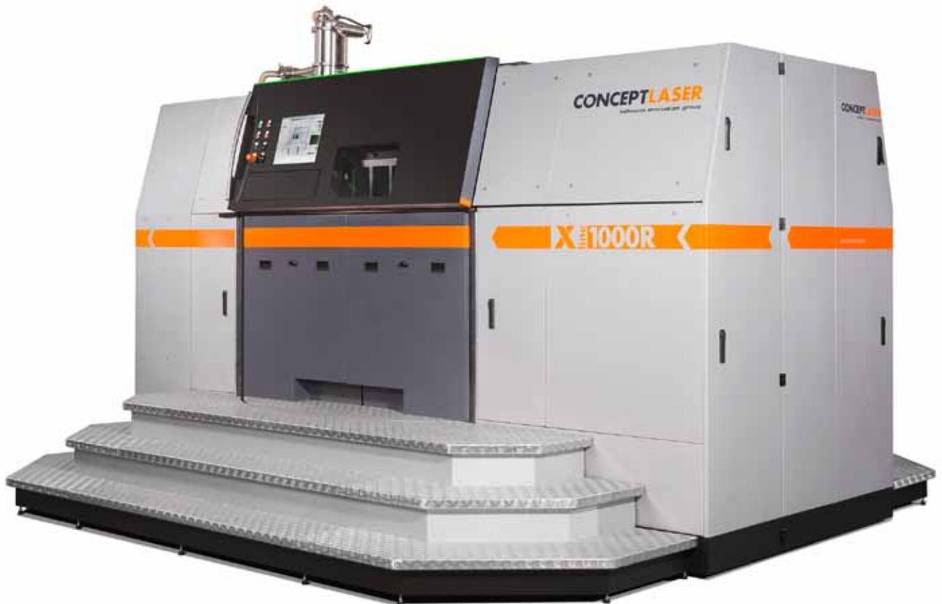
Beim Lasercusing-Verfahren wird feines pulverförmiges Metall durch einen hochenergetischen Faserlaser lokal aufgeschmolzen. Nach dem Erkalten verfestigt sich das Material. Die Großanlage »X line 1000R« dient zur Verarbeitung dieser reaktiven Materialien im geschlossenen System mit automatisiertem Pulvertransport und konsequenter Trennung von Bau- und Handling-Raum.
