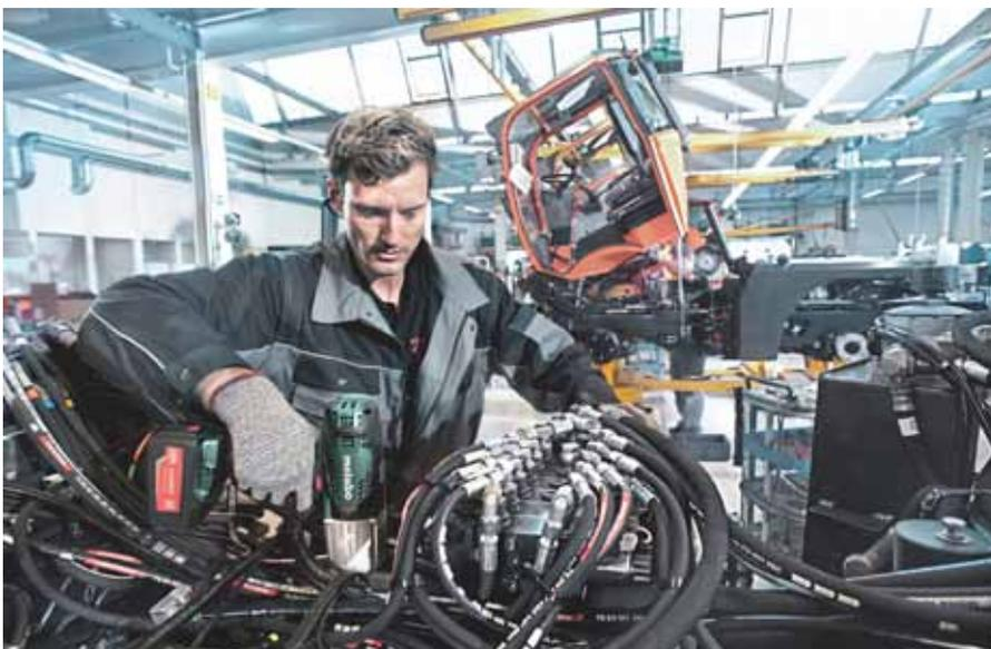
Der Akku-Schlagschrauber ›SSW 18 LTX 600‹ von Metabo überzeugt bei einem Gewicht von lediglich 3,1 Kilogramm mit einem Drehmoment von 600 Newtonmeter.
