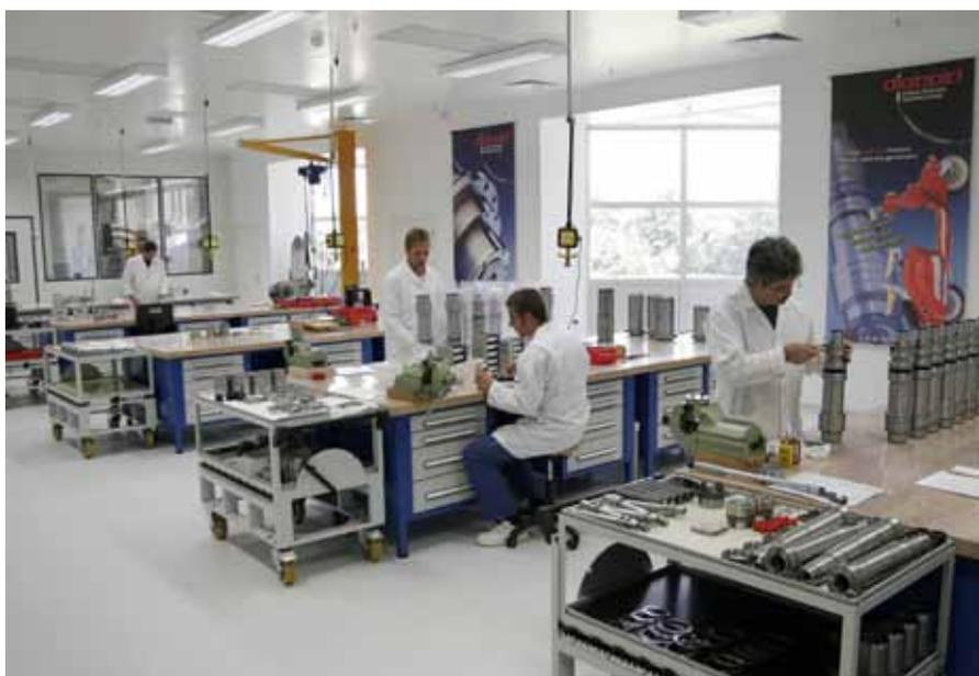
**Die Montage in einem klimatisierten Sauberraum garantiert, dass jede Spindel von Diebold die geforderten Toleranzen einhält. Bereits weit über 20 000 Einheiten hat das Unternehmen seit 1997 an zufriedene Maschinenbauer ausgeliefert.**
