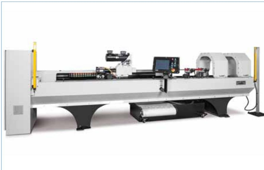
Kreuzschleifen ist eine Alternative zum Innenschleifen, Feindrehen, Reiben und Glattwalzen. Sunnen präsentiert dazu die neue Großbereich-Kreuzschleifmaschine ›HTE‹.
