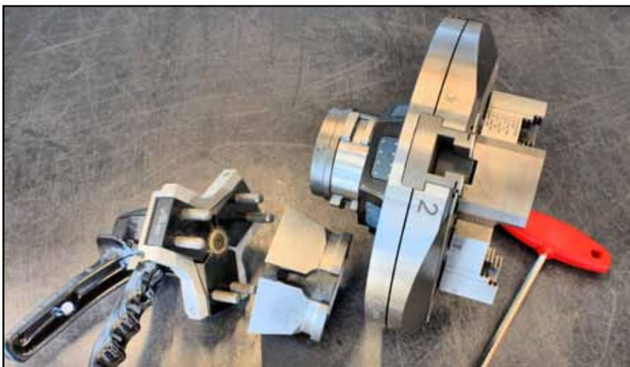
**Wechselvorrichtung, Spannkopf und ein Backenmodul mit Werkzeug: Für Außenspannungen mit Spannkopf von 3 bis 78 oder Backen von 25 bis 200 Millimeter.**
