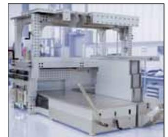
dell dargestellt werden, um die Einbausituation im PKW zu modellieren, damit die Teile später passgenau ausfallen. Alle Positionen, wie Armaturenbretthöhe, Sitzhöhe, Pedalerie in Weite und Tiefe oder Fußbodenhöhe sind individuell einstellbar und zusammen in eine ergonomische Arbeitsposition für den Designer zu bringen. Außerdem können Aufnahmen mit den Türverkleidungen zusätzlich angefügt werden.
