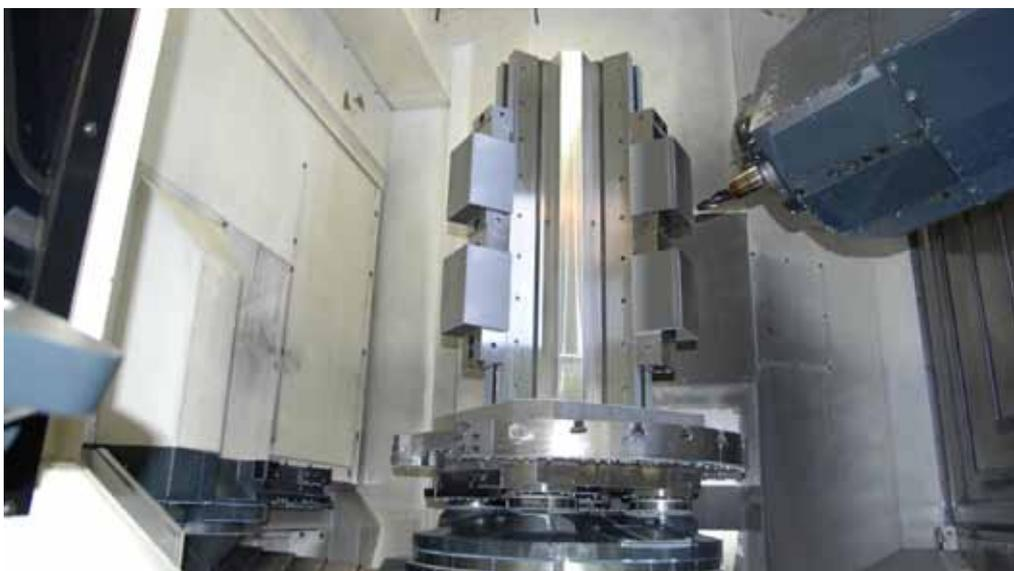
Kollisionsgefahr gebannt: Der Aufspannturm von Röhм, der aus besonders festem Aluminium gefertigt ist, bietet genügend Freiraum für den Bearbeitungskopf.
