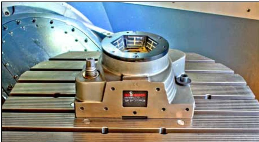
Ein »Manok plus«-Spannstock in der SE-Ausführung sorgt auch beim Fräsen für den sicheren Halt zu bearbeitender Teile.
