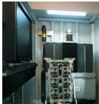
tative Informationen über Größe, Volumen und Dichte der Einschlüsse und Porositäten und unterstützt so die Optimierung der Produktionsprozessparameter zur Gewährleistung höherer Qualität und zur Verringerung der Ausschusskosten. Das GE-Gerät bietet intuitive und interaktive Bedienbarkeit, schnelle volumetrische Scans und CT-Rekonstruktionen für 3D-Analysen mit hoher Bildqualität.
