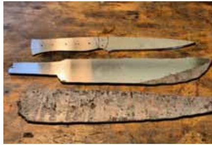
Nach dem Schmieden der Bleche wird der entstandene Block zerteilt und daraus je eine Messerform geschmiedet. Der Rohling wird anschließend geschliffen und mit Bohrungen für den Griff versehen.
