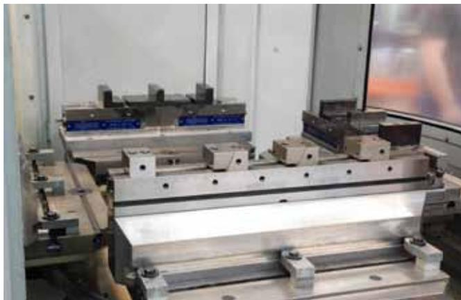
**Wechselpalette und Röhmspannleisten erhöhen die Produktivität und Flexibilität.**
