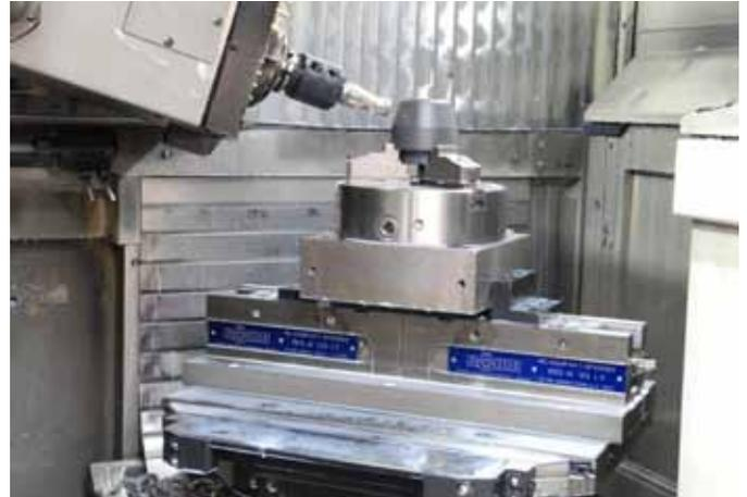
Großer Kopf bearbeitet kleines Teil: Eine Eigenlösung mithilfe von Röhм-Schraubstöcken sorgt für größtmögliche Freiheit.
