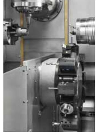
Der Werkzeugrevolver ist mit 18 oder 12 Stationen verfügbar und besitzt eine Y-Achse.
