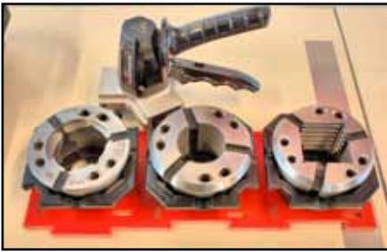
Verschiedene runde Spannköpfe im Lagersystem »Hainbox«. Links ein außer-mittiges Sonderprofil.
