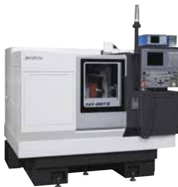
können Werkstücke mit einer Länge von 650 mm und einem Durchmesser von 300 mm hocheffizient bearbeitet werden. Bei der Bearbeitung wird eine Schleifscheibe mit einem maximalen Durchmesser von 610 mm und einer maximalen Breite von 150 mm von einer kraftvollen 15 kW-Schleifspindel angetrieben. Durch die 2 kW-Hauptspindel wird das beidseitig
