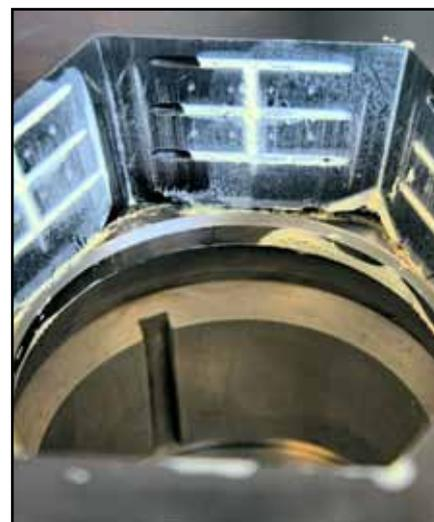
**Beim ›Toplus‹-Spannsystem sorgen ebene, schmierbare Flächen für eine sichere Anlage des Spannkopfes.**
