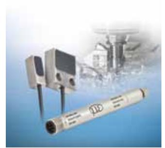
und um möglichst hohe Genauigkeiten zu erreichen, wird der Sensor werkseitig auf ferromagnetische oder nicht-ferromagnetische Werkstoffe des Kunden kalibriert. Zur Temperaturkompensation wird über den Widerstand der Wirbelstromspule die Temperatur des Sensors erfasst. Dieses Signal wird auch dem Kunden zur Verfügung gestellt, der eventuell auf eine zusätzliche Temperatur-Sensorik verzichten kann.
