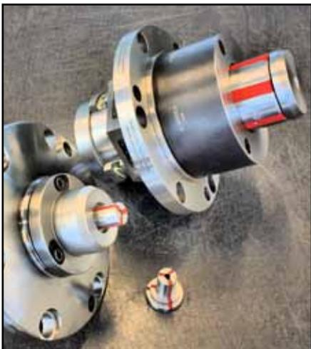
Spanndorne der Baureihe »Mando Adapt« für Spanndurchmesser 8 bis 120 mm.
