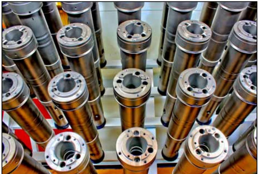
Dank der hohen Fertigungstiefe ist Diebold in der Lage, die versprochene Präzision seiner Produkte problemlos einzuhalten. Eine ausgetüftelte Produktion stellt sicher, dass jedes Teil einer Spindel höchsten Ansprüchen genügt. Dokumentiert wird dies mit teils selbst entwickelten Messgeräten, die auf 0,0001 Millimeter genau messen.
