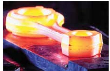
Schmiedetrennmittel werden beim Gesenkschmieden eingesetzt, um optimale Werkzeugfüllung, kontrollierten Metallfluss sowie einfache Trennung des Produktes aus der Form sicherzustellen.
