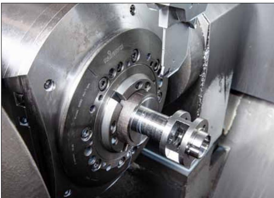
Höhere Vorschübe bei gleicher Stechbreite erlaubt das Horn-Stechsystem zum Einstechen über die Y-Achse.
