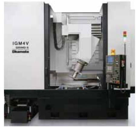
**Die IGM4VSP ermöglicht die Bearbeitung von Innen- und Außendurchmessern sowie Stirnflächen.**
