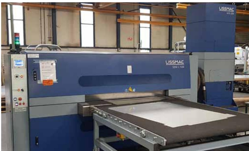
Die Lissmac-Entgratmaschinen sind perfekt für die Anforderungen von Blokland geeignet. Mit den Entgratblöcken von boeck konnte die Qualität der Kantenverrundung verbessert, die Rüstzeiten minimiert und die Werkzeugkosten reduziert werden.
