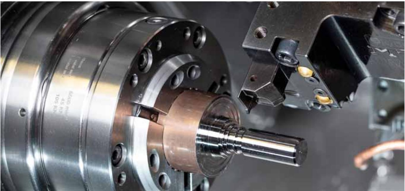
Die fünf Millimeter breiten Einstiche für das Stehlager übernimmt eine Schneidplatte des Horn-Systems ›223‹. Die Standzeit pro Schneide liegt hier bei über 300 Werkstücken.
