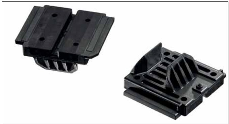
**Gespritzter Hartferritmagnet, der hohen Temperaturen im Getriebe standhält. Das Zwei-Komponenten-Spritzgussverfahren sorgt für eine formschlüssige Verbindung zwischen Träger und Magnet.**
