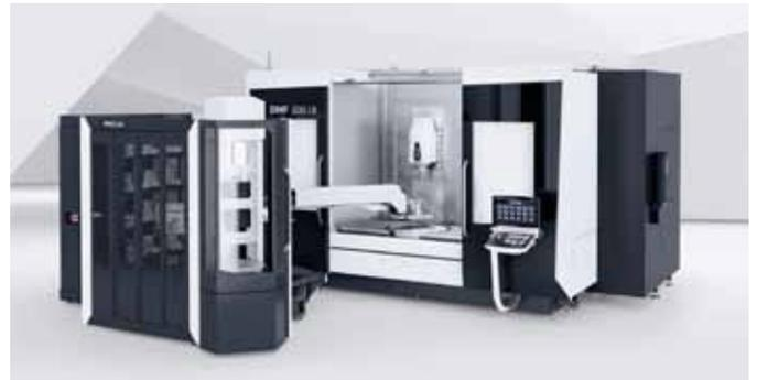
Die DMF 200|8 ist mit einer Schnittstelle für die automatisierte Fertigung, etwa für das PH Cell Paletten-Handling ausgestattet.
