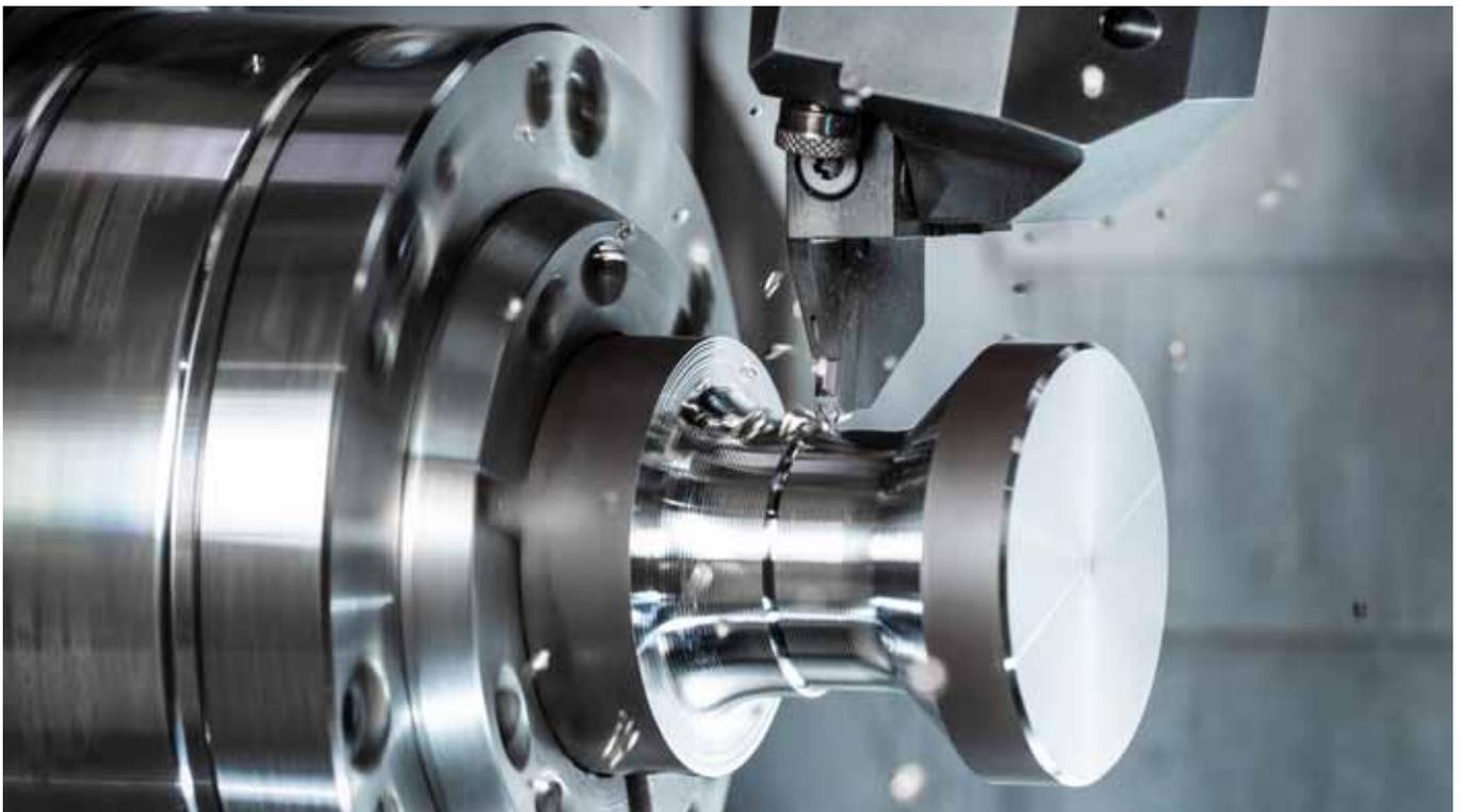
Das trochoidale Drehen eignet sich sehr gut für das Drehen von tiefen und breiten Einstichen, bei denen ein hohes Spanvolumen generiert werden muss.
