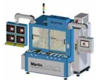
dern in ein Abfall-Magazin. Sämtliche Prozessdaten werden überwacht und archiviert, da es sich um die Fertigung von Operationsinstrumenten handelt. Sensoren geben im 20-Sekunden-Intervall Auskunft über die Produktionsmenge, die ausgeschleusten SPC-Teile sowie die für nicht in Ordnung befundenen Teile. Gesteuert wird die Anlage über eine SF1509oF von Siemens. Das dazugehörige Bediendisplay ist am Gelenkarm angebracht.
