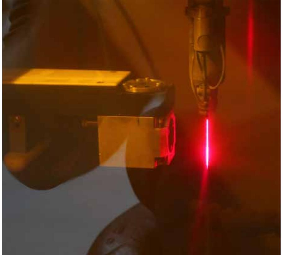
Die Qualität der Düsenöffnung wird indirekt durch Analyse der Raman-Strahlung erfasst. Links der Sensor, rechts der rot erscheinende LMJ-Strahl.
