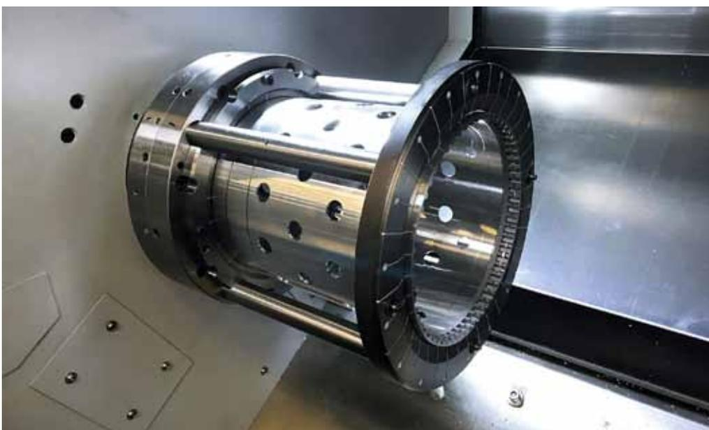
Fur die Auen- und Innenzerspannung, das Auswuchten sowie die Rissprufung sensibler Aluminium-Getriebetopfe hat Ringspann ein spanntechnisches Trio erdacht. Das Bild zeigt das Spannzeug »OP20« zum Innendrehen des eingespannten Werkstucks.
