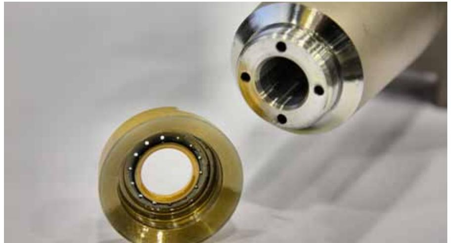
Über innenliegende Bohrungen strömt das Kühl- beziehungsweise Schmiermedium in die Ringnut der Düsenkappe, von wo es über kleine Düsenbohrungen direkt auf die Schneide des Fräsers gelenkt wird.
