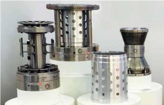
Bei den Spannzeugen zur Bearbeitung der Aluguss-Getriebetöpfe (vorne rechts) handelt es sich um einen pneumatisch-mechanischen Zweifach-Membranspanndorn (links), eine pneumatisch-mechanische Flachfutter-Spannfutter-Kombination (hinten links) sowie einen mechanischen Zweifach-Kegelspanndorn für das Auswuchten und die Rissprüfung (hinten rechts).
