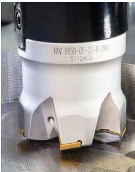
Der Tang4Feed-Hochvorschub-Aufsteckfräser kann mit verschiedenen Schneidengeometrien bestückt werden.
