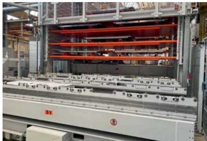
Über Verschiebeeinheiten und Rollenbahnen lässt sich der Unitower cnc vollautomatisch mit mehreren Rüst- und Maschinenübergabeplätzen verbinden.
