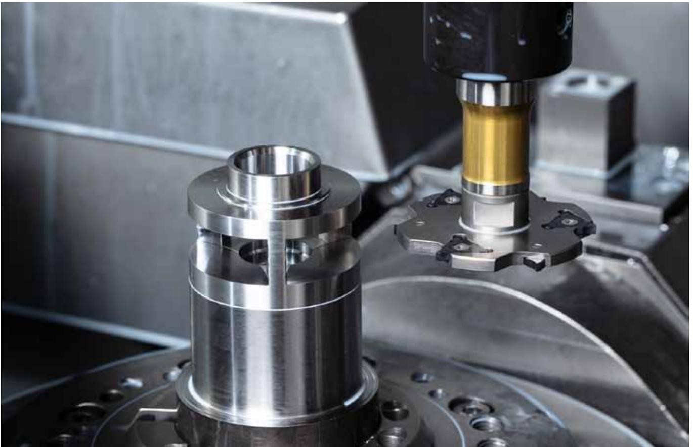
Zur Aufnahme von drei Zahnrädern des Planetengetriebes für die Cleco-Maschinen müssen in das Bauteil drei Nuten gefräst werden. Dazu wird auf das Horn-Frässystem »M310« mit einem Schneidkreis von 63 mm und sechs Schneiden gesetzt.
