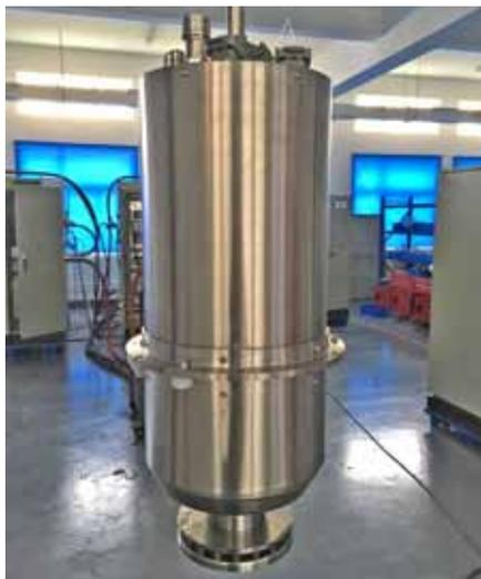
**Weiss passt seine in Zerstäubereinheiten verwendeten Motorspindeln individuell den Bedürfnissen der Kraftwerks-Anlagenbetreiber an.**
