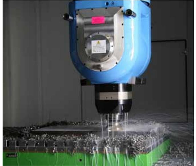
SSB-Maschinenbau entwickelt maßgeschneiderte Maschinenkonfigurationen zur Großteilzerspanung mit speziellen Spindel-, Werkzeug- und Spannkonzepten, wie etwa mit einem Cyttec-Gabelfräskopf.
