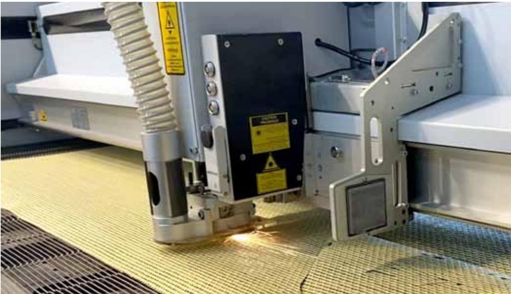
Laserschneiden von DeliComp-Gewebe mit Aramidfaser.
