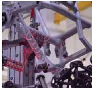
tion sein. Durch die geforderte Hochtemperaturverzinkung müssen viele dieser Merkmale prozessbedingt manuell nachgearbeitet werden. Dadurch ergibt sich die Anforderung einer qualitativen Absicherung des Fertigteils durch 100 Prozent Vermessung der Serienproduktion innerhalb vorgegebener Taktzeit. Für jeden Rahmen muss ein Messprotokoll und 3D-Scan zur Nachverfolgbarkeit gespeichert werden.
