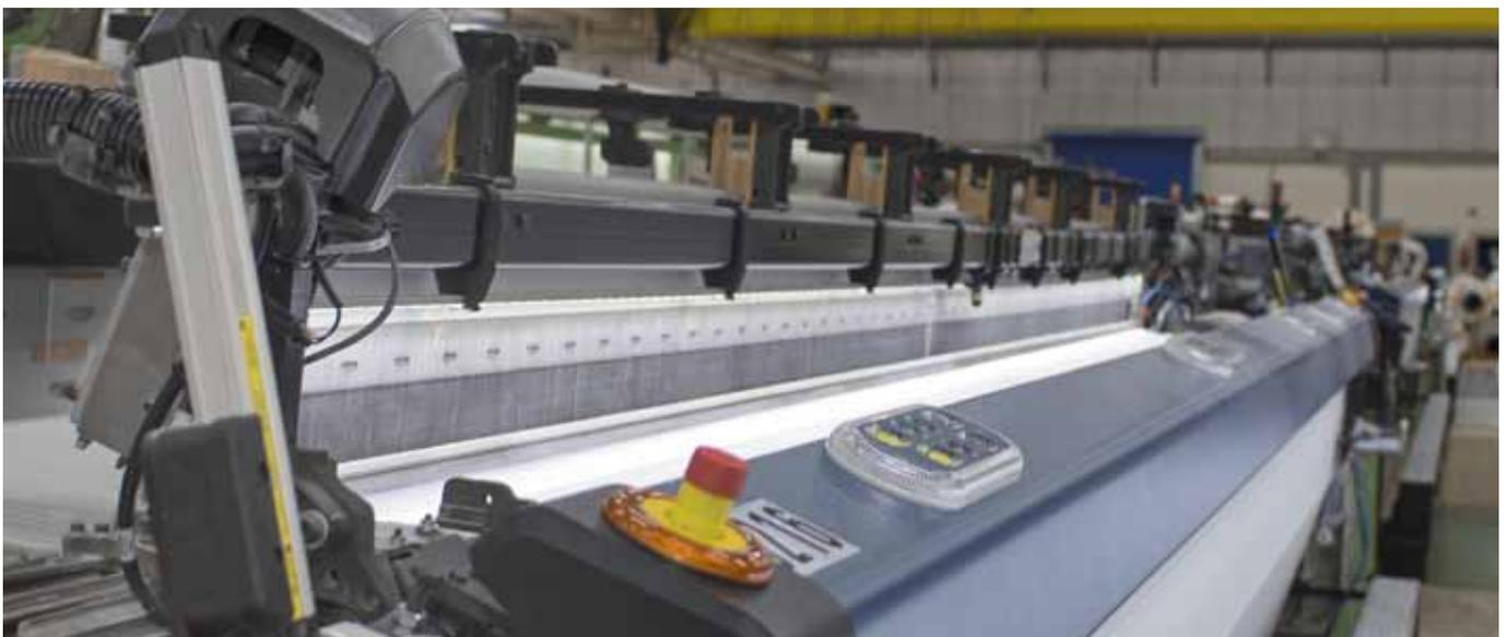
Produktion von Prepregs bei Delcotex: Im Vergleich zu herkömmlichen Werkstoffen lässt sich durch thermoplastische Prepregs sehr viel Gewicht und auch Kosten sparen und dabei die Stabilität von Bauteilen optimieren.
