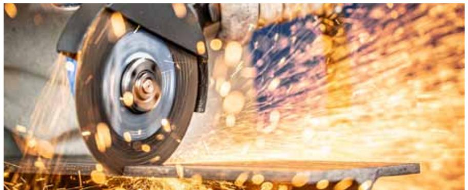
kann. Im Vergleich zur bisher bekannten 80 m/s-Technologie bedeuten 100 m/s eine Steigerung von 25 Prozent in der Schnittgeschwindigkeit. Diese weit höhere Schnittgeschwindigkeit wirkt sich selbstverständlich unmittelbar auf die Trennleistung aus. Die Zeit pro Schnitt bis zum Durcharbeiten des Werkstücks sinkt deutlich. Im Vergleich zu marktüblichen Trennscheiben der Abmessung 125
