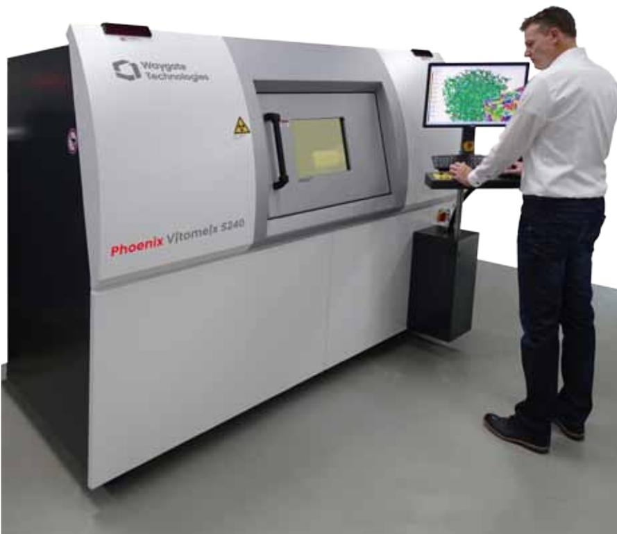
Der CT-Scanner V|tome|x S240 deckt ein breites Spektrum von CT-Anwendungen ab. Dazu zählen Fehleranalysen, Materialstrukturanalysen und Montagekontrollen.
