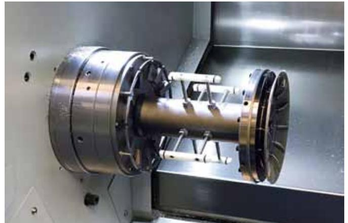
Das Innenspann-Spannzeug »OP10« ist Teil des dreiteiligen Spannzeug-Sets von Ringspann fur das auere Abdrehen, das Auswuchten und die Rissprufung dunnwandiger Druckguss-Komponenten. Die im Bild zu sehenden weien Schwingungsdampfer verhindern, dass das zylindrische Werkstuck wahrend der Bearbeitung in Vibration gerat.
