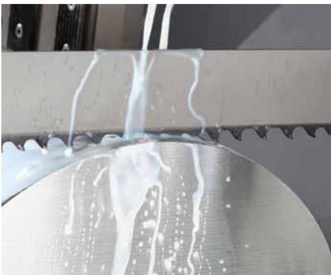
Eine spezielle Hartstoffbeschichtung der Sägebänder ermöglicht die Bearbeitung von VA-Stählen.
