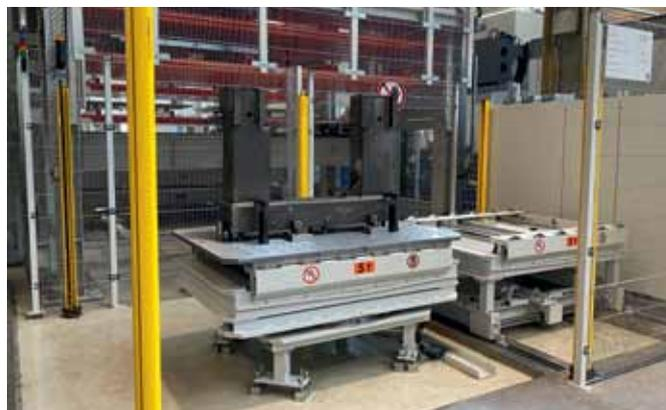
Der Unitower cnc versorgt CNC-Bearbeitungszentren und Fräsmaschinen kontinuierlich mit fertig gerüsteten Paletten, welche die Mitarbeiter parallel an separaten Arbeitsplätzen vorbereiten können.
