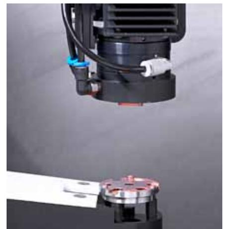
Innovatives Kamerasystem für die Bestimmung von Position und Lage des Werkstücks.
