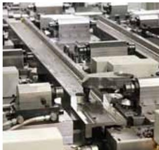
In der vollautomatischen Anlage zum Zerspanen von Profilen mit Abmessungen von bis zu acht Meter Länge und bis zu 350 Kilogramm Gewicht werden zwei Profile nach dem Einschleusen gleichzeitig bearbeitet.
