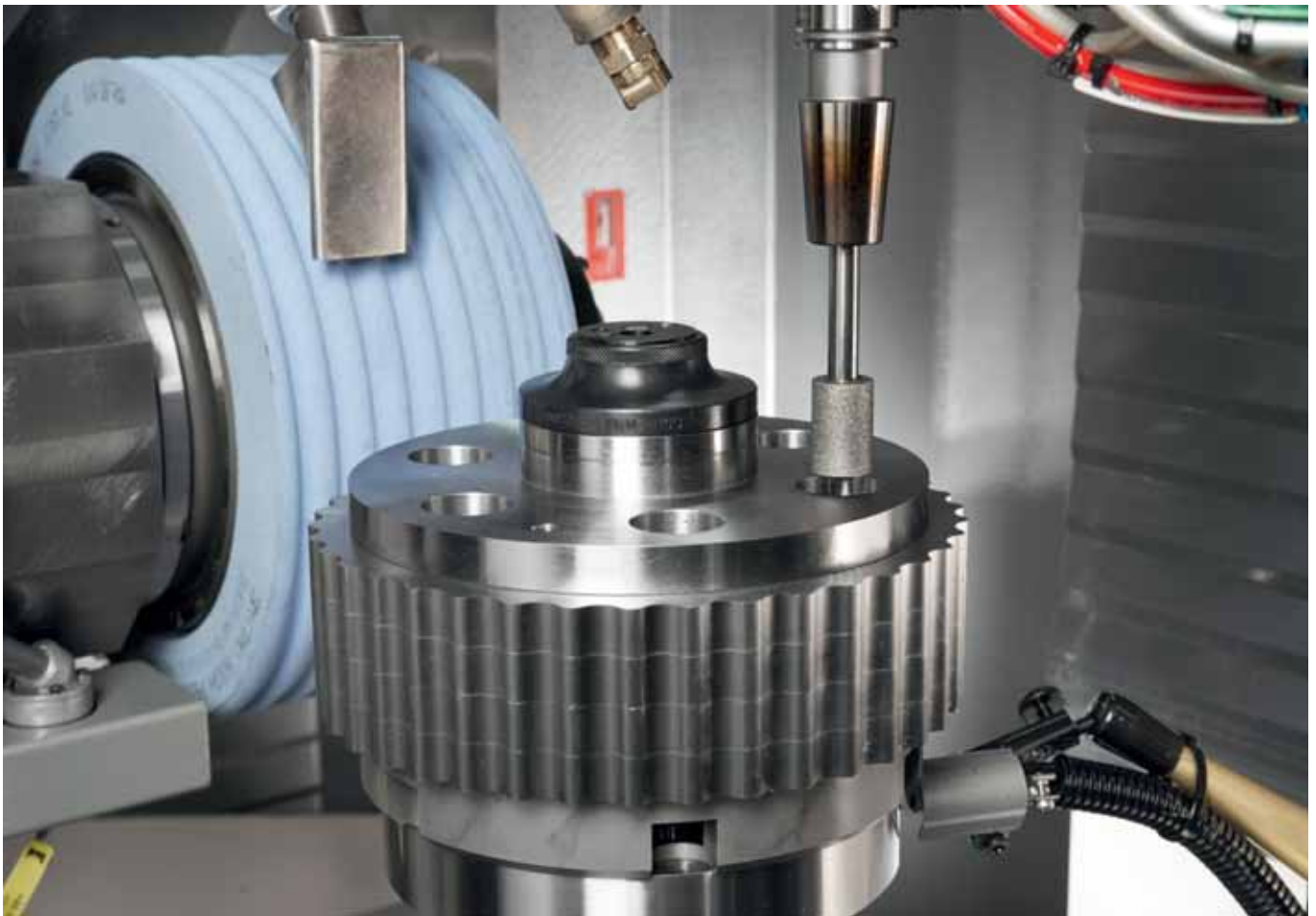
Die Integration des Bohrungsschleifens in dieselbe Maschine bringt entscheidende Produktivitätsvorteile: Zum einen entfällt das zeitaufwendige Umspannen auf eine andere Maschine, zum anderen erhöht sich die Effizienz der Verzahnungsfertigung.
