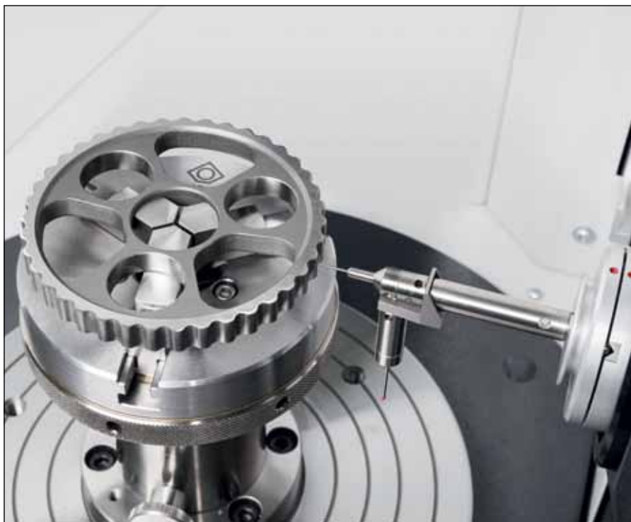
Die Messtechnik von Klingelberg ist auf die schnelle Messung von rotationssymmetrischen Bauteilen optimiert.
