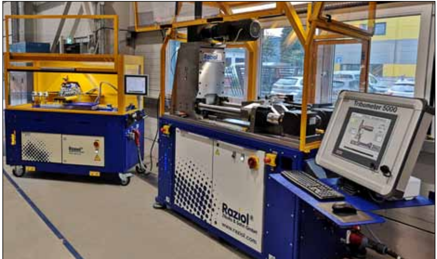
Ein Tribometer (re.) und eine Laborbeölungsanlage von Raziol sind seit Juli 2019 im Werkzeugmaschinenlabor WZL der RWTH Aachen in Betrieb.
