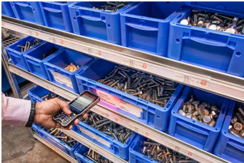
Beim neuen Kanban-Konzept von Otto Roth scannt der Benutzer das ablösbare Etikett auf dem Behälter mit der Otto Roth-Kanban-App und übermittelt dadurch sofort eine Bestellung.
