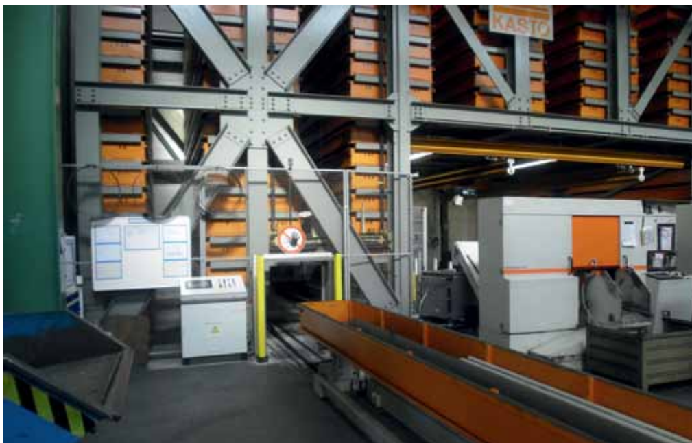
Das Überfahrlager von Hawle vom Typ ›Unitop‹ wurde nach 20 Jahren von Kasto komplett überholt und somit auf den neuesten Technikstand gebracht.
