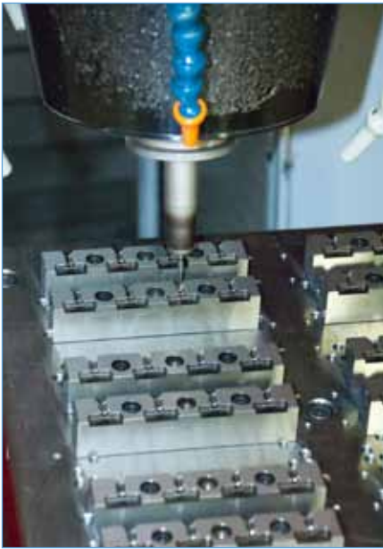
Fischer Werkzeug- und Formenbau setzt stark auf Automatisierung. Um einen störungsfreien Mannlosbetrieb sicherzustellen, wurden gemeinsam mit MMC Hitachi Tool die Fräsprozesse optimiert.
