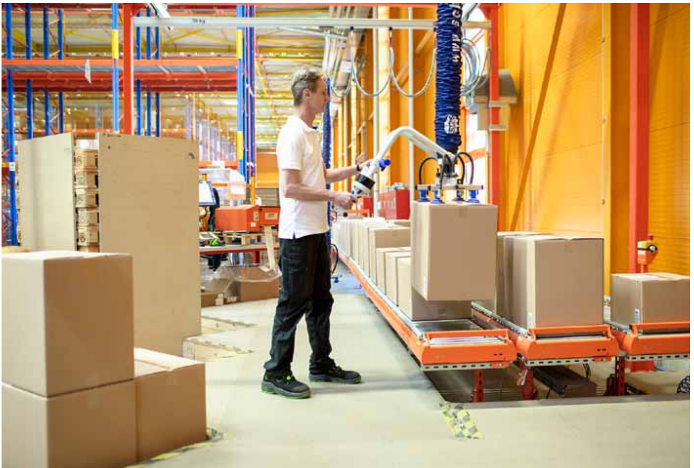
Der zunehmende Durchsatz im Textil-Verteilzentrum von dm erforderte ein neues Hallenlayout. Schmalz entwickelte dafür ein Gesamtkonzept, das den logistischen und ergonomischen Anforderungen gerecht wird. Herzstück ist der JumboFlex High-Stack.
