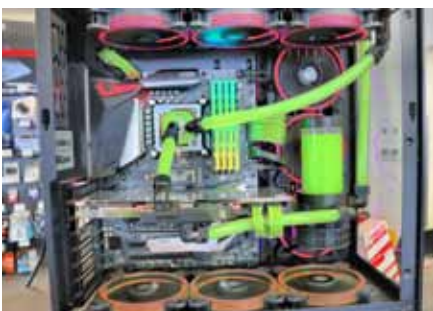
Wassergekühlte PCs arbeiten nahezu unhörbar, was diese für Business-Anwendungen qualifiziert. Dazu empfiehlt sich eine SSD als Massenspeicher.
