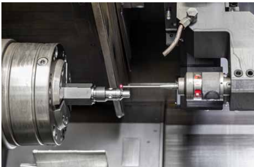
Der Messtaster »TC54-10 T« von Blum ist eine spezielle Variante für die rauen Bedingungen in Drehmaschinen.
