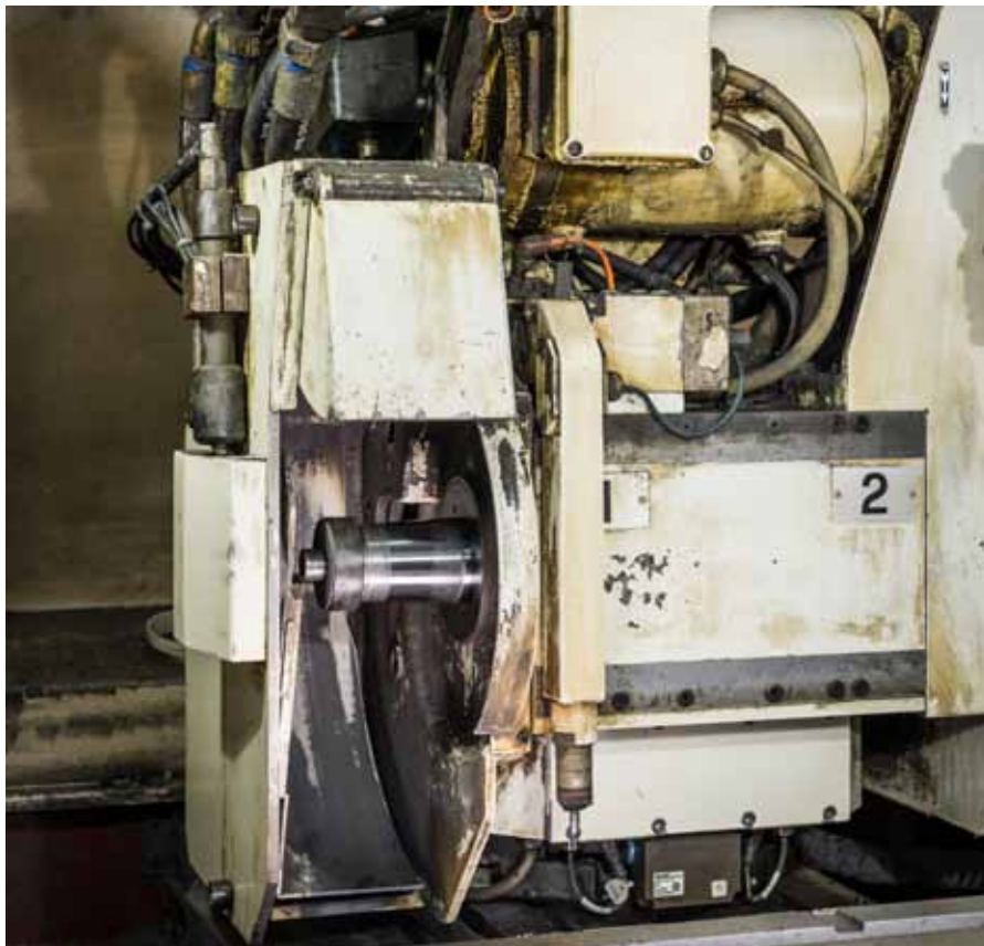
Der Schleifspindelstock wird beim Retrofit komplett überholt. Während der Überholung stellt Studer dem Kunden eine Leihmaschine zur Verfügung.
