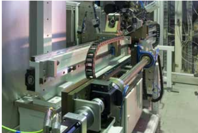
Schwenkachse zum Abholen der Rohlinge vom Trommelmagazin, angetrieben vom Kollmorgen AKM-Servomotor.
