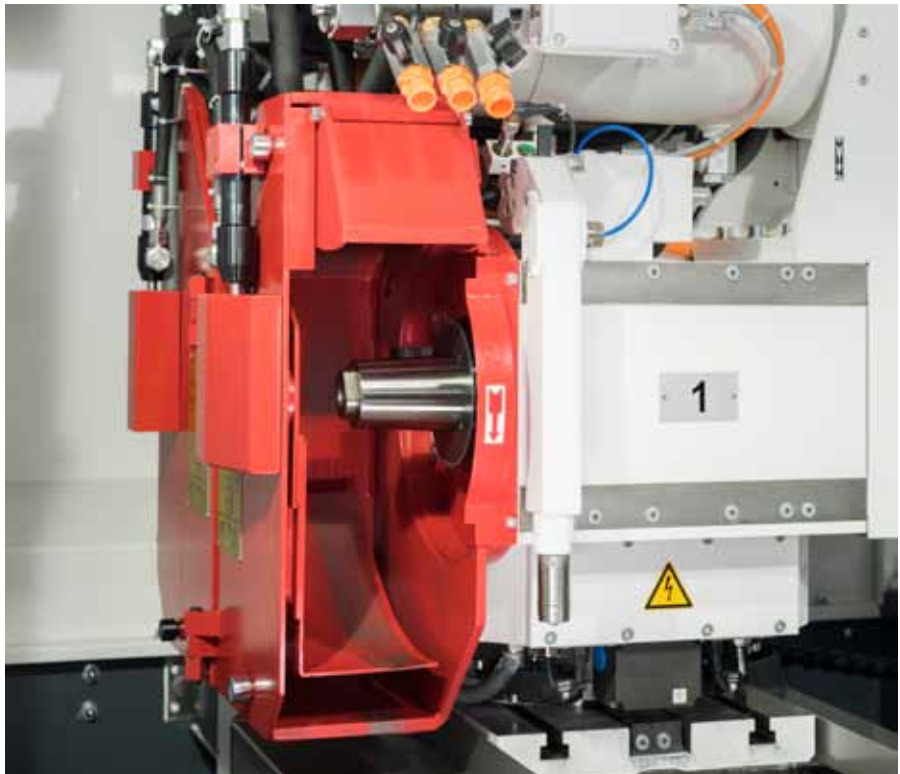
Nach dem Retrofit präsentiert sich nicht nur der Schleifstock einer Studer-Maschine im neuen Gewand.
