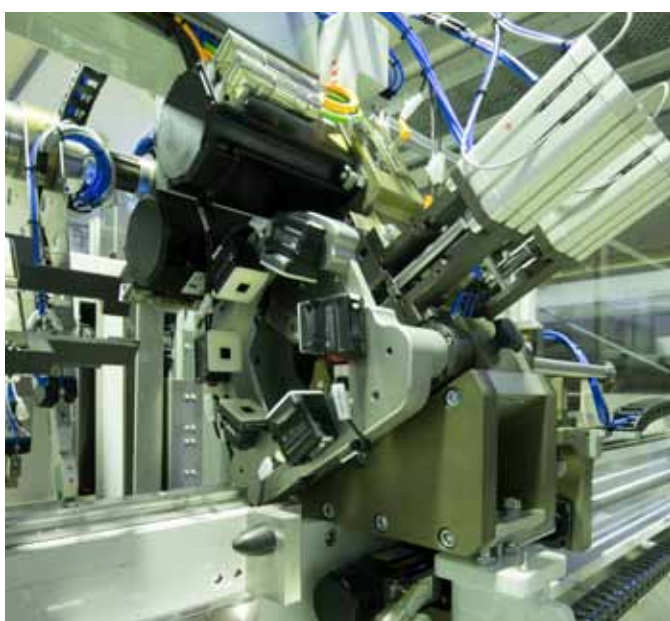
Ein Zusammenspiel von hoher Präzision und kurvengesteuerte Synchronisation beider Achsen müssen die Kollmorgen AKM Servomotoren gewähren.
