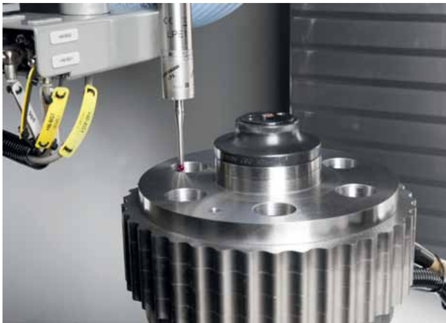
Die komplette Kontrolle des Schleifprozesses erfolgt durch das neue Adaptive Grinding-System.
