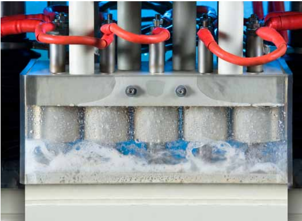
Bei der Produktion der E-Bike-Welle kommt ein Werkzeugsystem zum Einsatz, mit denen fünf E-Bike-Wellen parallel fertiggestellt werden.
