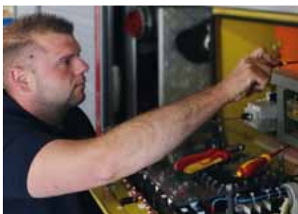
Sämtliche VDE-Werkzeuge von Stahlwille sind durchschlagsicher bis 1000 Volt.
