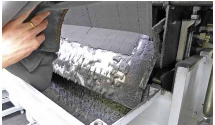
Der Filterkuchen ist so optimal geschichtet, dass er mit Luftdüsen abgereinigt werden kann. Die HSS-Späne werden anschließend zu Briquets gepresst.
