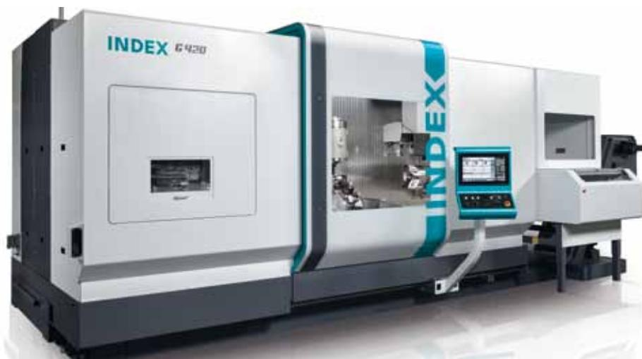
In die G420 von Index kann optional eine Zweiachs-Handhabungseinheit für das Be- und Entladen sowie Reststückentnahme bis zu einem Teilegewicht von 20 kg integriert werden.
