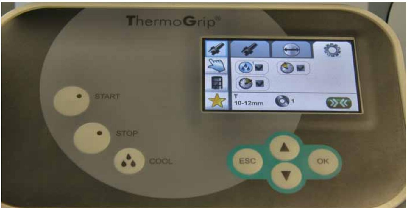
Die moderne Steuerung der Schrumpfgeräte von Bilz kann natürlich auch manuell programmiert werden. Es lassen sich die Daten mithilfe übersichtlicher Menüs eingeben.
