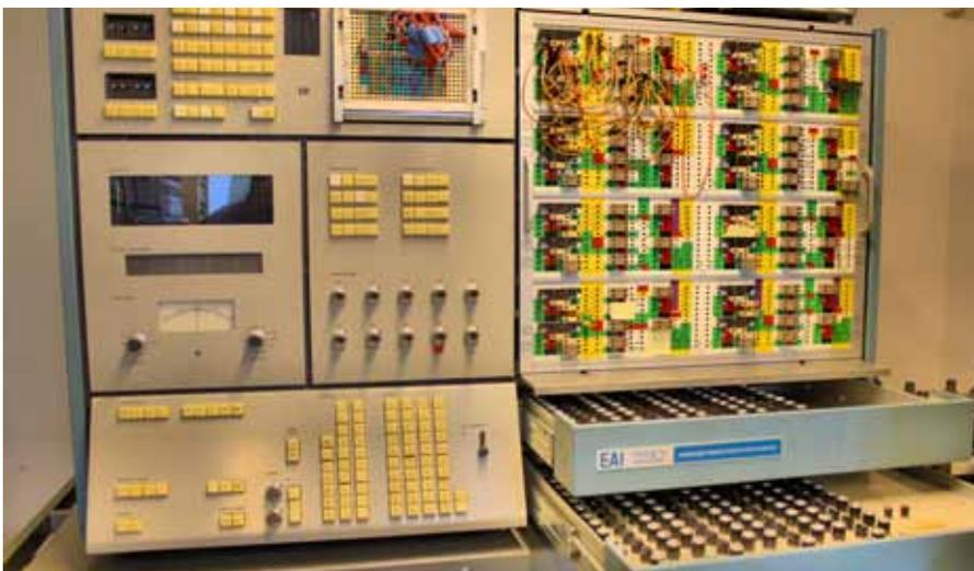
**Analogrechner werden per Steckbrett „programmiert“, und Variablen über Präzisionspotenziometer parametrisiert. Das Ergebnis wurde in nahezu Echtzeit ausgegeben.**
