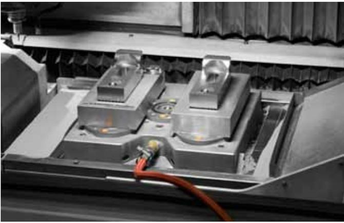
**Mit dem Nullpunktspannsystem Zero-Point von AMF lassen sich Rüstzeiten um bis zu 90 Prozent reduzieren.**
