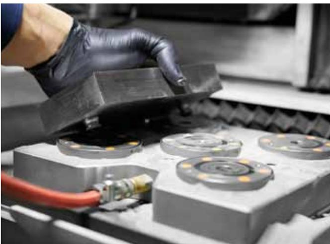
Das Zero-Point-System von AMF bietet bei Matsuura für viele Anwendungen eine optimale Ergänzung, die zur Wirtschaftlichkeit des kompletten Prozesses beiträgt.
