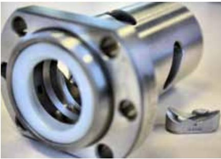
Beim Umlenkstücksystem verläuft ein Kugelumlauf über den ganzen Gewindegang. Bis zu sechs Umläufe kann eine Mutter enthalten.
