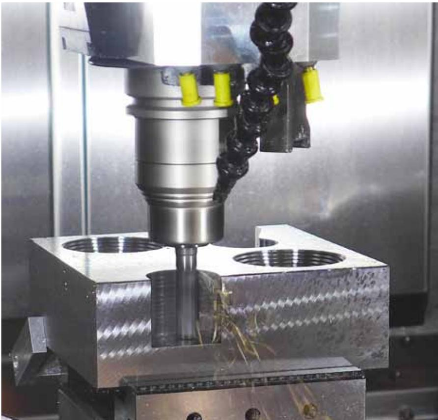
Bei der Aerosol-Trockenschmierung ›ATS‹ von Rother steht die Temperaturvermeidung statt deren Reduzierung im Mittelpunkt.
