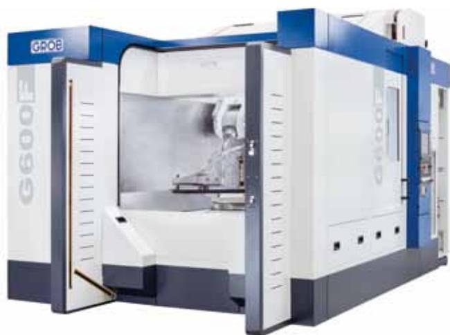
Die »G600F« von Grob eignet sich beispielsweise für die Bearbeitung von Fahrwerksteilen, aber auch Batteriegehäusen.
