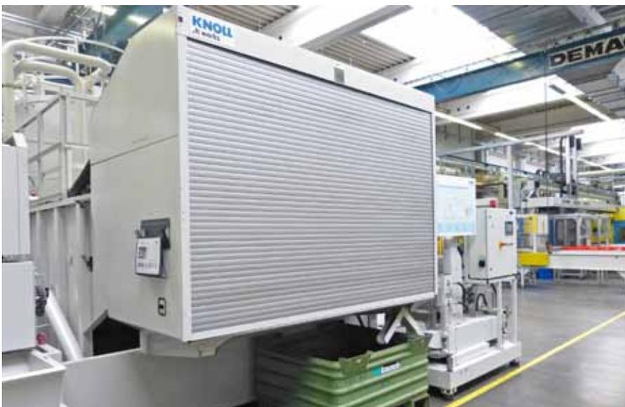
Für die Schleifmaschinen zur Bearbeitung der HSS-Schraubenspindeln ist in der KNOLL-Produktion ein Großfilter VLX 5000 installiert.
