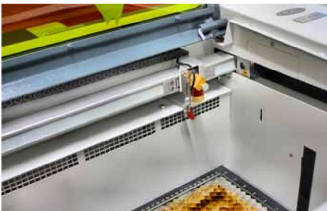
Über Umlenkspiegel wird der seitlich in den Arbeitsraum eintretende Laserstrahl auf das Werkstück geleitet.
