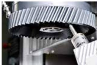
Flexibilität der Maschine. Sie ist auf einem Arm montiert, der motorisiert für die Messung eingeschwenkt wird. Da er nach der Messung automatisch wieder zur Seite fährt, wird zudem auch der direkte Einfluss durch Kühlmittel und Späne minimiert. Die ermittelten Nachschliffparameter werden sofort nach der Messung auf der Bedienoberfläche der LHGearTec-Steuerung angezeigt. Dabei wird das Werkzeug mitsamt des Halters und allen beteiligten Schneiden als 3D-Modell zur Kontrolle visualisiert.
