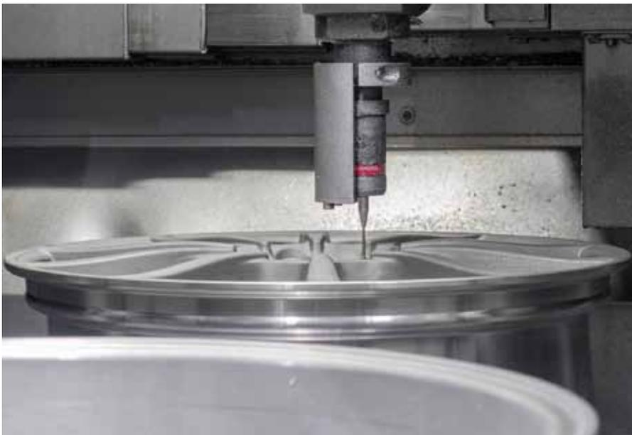
Die optimale Lösung für BBS: Der kompakte Messtaster »TC62 T« und ein Schwingungsdämpfer zwischen Revolver und Messtaster.
