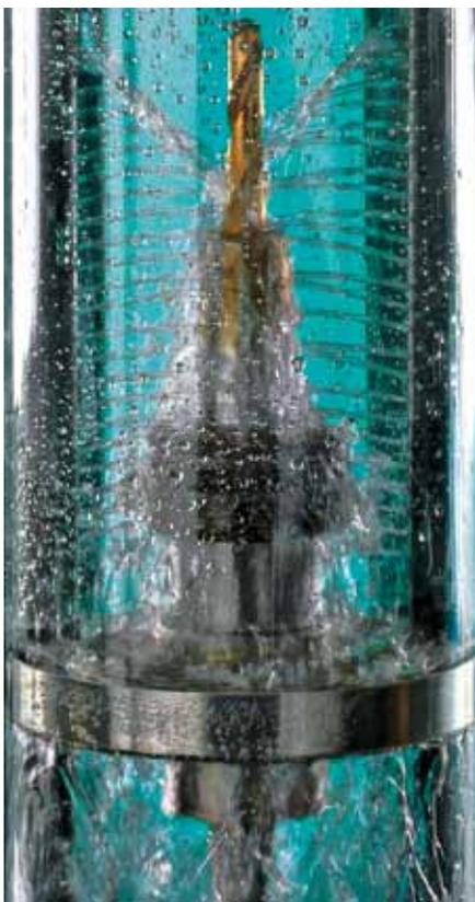
Bilz-Schrumpfgeräte der Professional-Serie verfügen über eine automatisierte Flüssigkeitskühlung. Damit wird das erhitzte Schrumpffutter innerhalb von 30 Sekunden abgekühlt.
