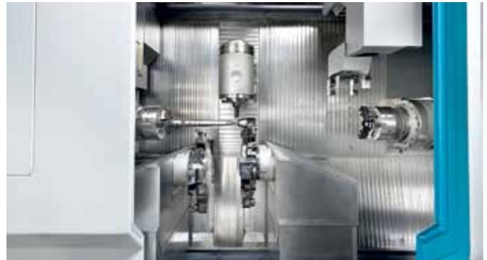
Dank des großen Arbeitsraumes und dem Abstand zwischen der Haupt- und Gegenspindel kann kollisionsunkritisch mit der Motorfrässpindel und den Werkzeugrevolvern zeitgleich an der Haupt- und Gegenspindel bearbeitet werden.
