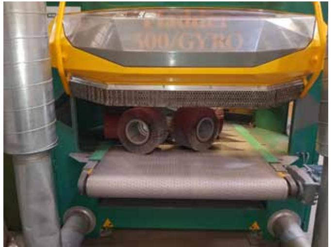
Auf der Fladder-Entgratmaschine verwendet KWM Weisshaar Entgratwalzen von Boeck und spart damit 50 Prozent Bearbeitungszeit ein.
