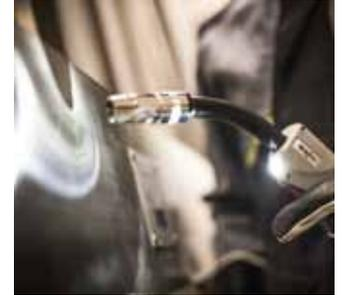
Der PM-Standard-Brenner mit integrierter LED-Beleuchtung erleichtert Schweißarbeiten.
