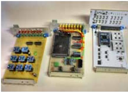
Aus zwei Prototypenmodulen (links) entstand für das ›Modell 1‹ ein in SMD-Technik aufgebautes Modul (rechts).
