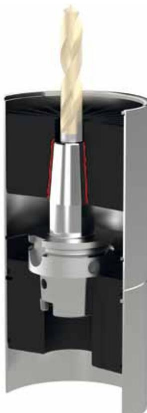
Bei der Kontaktkühlung wird das Schrumpffutter mit einem Kühlkörper in Kontakt gebracht, der von Luft durchströmt wird. Bei diesem Prinzip dauert der Abkühlvorgang deutlich länger.
