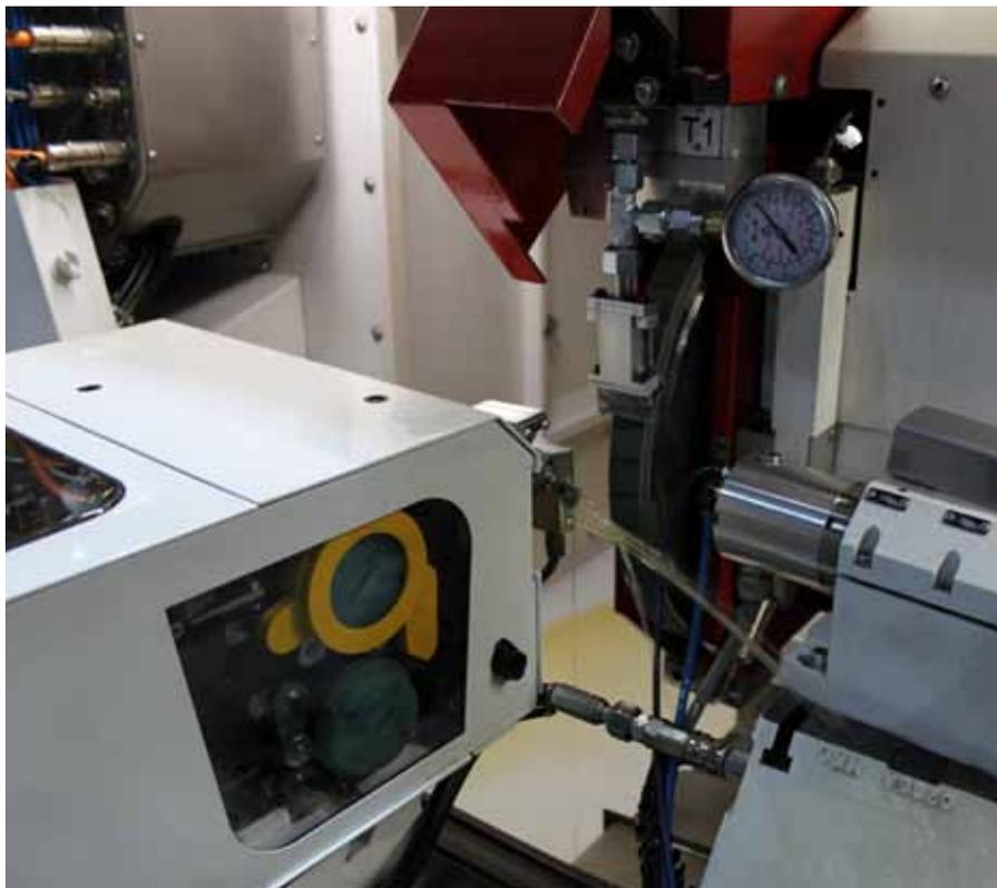
Bei der WireDress-Abrichttechnologie von Studer erfolgt das Abrichten bei voller Schleifdrehzahl der Scheibe durch modifiziertes Draht-Erodieren in der Schleifmaschine, wobei das Schleiföl als Dielektrikum dient.
