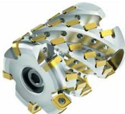
Sowohl beim Nutenfräsen als auch beim Profilfräsen lassen sich mit dem ›Harvi Ultra 8X‹ immer bis zu 328 cm<sup>3</sup> Titan pro Minute zerspanen. Dabei beträgt die Standzeit mindestens eine Stunde.
