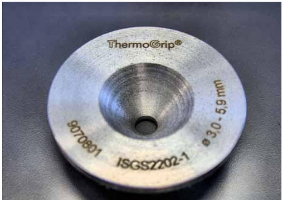
Eine auf der Induktionsspule aufliegende Ferritscheibe sorgt dafür, dass das Magnetfeld den Fräterschaft nicht miterhitzt.
