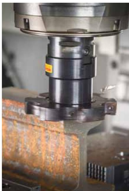
Der Nutenfräser »Coromill 331« bietet eine innere Kühlmittelzufuhr.
