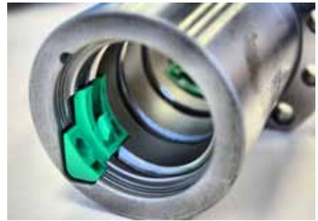
Beim Endkappenumlenksystem werden die Kugeln beim Austritt aus der tragenden Zone von der Endkappe in die tragende Zone zurückgeleitet.
