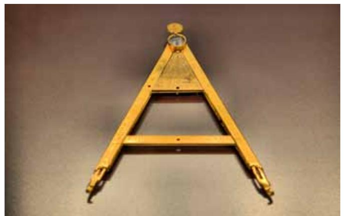
1566 entwickelte Christoph Schissler aus einem einfachen Zirkel ein Kombiinstrument, das als Sonnenuhr, als Maßstab und als Nivellierinstrument verwendet werden konnte.
