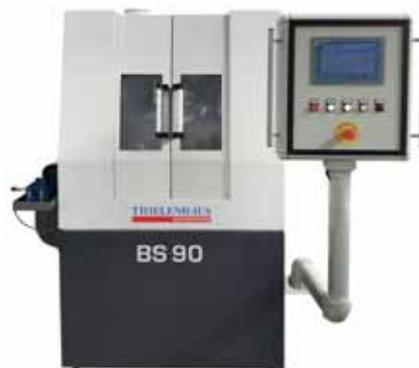
ladung der Lagerringe dank einer entsprechenden Wechsel-Konstruktion innerhalb von nur einer Sekunde erfolgt, sind extrem kurze Taktzeiten von rund vier bis acht Sekunden möglich. Nach Versuchen des Herstellers können beispielsweise bei einer Doppeltakt-Beladung Taktzeiten von 4,3 Sekunden pro Gutteil erzielt wer-
