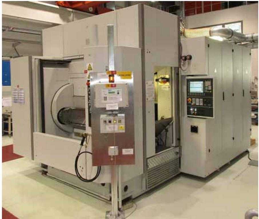
Im Spannungslabor der Westsächsischen Hochschule Zwickau steht eine mit CO<sub>2</sub>-Sicherheitstechnik ausgestattete Prototypanlage. Ziel ist es, das unkontrollierte Ausströmen von CO<sub>2</sub> zu detektieren, das prozessbedingte Vorhandensein zu überwachen sowie bei Überschreitung der gesetzlich vorgeschriebenen Arbeitsplatzgrenzwerte die Mitarbeiter zu schützen.
