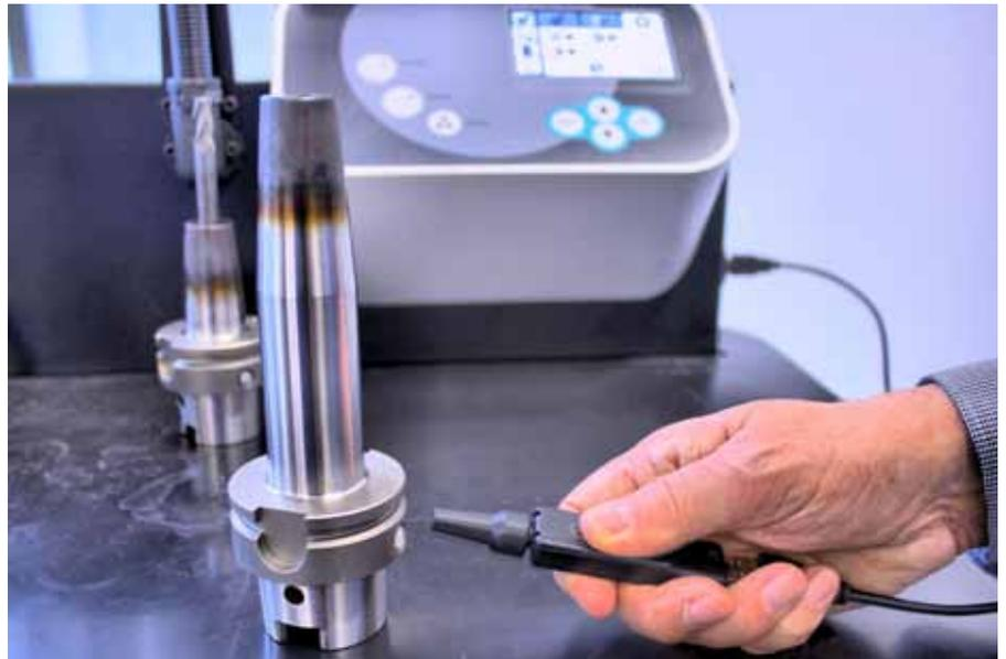
Mit seiner RFID-Technik bietet Bilz eine Lösung an, die Steuerung seiner Schrumpfgeräte rasch und sicher mit den passenden Schrumpfparametern zu versorgen.
