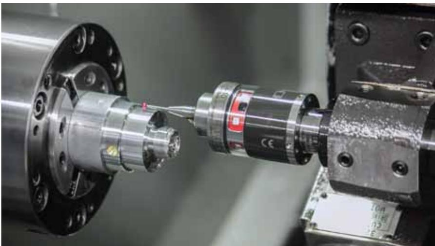
Der robuste Messtaster »TC54-10 T« von Blum mit planverzahntem Shark360-Messwerk hält Fließspänen, Schlägen und Vibrationen stand. Auch zähes Öl verdrängt der Messtaster dank seiner erhöhten Messkraft zuverlässig.
