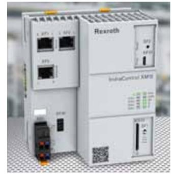
nen der Steuerung zugreifen. Darüber hinaus tauscht die Gigabit-Ethernet-Schnittstelle große Datenmengen in hoher Geschwindigkeit mit übergeordneten Systemen aus. Die Steuerungshardware ist durch den Verzicht auf Verschleißteile wie etwa Lüfter und Batterien wartungsfrei. Ein SD-Kartenslot und ein Diagnose-LED reduzieren zudem den Aufwand für die Inbetriebnahme.
