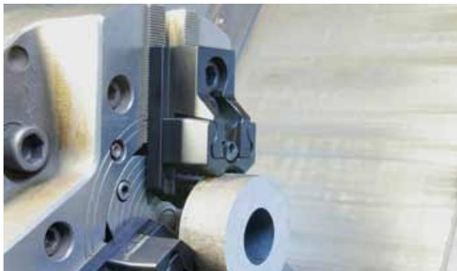
**Insgesamt zehn harte Kralleneinsätze bietet Schunk mittlere für unterschiedliche Durchmesser und Spannbereiche.**
