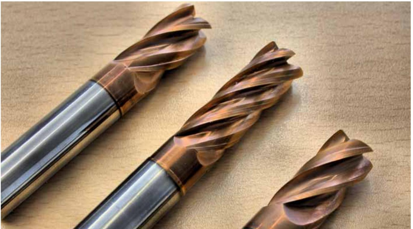
Pendelnd verlaufende Schneiden und Spanwinkel sind das Geheimnis eines energiesparend zerspanenden Fräsers, der unter dem Namen ›S-Cut‹ von WNT vertrieben wird.
