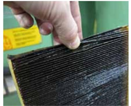
Mit feinsten Schmutzpartikeln dicht bepackte Filterelemente dokumentieren die Wirksamkeit des Friess-Systems.
