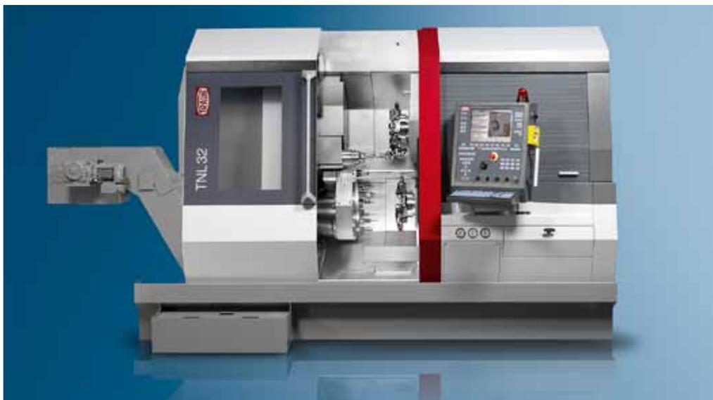
Die Traub TNL32-11 ist eine Lang-/Kurzdrehmaschine mit zwei Revolvern und dreiaxsig verfahrbarem Frontapparat. Es können drei Werkzeuge simultan und unabhängig im Eingriff sein.
