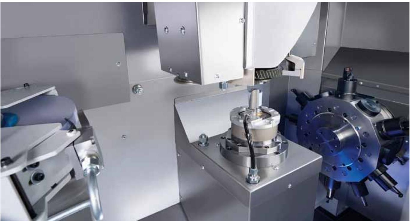
**Drehen, Innen- und Außenschleifen – die VLC 200 GT sorgt dafür, dass gehärtete Futterteile in kürzester Zeit und mit höchster Präzision endbearbeitet werden. Der großzügige Arbeitsraum lässt sich auf jede Anwendung hin konfigurieren.**
