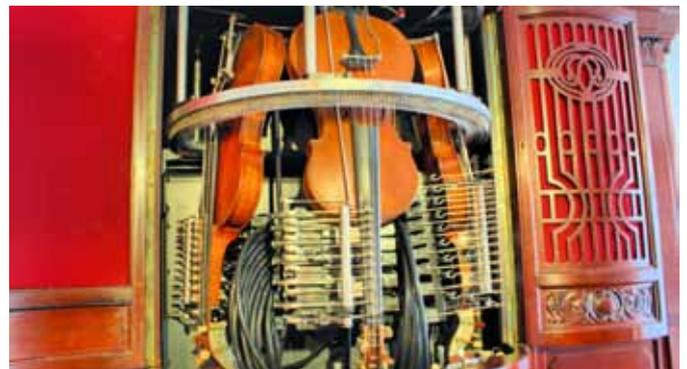
Über einen raffinierten Schwenkmechanismus sowie einen rotierenden Rundbogen wurden die Geigen bei der ›Violina‹ zum Klingen gebracht.
