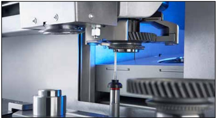
Ein in die VLC 200 GT integrierter Messtaster garantiert eine gleichbleibend hohe Bearbeitungsqualität der Getrieberäder.
