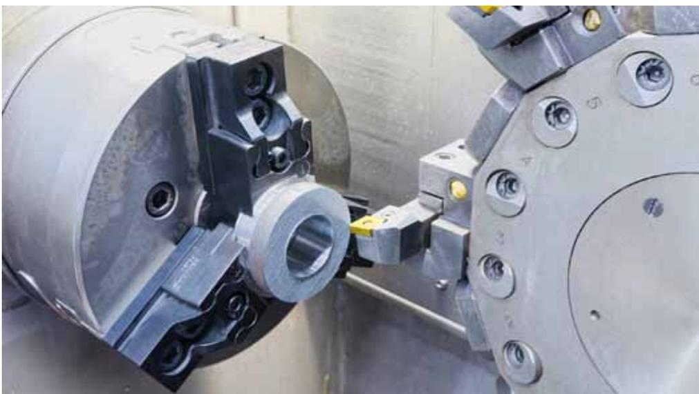
Für die Fertigteilbearbeitung bietet das Pronto-Schnellwechselprogramm von Schunk drei weiche Backenvarianten. Einmal ausgedreht können dieser immer wieder verwendet werden.
