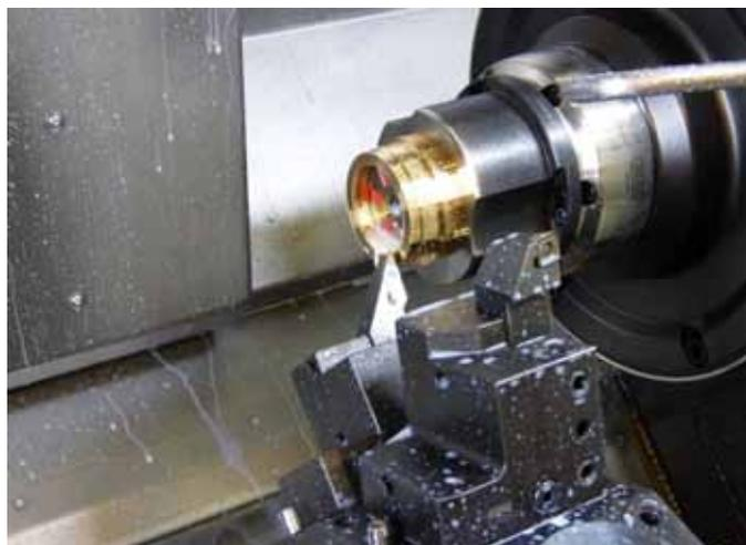
Der Hainbuch-Spanndorn »Mando« hält bombenfest und ist dabei absolut genau. Zudem können die Teile durch die geringe Störkontur des Spanndorns auch seitlich bearbeitet werden.
