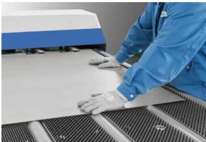
Die gute Zugänglichkeit zum Beladen des Tisches ist gerade bei Restblechen vorteilhaft; links oben sind zwei automatisch einstellbare, in X-Richtung verfahrenende Spannanzgen zu sehen.
