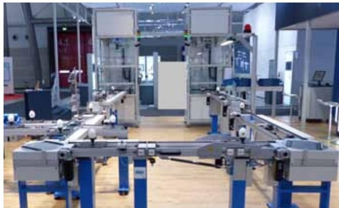
**Das Unternehmen Stein bietet eine große Auswahl an standardisierten Automations-Modulen als Baukastensystem, mit dem sich verschiedene Layout-Varianten realisieren lassen.**
