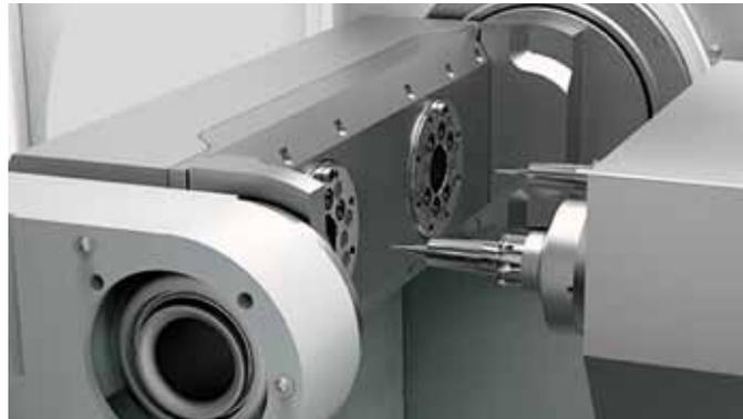
Die ›BA 222‹ von SW ist insbesondere für die vier- und fünfsichtige Mikrozerspanung von fast allen Werkstoffen geeignet.
