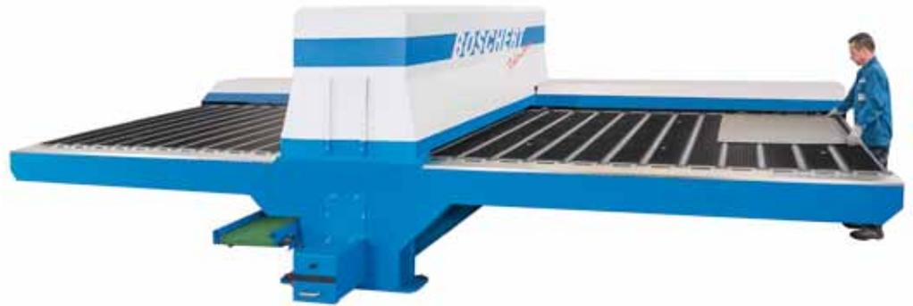
Die kompakte Fiberlaser-Maschine von Boschert besitzt einen feststehenden Tisch. Der Blechtransport erfolgt in X-Richtung, während sich der „fliegende“ Laserkopf in Y-Richtung bewegt.
