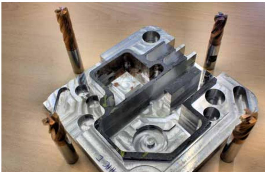
**Damit eine wissenschaftliche Untersuchung des Schnittverhaltens unterschiedlicher Schneiden möglich war, wurde ein Referenzwerkstück entwickelt.**
