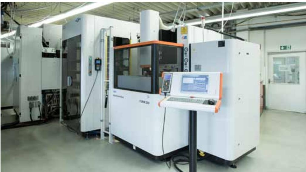
Mit dem 3DS-Bearbeitungszentrum von GF Machining Solutions bei Lauer Harz werden Formen hergestellt, mit denen sich die realen Entformkräfte im Spritzguss mehr als halbiert haben.
