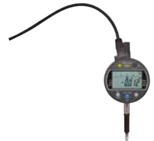
sen. Der Messbereich beträgt 12,7 Millimeter bei einer Messunsicherheit von nur 0,003 mm. Eine analoge Balkendarstellung am oberen Rand des LCD-Displays dient zur raschen Überprüfung der Messergebnisse. Die Bedienknöpfe der Messuhr bestehen nun aus ölresistentem Kunstharz statt Silikon und sind so noch robuster. Der elektromagnetische ABS-Induktionsgeber sorgt für zuverlässiges Messen auch in Umgebungen mit Staub und Spritzwasser.
