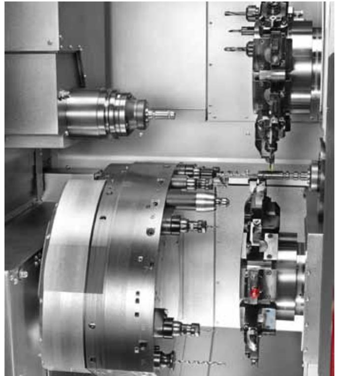
**Merkmal der TNL32-11 ist der Frontapparat, der mit acht Werkzeugstationen – davon vier angetrieben – ausgestattet ist.**
