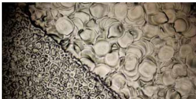
**Mikroskopische Aufnahme einer mit und ohne 3DS erodierten Oberfläche.** Beide Flächen haben denselben Ra-Wert 0,8µ. In der unruhigeren Topographie der linken Fläche ohne 3DS verhakt sich der Kunststoff und lässt sich so schwerer entformen als in der oberen, deutlich homogenen Fläche, die mit der 3DS-Technologie hergestellt wurde.
