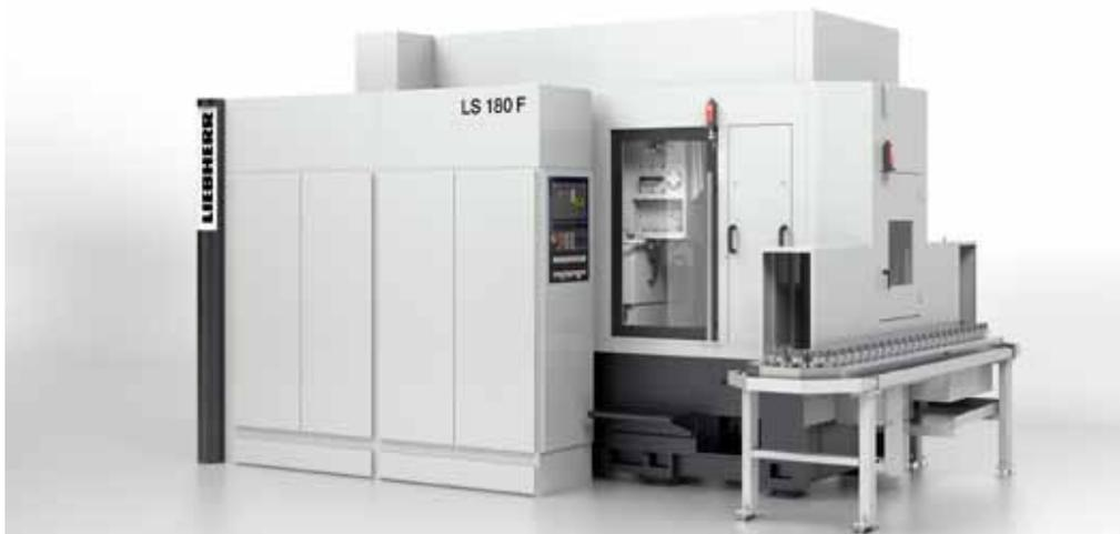
Die Wälzstoßmaschine ›LS 180 F‹ von Liebherr ist ideal für die Bearbeitung von Mehrfachverzahnungen geeignet. Vor allem für Lohnverzahner ist diese Maschine interessant.
