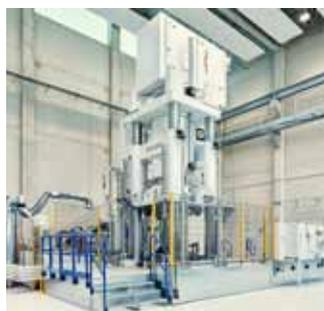
Grad Celsius verarbeitet werden. Die WKP 25000 S hat eine 1500 x 2000 mm große Aufspannplatte und zeichnet sich durch hochdynamische Öffnungs- und Schließgeschwindigkeiten von 300 mm/s, eine Pressgeschwindigkeit von 10 mm/s und eine Öffnungskraft von 360 kN aus. Neben der großen Geschwindigkeit besticht die Presse vor allem durch ihre hohe Präzision: Dank einer aktiven hydraulischen Parallelhaltung beträgt die Planparallelabweichung im Pressgang lediglich 0,05 Millimeter.
