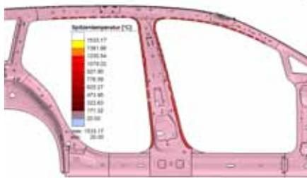
Simufact Welding simuliert auch das Widerstandspunktschweißen.
