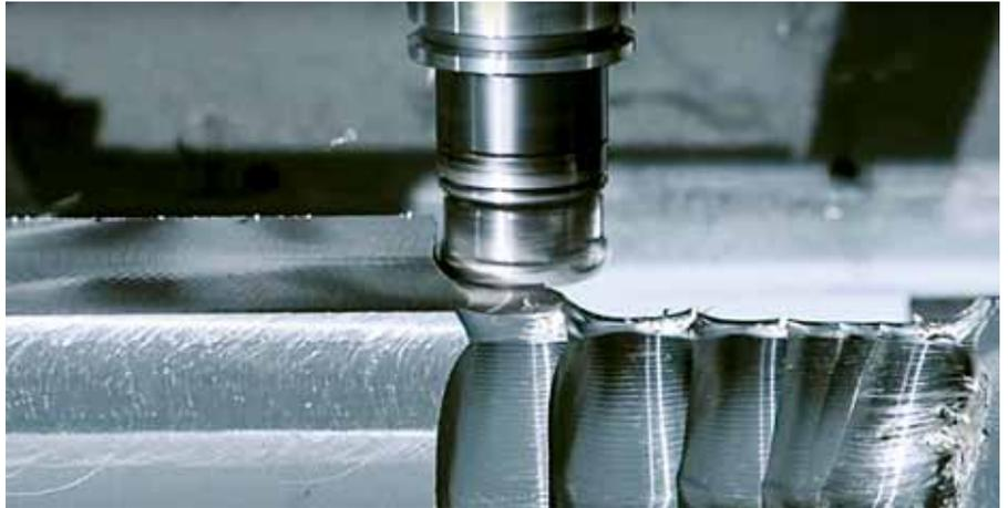
In der Turbinenschaufelfertigung reduziert ATS-Cryolub die Werkzeugtemperaturen im Schruppprozess um über 100 Grad Celsius.
