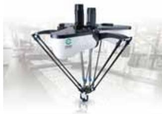
Delta-Roboter erweitert. Mit Servoantrieben ausgestattet, eignen sich die Roboter insbesondere für Dreiachs-Top-Loading-Verpackungsanlagen und die Push-Fit-Montage. Daneben wurde ein wasserfestes Modell entwickelt, das aus hygienisch zugelassenen Materialien besteht und in häufig zu reinigenden Umgebungen eingesetzt werden kann. Die Anbindung kann
