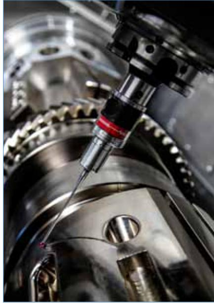
Mit dem Messtaster ›TC63-Digilog‹ hat Blum Novotest sein Angebot um einen digital-analog-Taster erweitert, der sich besonders für den Einsatz in Multifunktionsmaschinen eignet.
