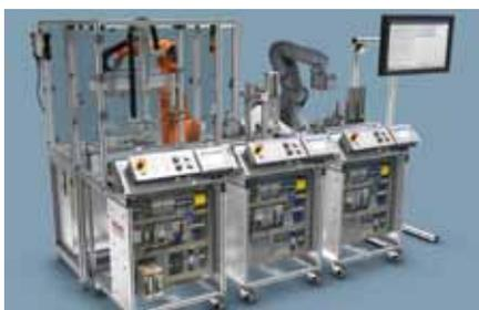
rückt auch im Sinne der Industrie 4.0 den Menschen in den Mittelpunkt und zeigt, wie sich Mensch-Roboter-Kollaboration flexibel und sicher gestalten lässt. Durch die Anbindung an die Production Performance Manager-Software (PPM) gestattet das System ein umfassendes Monitoring, mit dem ein weltweiter Zugriff auf die Maschinendaten der Anlage ermöglicht wird. Beste Voraussetzungen für Übungen und Trainings im Bereich der horizontalen und vertikalen Vernetzung.
