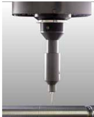
beliebigen Schnitten ohne Einhalten einer Vorzugsrichtung. Darüber hinaus bietet der WCP die Möglichkeit, CNC-gesteuert und in Werkstückkoordinaten zu scannen. Übliche Rauheitskennwerte können auf einfache Weise mit Hilfe der in der Software ›WinWerth‹ integrierten Rauheitsbibliothek normenkonform berechnet werden.
