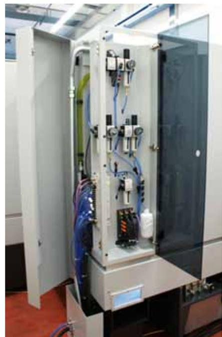
Elektroversorgung, Druckluft et cetera wurden in die Umhausung integriert.
