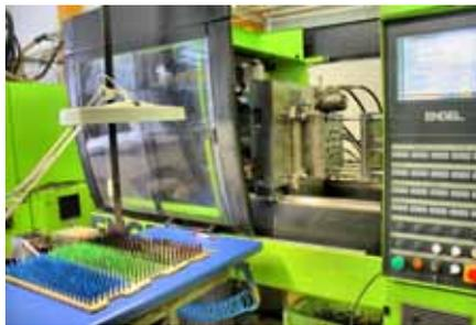
Hochwertige Spritzgießmaschinen von Engel produzieren exakt passende Kunststoffteile. Darunter den Tank für den Cleo-Kolbenfüllhalter.
