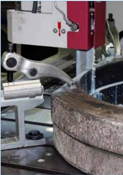
Die Vertikalbandsäge ›LPS60‹ von Behringer hat sich als ideale Maschine erwiesen, um Prüfabschnitte aus verschleißfestem Schleuderguss herauszusägen.
