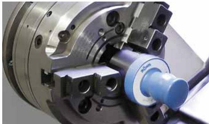
Röhms »F-senso chuck« ermöglicht die kombinierte Messung aus Spannkraft sowie Drehzahl und gibt die Fliehkraftkurve aus.
