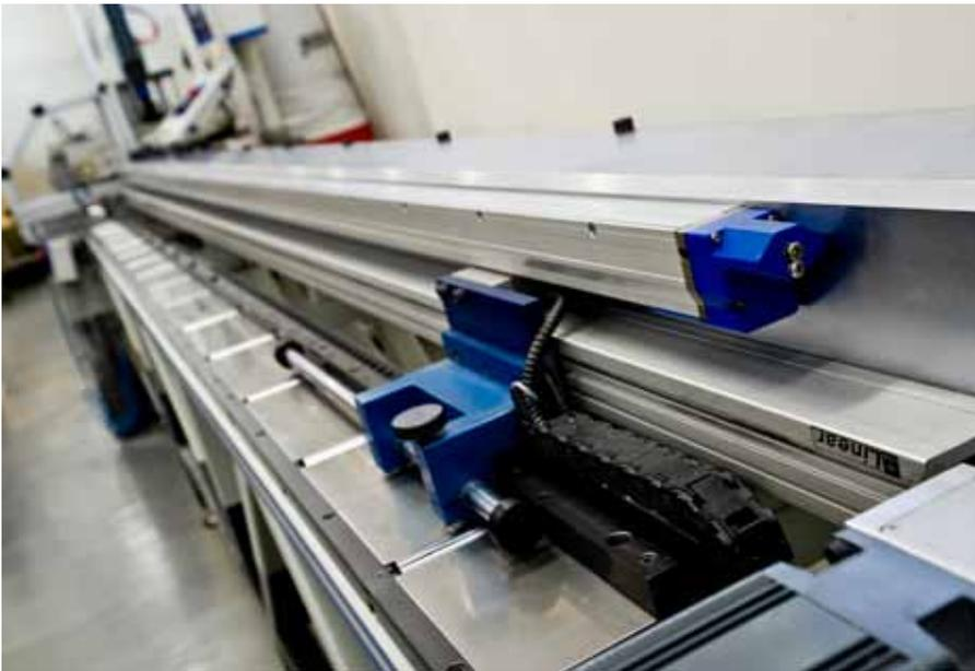
Hochgenaue Wegmeßsysteme mit Glasmaßstäben gibt es von Fagor bis zu einer Länge von 3040 Millimeter. Für größere Strecken bis 60 Meter kommen Stahlbänder zum Einsatz. Alle Systeme sind steckerkompatibel zu den Systemen führender Hersteller, sodass der Tausch in extrem kurzer Zeit abgeschlossen ist.
