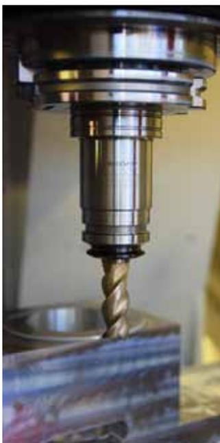
›Powrgrip‹ von Rego-Fix besitzt eine hohe Spannkraft und beste Rundlaufgenauigkeit.
