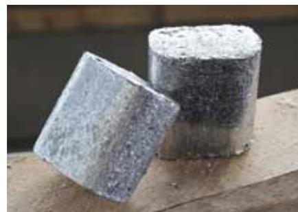
**Um den Faktor sechs werden die Aluminiumspäne beim Verpressen komprimiert und haben dann eine Dichte von 2,3 kg/l.**
