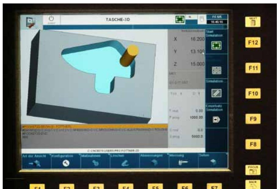
Fagor-Steuerungen überzeugen durch Ihre Leistungskraft. Damit sind selbst Konturen programmierbar, die anderswo ein CAM-System erfordern. Sie wechseln auch Ersatzwerkzeug ein, wenn das aktuell genutzte sich dem Standzeitende nähert.
