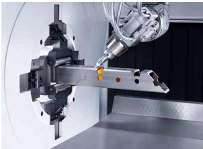
**Mit Schrägschnitten bis zu einem Winkel von 45 Grad eröffnet die TruLaser Tube 7000 vielfältige Gestaltungsmöglichkeiten.**
