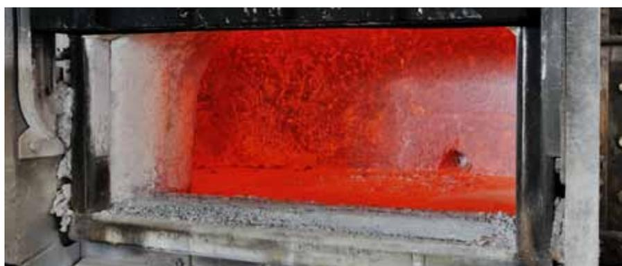
**Angekaufter Aluminiumschrott und die eigenen Alu-Briketts werden bei HMT im Trommelherdofen eingeschmolzen und zu Aluminiumrundbarren gegossen.**
