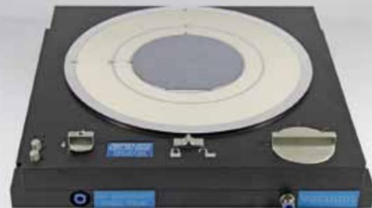
µ-poröse Vakuum-Spannplatte für die Halbleiterproduktion mit drei gesteuerten Spannbereichen, Anschlägen für die Werkstückpositionierung und Liftingpins zur Waferentnahme.
