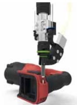
kann mit pneumatischen wie auch strom- oder sensorgesteuerten EC-Schraubern kombiniert werden. Stative oder Portale helfen, das Schraubwerkzeug sicher zur Schraube zu führen. Das Positionierungssystem stellt dabei sicher, dass das passende Verbindungselement an exakter Stelle, zum richtigen Zeitpunkt und mit dem idealen Drehmoment sicher verschraubt wird.
