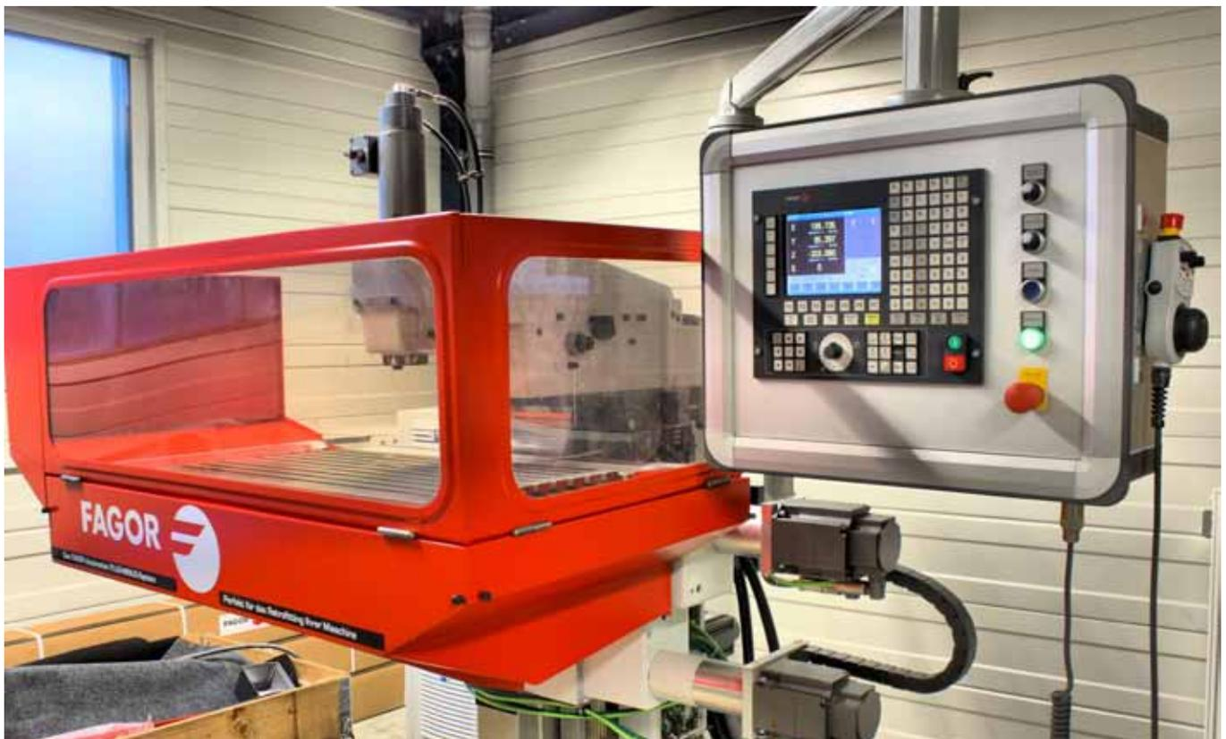
Wenn es gilt, eine alte, doch mechanisch noch brauchbare Maschine wieder fit für die moderne Produktion zu machen, ist Fagor eine gute Anlaufstelle. Beispielsweise ist eine neue CNC an vorhandenen Antriebe anderer Hersteller problemlos anbindbar.
