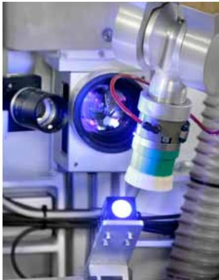
diesem Prozess die Greiferfunktion. Ein Vakuumgreifer aus abriebfestem Kunststoff entnimmt Kugel oder Kalotte aus dem Blister, richtet sie aus und bringt sie mit der zu beschriftenden Fläche in den fixen Laserstrahl. Und auch während der kleinen, schnellen Bewegungen muss der Greifer das Teil sicher halten. Nach dem Ablegen auf einen speziellen Werkstückträger für den anschließenden Messprozess dürfen auf der Werkstückoberfläche, die vorher ebenfalls von einer Zeltwan-
