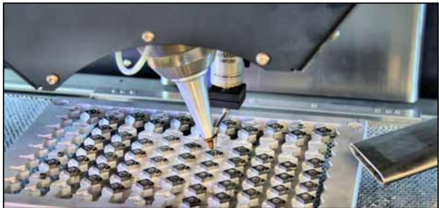
**Der ›PreCutter‹ ist prädestiniert für das Vorbearbeiten der Rohlinge. Er arbeitet mit einem kräftigeren Laser als der RayCutter, damit die Schrupparbeit rasch erledigt ist.**
