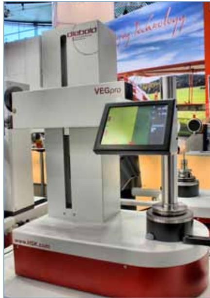
Dank leistungsfähigem Konturrechner und wohlüberlegter Konstruktion lassen sich Werkzeugmaße mit den neuen VEG-Voreinstellgeräten von Diebold besonders einfach und hochpräzise ermitteln.
