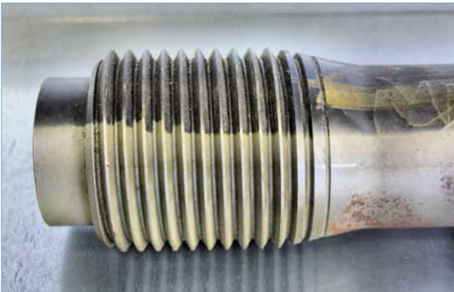
Ohne die Kontur zu beschädigen kann die Reinigungstechnik ›WJT‹ der Waterjet Technologies AG hartnäckige Ablagerungen entfernen.
