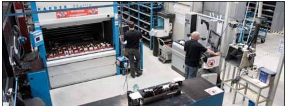
Dank der TMS-Lagerverwaltung von Zoller ist sofort ersichtlich, in welcher Schublade des Kardex-Schranks sich welches Werkzeug befindet.
