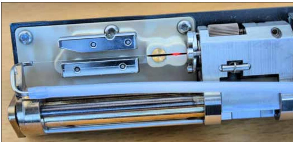
Mit seinem Ink-Jet-Druckkopf hat Leibinger eine raffinierte Drucktechnik im Programm, bei der die Tinte im Druckkopf nicht eintrocknen kann und der Drucker dadurch absolut sicher funktioniert.
