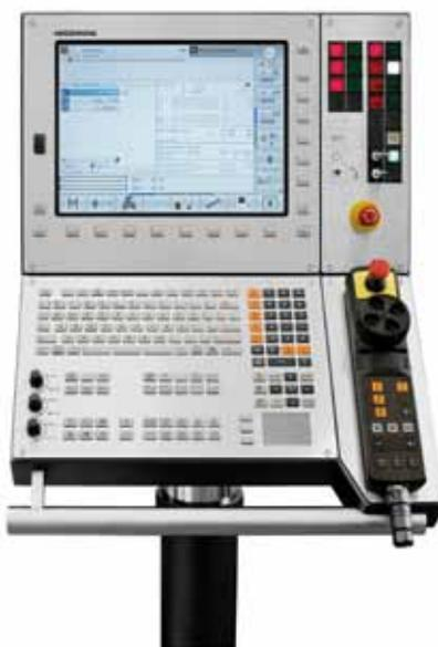
**Die Varia ist mit der Grindplus640-Steuerung von Heidenhain ausgestattet.**
