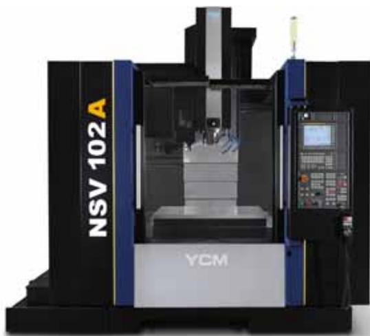
Handrad, Signalleuchte, 30bar-Innenkühlung, Scharnierband-Späneförderer und Ölabscheider sind bei der »NSV 102A« Serie.
