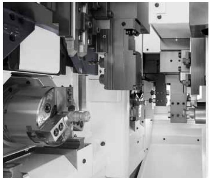
Unterschiedliche Werkzeughalter erlauben vielfältige Produktionsmöglichkeiten wie die Dreh-, Bohr- und Fräsbearbeitung.
