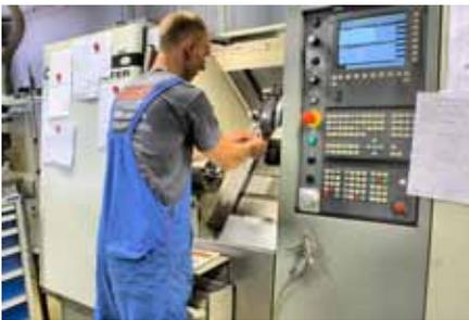
Auf hochwertigen Drehmaschinen, wie etwa einer ›CTX 310‹ von DMG, werden funktionswichtige Bauteile für Cleo-Schreibgeräte aus dem Vollen gedreht.
