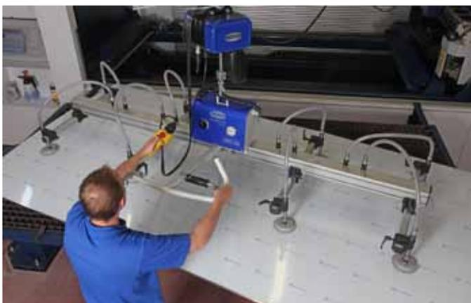
Mit dem ›VacuMaster Basic‹ lassen sich Bleche ergonomisch, sicher und beschädigungsfrei auf den Maschinentisch legen.
