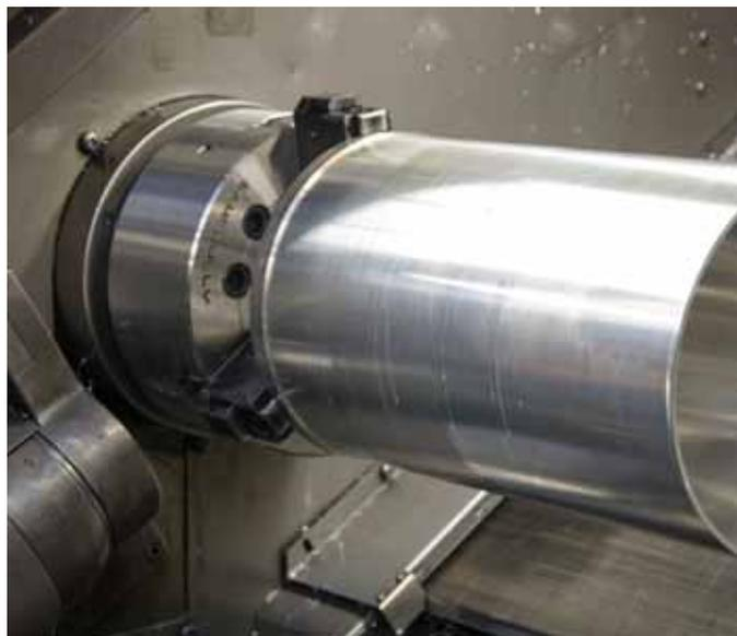
Die InoTop-Hybridspannbacke wurde von HWR speziell für die sichere Drehbearbeitung verformungsempfindlicher Bauteile entwickelt.
