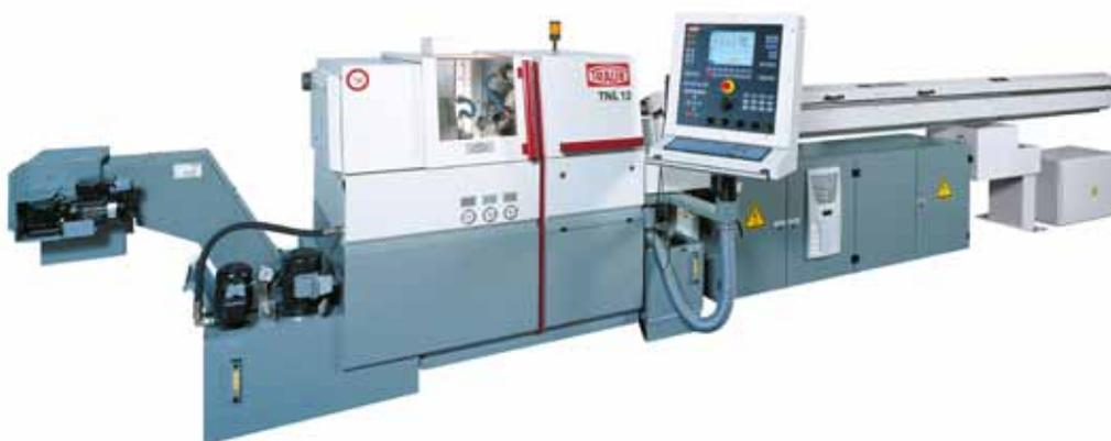
Der platzsparend unter den Stangenlader gebaute zweiteilige Schaltschrank minimiert bei der TNL12 von Traub die erforderliche Aufstellfläche und führt zu extrem hoher Leistungsdichte.
