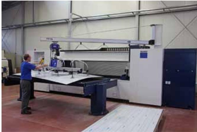
Die Beladelösung von Schmalz besteht aus einem Vakuum-Hebegerät, einem Säulenschwenkran und einem Kettenzug.
