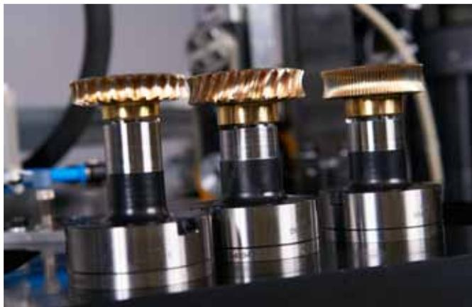
**Federbetätigte Spanndorne von Röhm, die pneumatisch geöffnet werden, spannen die Werkstücke sicher.**
