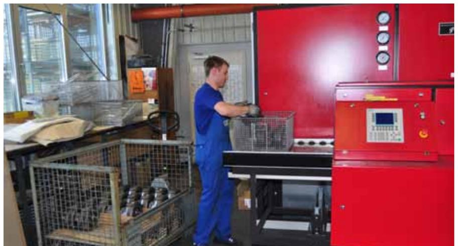
Die Turbolader-Gehäuse werden von Hand in die Waschkörbe eingelegt. Die TWT-Reinigungsanlage von PERO arbeitet vollautomatisch das Waschprogramm ab und regelt Zu- und Abführung der Körbe.
