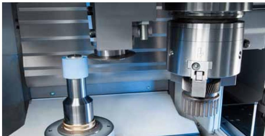
**Die Abrichteinheit mit Diamantrolle. In der VLC 100 G können sowohl Innen- als auch Außenschleifspindeln eingesetzt werden.**
