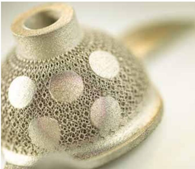
**Hüftimplantat: Laserschmelzen ermöglicht bionische Strukturen für Implantate mit makroporösen Oberflächen. Dabei werden zelluläre Strukturen in das Bauteil integriert, die das Einwachsen ins Knochengewebe unterstützen.** (Quelle: Fraunhofer IWU)
