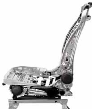
Unter dem Dach von Johnson Controls ist CRH unter anderem an der Entwicklung und Fertigung dieser innovativen, modularen Frontsitzstruktur beteiligt.
