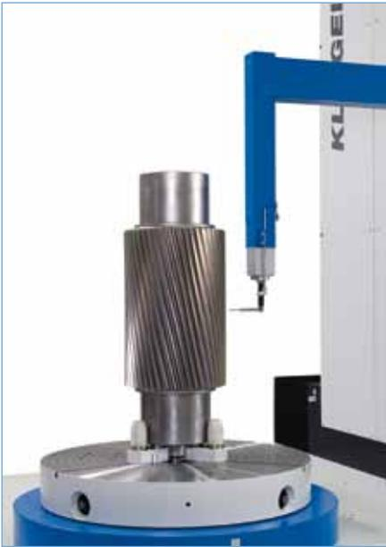
Um Windkraftkomponenten zu prüfen, müssen neben der vollständigen Verzahnungsmessung auch Maß-, Form- und Lagemessungen durchgeführt werden. Klingelberg hat das dazu nötige Know-how.
