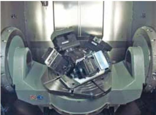
Mehrfachspannung auf 5-Achs Maschinen
