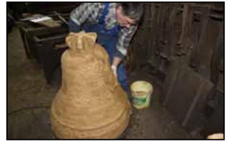
Danach wird auf die »falsche Glocke« eine dicke Lehmschicht aufgetragen, die später die Außenwand der Gussform bildet.
