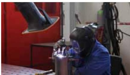
Schweißrauch so punktuell absaugen. Ein weiteres Plus: Mit der intelligenten Regelung des Systems 9000 lässt sich in erheblichem Maß Energie sparen. Ein Frequenzumrichter überwacht den Unterdruck in der Leitung und hält ihn konstant. Zudem wird erwärmte Luft wieder zurück in die Produktionshalle geleitet, was Heizkosten spart.
