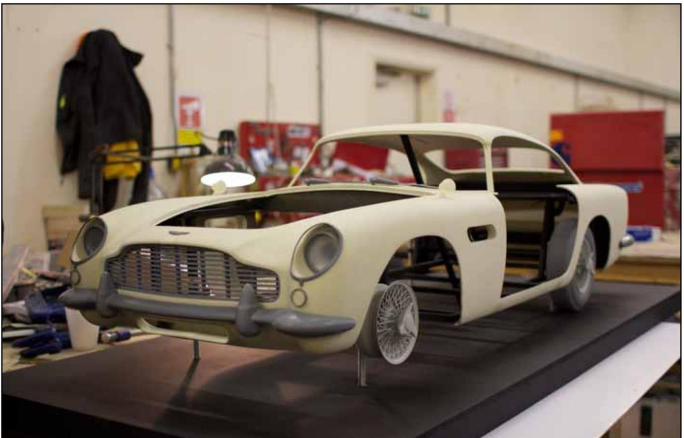
18 Einzelteile, gefertigt mit einer VX4000 von Voxeljet, ergeben zusammengebaut den Dienstwagen von James Bond.
