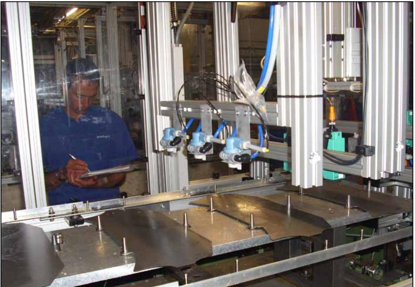
In der Inbetriebnahmephase überprüft ein technotrans-Ingenieur die Pulsfrequenz der Sprühbeölung. Über eigene Sensoren (hellgrün) misst das spray.xact b den Vorschub und erkennt die Werkstücke. Alternativ können Maschinensignale verarbeitet werden.
