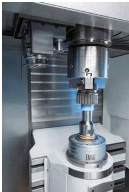
Die VLC 100 G ist mit drei Achsen ausgestattet (X, Z, C). Die Maschine belädt sich über die hängende Pick-up-Spindel selbst.
