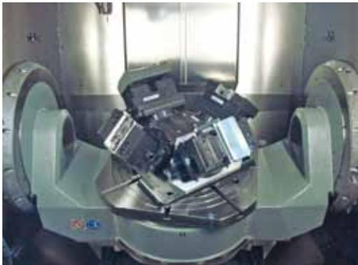
Mehrfachspannung auf 5-Achs Maschinen
