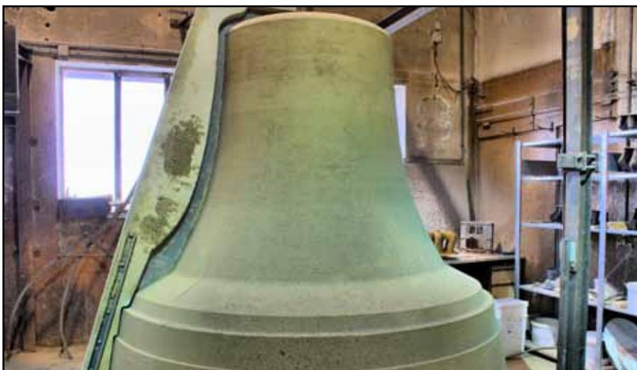
Jede Glocke wird mittels einer Rippenschablone in Form gebracht, die extra für die jeweilige Glocke angefertigt wird.
