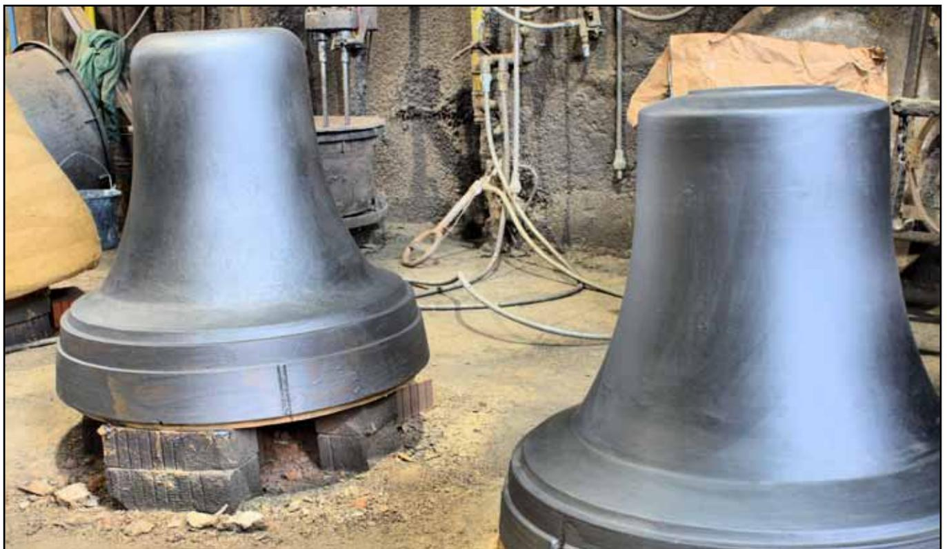
Nach dem Aushärten wird die »falsche Glocke« abgeschlagen. Übrig bleibt die Innenform der Gussvorrichtung, die später mit der Außenform zusammenmontiert wird. Wo die »falsche Glocke« war, befindet sich nun ein Hohlraum, in den die flüssige Bronze fließt.
