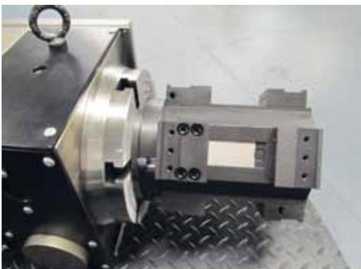
Mehrfachspannung auf 4. Achse mit Monoblock-
