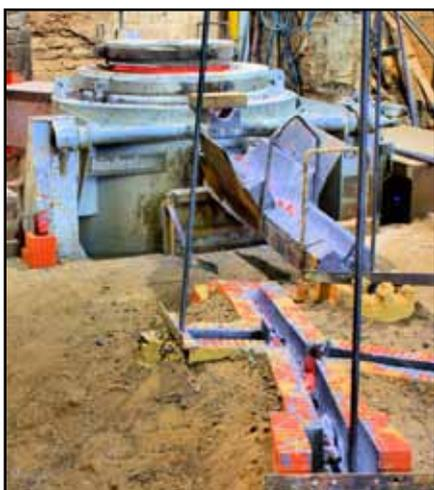
Im Schmelzofen werden Kupfer und Zinn zu Bronze verschmolzen.
