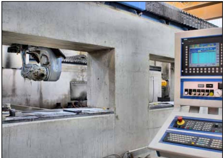
Das Unternehmen Kusser besitzt modernste Maschinen, um Granit für Mess- und Zerspanungsmaschinen präzise zu bearbeiten. So auch dieses Fünffach-BAZ, mit dem schon zahlreiche Maschinenteile für namhafte Unternehmen erstellt wurden.
