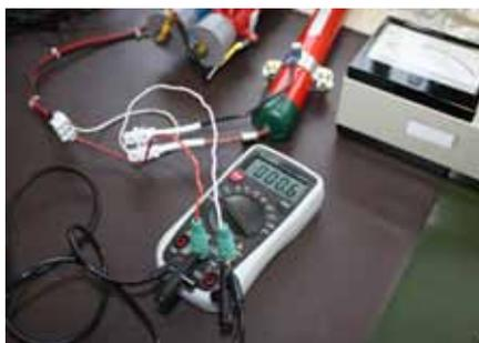
Selbst ein Kurzschluss kann die Kristallzelle nicht schädigen. Die Spannung ist nahezu auf null Volt gesunken.
