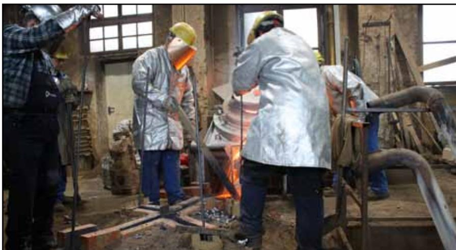
Nachdem die Schmelze reif ist, wird sie abgestochen und in die Glockenform gegossen, die aus Stabilitäts- und Abkühlgründen im Boden eingegraben ist.
