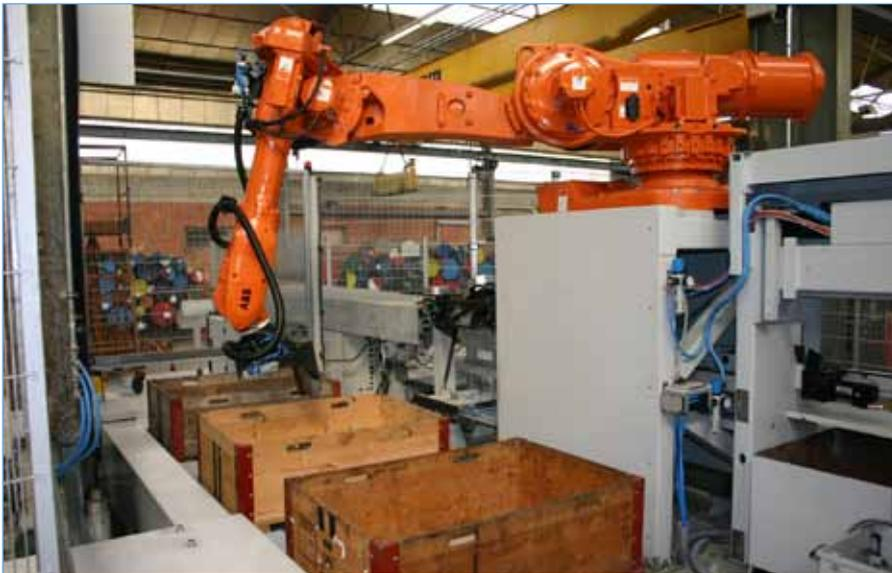
Edelbaustähle rund um die Uhr automatisch gesägt und nach Auftragspositionen sortiert an den Kunden geliefert – mit einer Kasto-Anlage kein Problem.
