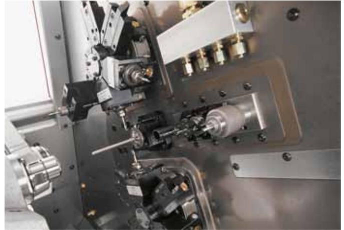
Der Arbeitsraum der TNL12 ist beidseitig sehr gut zugänglich. Die Werkzeughalter werden außerhalb der Maschine voreingestellt.
