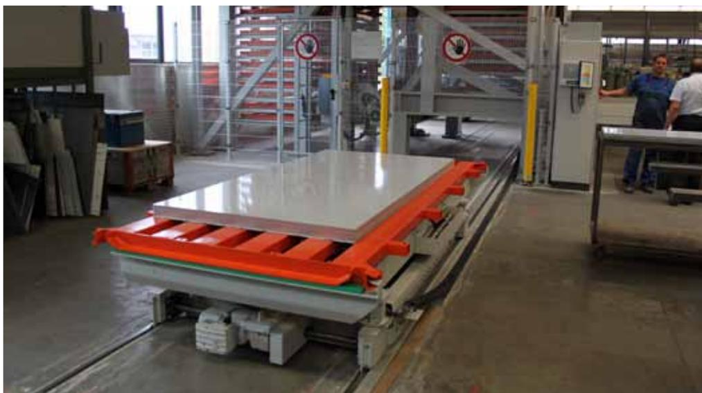
Ausfahren des Längsfahrwagens mit einer Palette aus dem Lagersystem in Richtung Übergabeposition an der Blechscherer.
