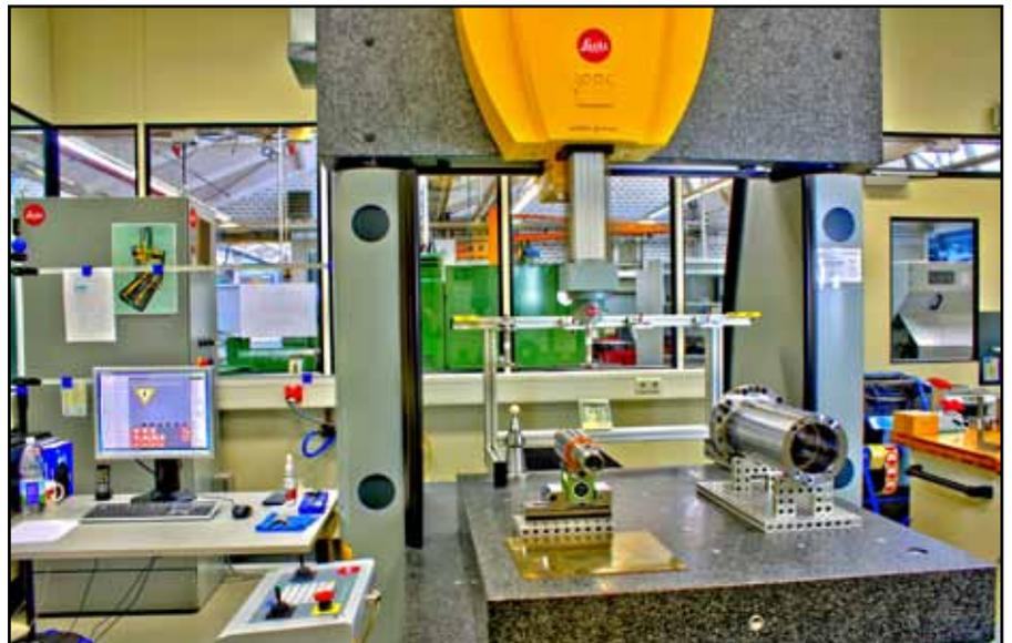
**Moderne Messmaschinen bauen auf einer Granitkonstruktion auf. Das Naturprodukt garantiert präzise Messungen und eine hohe Dauergenauigkeit.**
