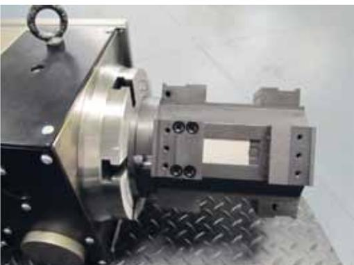
Mehrfachspannung auf 4. Achse mit Monoblock-
