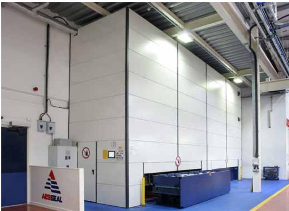
Der Lagerturm von Kasto besitzt eine Besonderheit: Der Boden einer speziellen Kassette kann hydraulisch angehoben werden, um Brammen mittels Handpalettenwagen entnehmen zu können.
