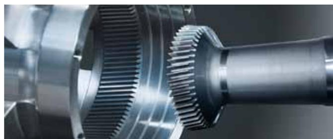
Mit dem Verfahren »Power Skiving« von Gleason lassen sich auch Hohlräder für Planetengetriebe produktiv herstellen.
