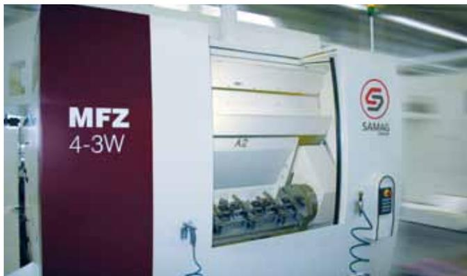
Das dreispindlige Bearbeitungszentrum ›MFZ 4-3W‹ von Samag kann auch für die fünfachsigte Bearbeitung ausgerüstet werden.
