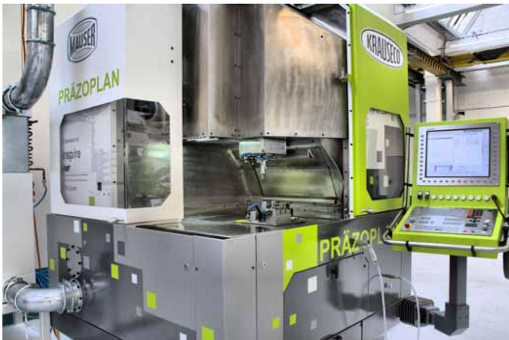
Die ›Präzoplan‹ von Mauser ist eine neuartige Fräsmaschine mit einem revolutionären Konstruktionsprinzip, das Oberflächenqualitäten im Nanometerbereich ermöglicht.
