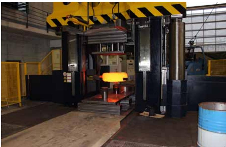
Die Schuler-Anlage mit einer Presskraft von 3 000 Tonnen kann hocheffizient Wellen, Ringrohlinge, Scheiben und andere Bauteile formen.
