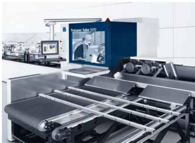
Laserrohrschneidmaschinen von Trumpf sind innovativ und eine Alternative zur konventionellen Rohrbearbeitung.
