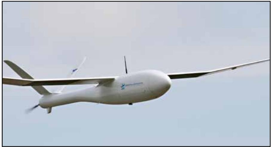
Die Forschungsdrohne ›Impuls‹ wurde von der TU München gebaut und dient als Plattform zur Erforschung von Leichtbau, neuer Brennstoffzellen sowie Sensoren.
