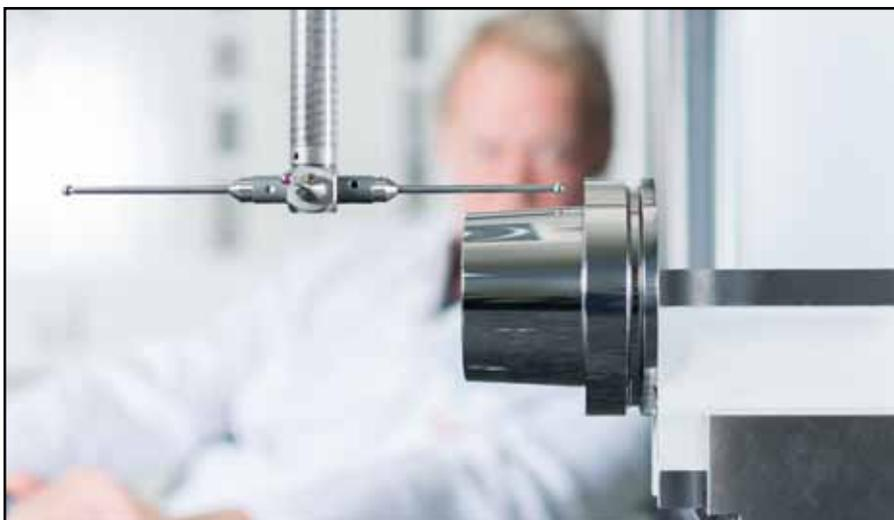
Ein klimatisierter Messraum der Güteklasse »2« und eine Messmaschine vom Typ »PMMC« von Leitz helfen bei Diebold, dass das Spalten des Mikrometers auch weiterhin Routine bleibt.
