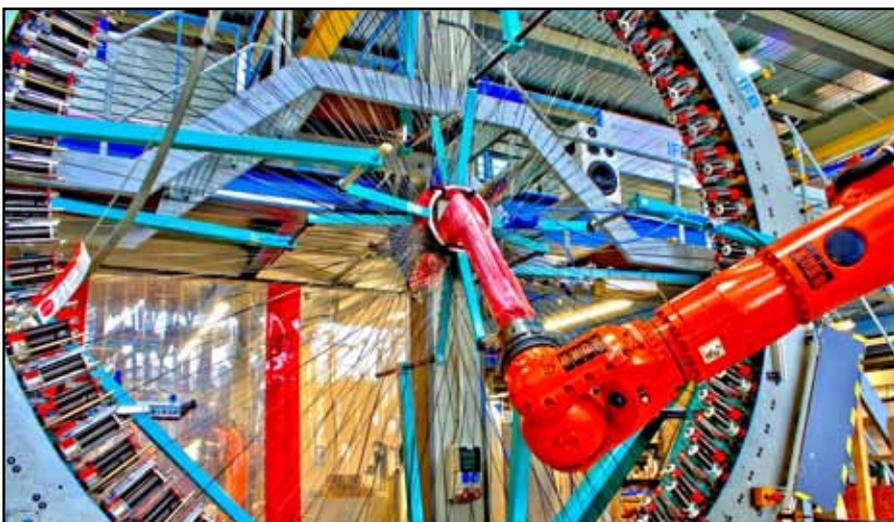
Damit CFK-Fasern künftig nicht mehr von Hand zu Bauteilen veredelt werden müssen, forscht man an der Universität Stuttgart daran, diesen Prozess zu automatisieren.
