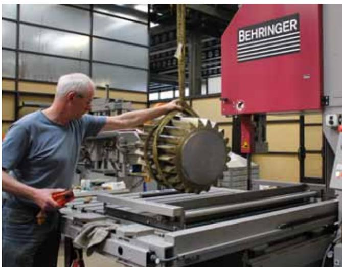
Die Vertikalbandsägemaschine ›LP560T‹ ist in der Lage, Getriebe zu Materialprüfungszwecken zu sägen.
