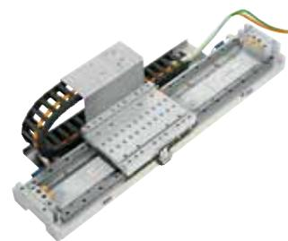
im Mittelpunkt stehen, bietet Hiwin die Linearmotorachsen des Typs ›LMH‹. Bei diesen Systemen sind die Profilschienenführungen und der Linearmotor in das Aluminium-Profil integriert. Durch die im Profil angebrachten T-Nuten können die LMH-Achsen sehr flexibel montiert und mit kundenspezifischen Verfahrenswegen geliefert werden. Die Wegmessung erfolgt inkremental. Optional ist auch die Integration eines absolut messenden Systems möglich.
