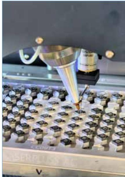
Das Schleifen kommt vielfach zum Einsatz, wenn es darum geht, Diamantbestückte Zerspanungswerkzeuge zu schärfen. Das Unternehmen ›Laserpluss‹ hingegen setzt dazu auf den Laserstrahl.
