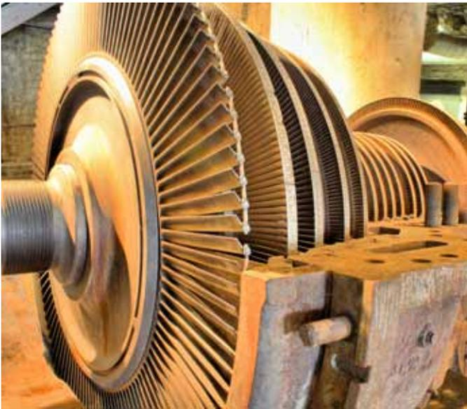
Starke Turbinen erzeugten eine Leistung von 30 MW. Mit dem Strom wurde Sauerstoff verflüssigt und die Bahn, die Wohnanlagen und ein Krankenhaus versorgt.
