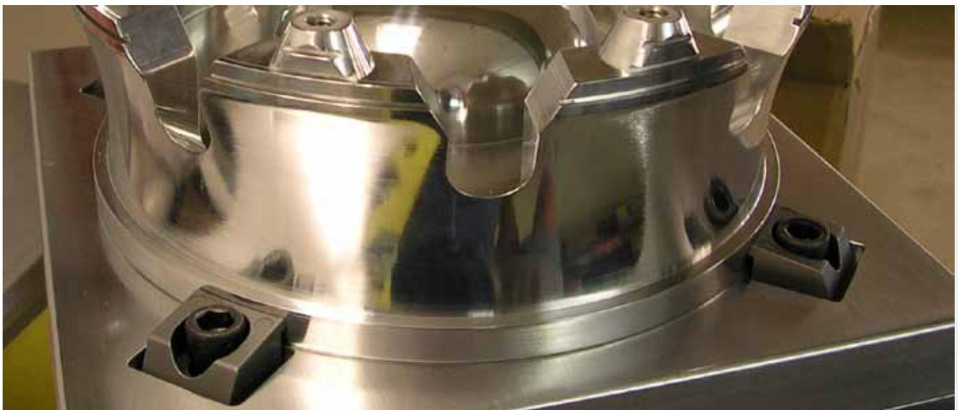
Die Pitbull-Klemme aus der Familie der Mitee-Bite Spannsysteme von IBT zeichnet sich unter anderem durch eine hohe Niederzugwirkung aus. Die kompakte Bauweise erlaubt zudem die Mehrseitenbearbeitung.
