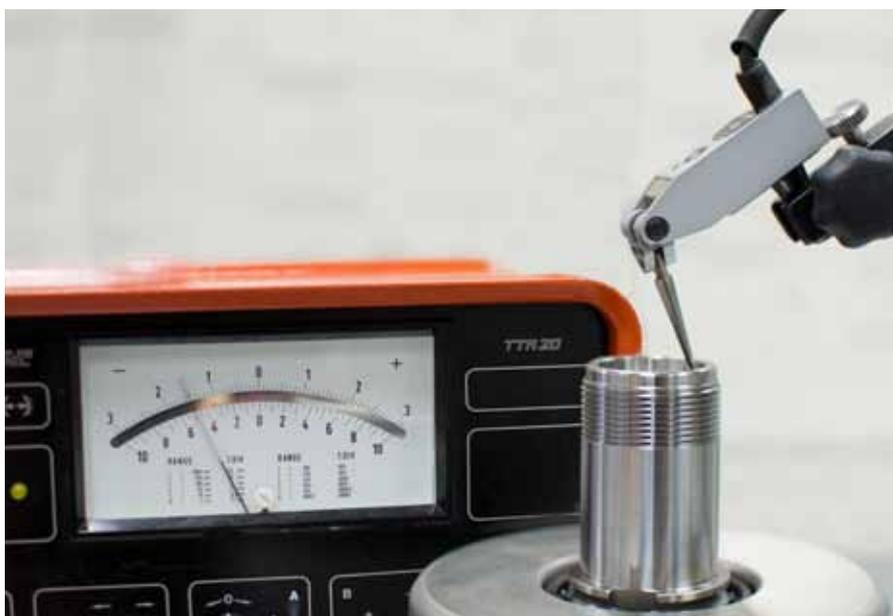
Elektronische Messverfahren garantieren eine sichere Aussage zur Qualität des gefertigten Teils. Zehn Teilstriche an diesem Messgerät ergeben erst ein Mikrometer!
