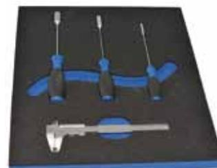
Scanners und einer Software können Kunden individuelle Shadowboards ganz einfach selbst gestalten. Die vor Ort eingescannten Daten werden online an das MyLean-Werk in Wendlingen übermittelt, wo die Einlagen innerhalb von 48 Stunden ausgeliefert werden.
