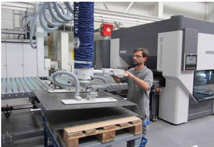
Mit dem Vakuum-Schlauchheber ›JumboErgo 110‹ von Schmalz vereinfacht die Arku Maschinenbau GmbH die Bestückung ihrer Richtmaschinen.
