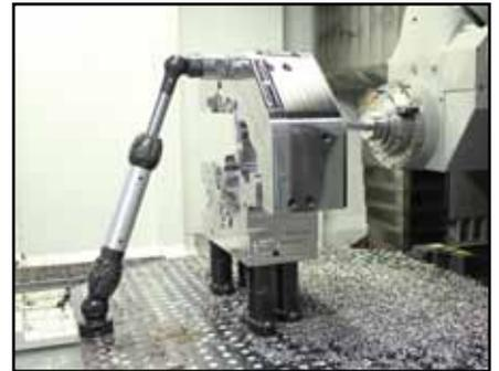
Bei Heck+Becker werden Formteile über ein NP-Spannsystem aufgespannt. WorkNC berücksichtigt dabei die Störkanten.
