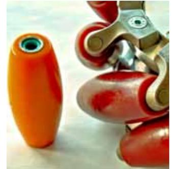
**Grundlage der Mecanum-Fahrzeuge ist das gleichnamige Rad. Mit ihm ist es möglich, ohne Lenkungsmechanik ein Gefährt zu steuern.**
