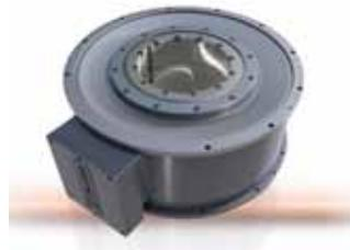
en. Der vergleichsweise hohe Wirkungsgrad des Antriebssystems resultiert aus der direkten Kühlung der Wicklung und der verwendeten neuartigen Umrichter-Topologie. Das aus der hochpoligen Bauweise und den kurzen magnetischen Flusswegen resultierende hohe Drehmoment steht vom Stillstand bis zur Nenndrehzahl dauerhaft und konstant zur Verfügung. Das Produkt ist nicht zuletzt für Werkzeugmaschinenhersteller interessant.
