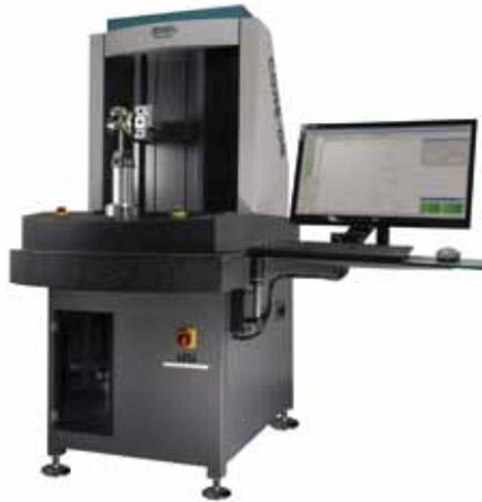
Das Messgerät ›Core‹ besitzt einen Doppel-Augen-Sensor zum Messen.
