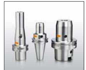
tungsprozesses. CoroChuck 930 kann mit einem speziellen Drehmomentschlüssel schnell angezogen oder gelöst werden. Mit Toleranzen im Mikrometerbereich verbessert das neue Spannfutter die Werkzeugpräzision, die Oberflächengüte und die Produktivität; die Rundlaufgenauigkeit beträgt weniger als 4 µm (bei 2,5xD). CoroChuck 930 ist als Pencil-, Slender- und in Heavy-Duty-Ausführung erhältlich.
