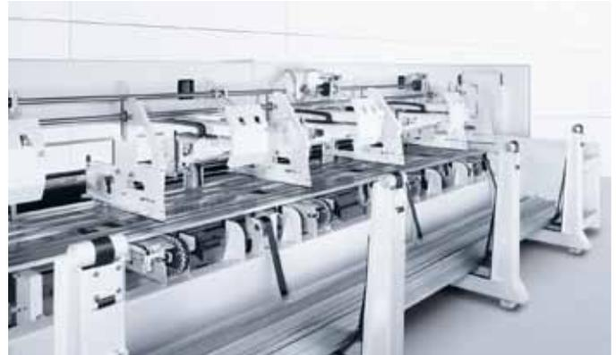
Die Beladeeinheit ›LoadMaster Tube‹ belädt die Maschine automatisch und bereitet das Rohmaterial hauptzeitparallel vor.
