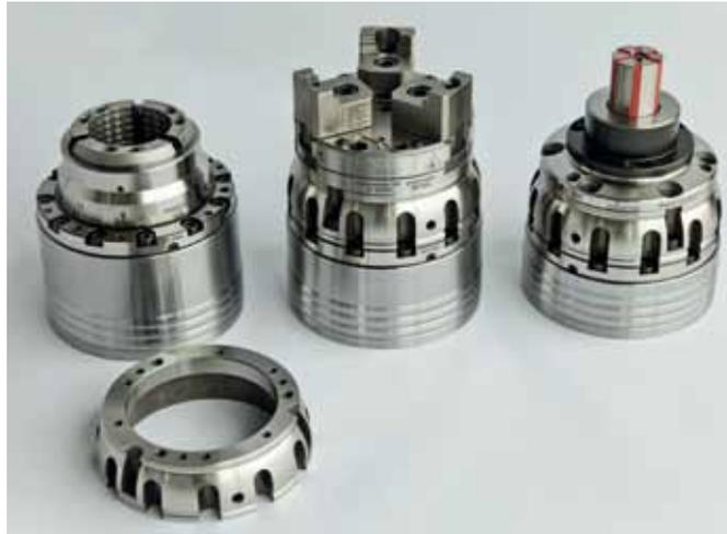
Die Mini-Baureihe ist jetzt dank eines Adaptionrings kompatibel mit dem Baukasten-System von Hainbuch.
