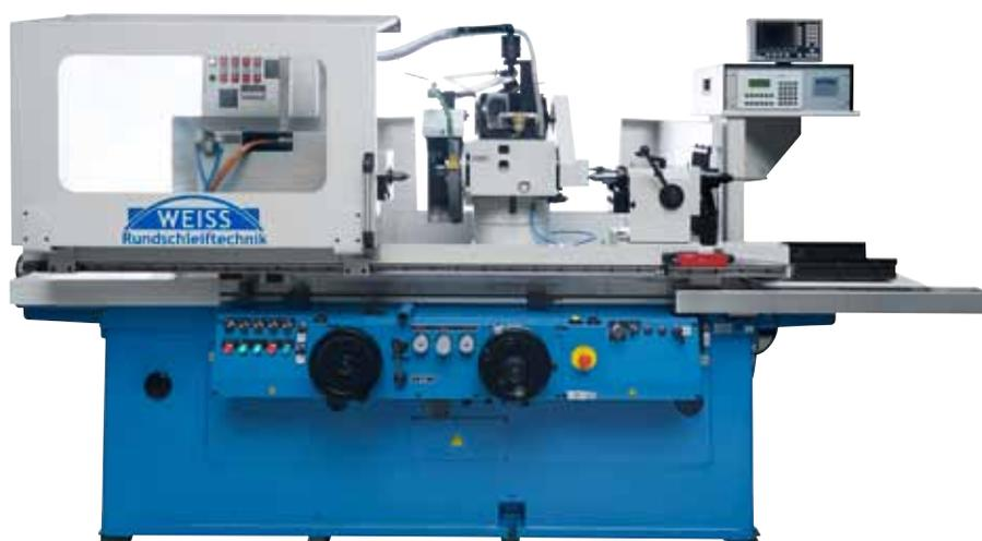
**Die ›W11‹ wird all denjenigen zusagen, die eine präzise, manuell bediente Rundschleifmaschine für Einzelteile und Prototypen suchen.**
