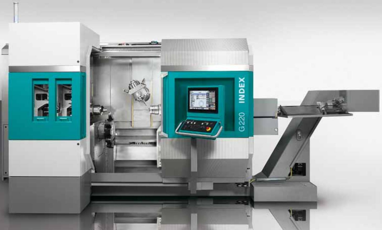
**Das Dreh-Fräszentrum INDEX G220 mit der dynamischen Motorfrässpindel ist ausgelegt für die Bearbeitung von anspruchsvollen Werkstücken – bis hin zur Fünffachbearbeitung. Mit einem hohen Maß an Steifigkeit, thermischer und dynamischer Stabilität sowie Schwingungsdämpfung – auch dank der hydrostatisch gelagerten Y/B-Achse – können Werkstücke produktiv, präzise und komplett bearbeitet werden.**
