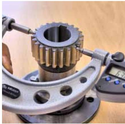
Eine Bügelmessschraube besitzt oft austauschbare Kugeleinsätze, die passend zu verschiedenen Moduln erhältlich sind.
