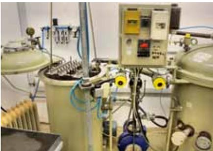
Mittels einer Vakuumpumpe gelangt ein auf zehn Grad Celsius abgekühltes Spezialöl in das Kompassgehäuse.
