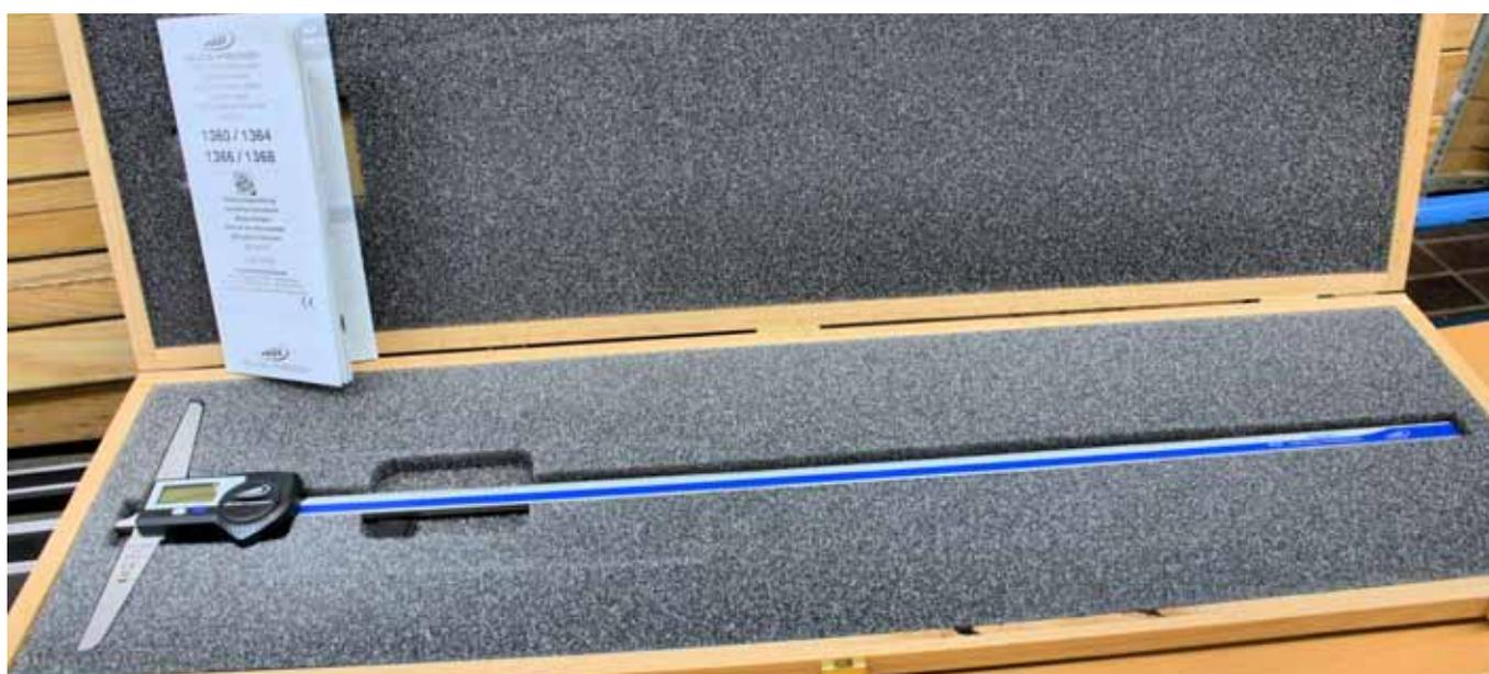
Messschieber von Helios-Preisser gehören zur Spitzenklasse ihrer Zunft. Sie sind mit Skala, Messuhr oder Digitalanzeige zu haben. Die elektronischen Varianten besitzen die Schutzklasse »IP67« sowie einen Datenausgang für die Messwertübertragung an den PC.
