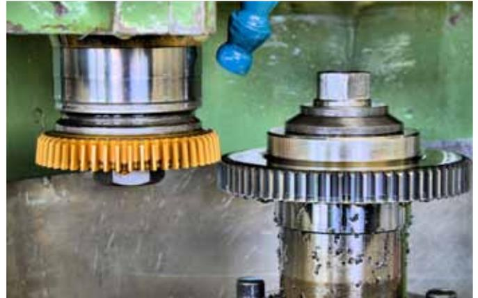
Das Wälzstoßen erlaubt es, rasch und preiswert Teile zu verzahnen. Die Stoßwerkzeuge sind beschichtet, um deren Standzeit zu verlängern beziehungsweise um die Oberflächengüte der Werkstückzähne zu verbessern.
