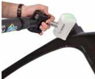
Durch die bedienerfreundliche Plug-and-play-Installation und benutzerfreundliche Funktionen, wie das völlig neue Näherungssensor-Konzept, das dem Anwender die korrekte Messposition zeigt, können die Vorteile der Erfassung hochdichter 3D-Punkte mit dem HP-L-8.9 sehr schnell genutzt werden. Der Scanner ist natürlich mit allen gängigen Softwareanwendungen für mobile Koordinatenmessgeräte kompatibel.
