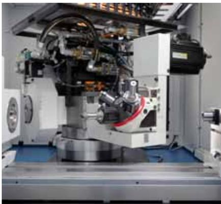
**Hartdrehen, -fräsen und Innenschleifen: Ein Sauter-Revolver macht die ›WUG21‹ zu einer flexiblen Rundschleifmaschine.**
