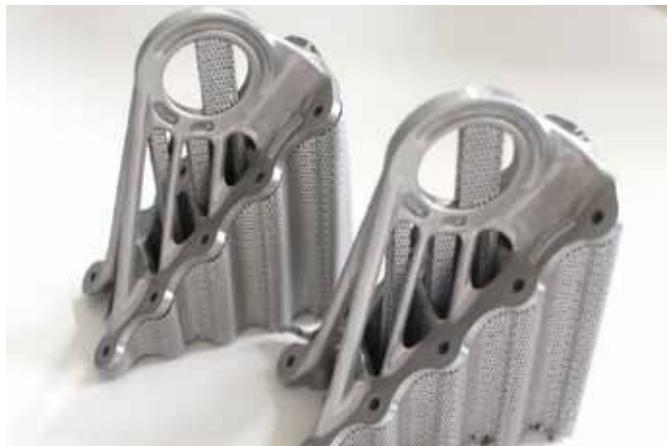
**Effekte durch Variation der Laserleistung am Beispiel des Kabinenhalters ›Bracket‹ des Airbus A350 XWB: Der Defekt ist optisch nicht erkennbar, wird aber durch die Prozessdaten von ›QMmeltpool 3D‹ erschlossen.**
