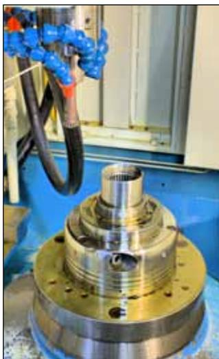
Einbringen einer Innenverzahnungen per CNC-Maschine.
