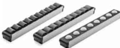
die Rollen die bidirektionale Bewegung, so stehen die Kugelleisten für die Beweglichkeit in alle Richtungen. Die Kugeln aus Polyacetal (POM) drehen sich in Halterungen aus Polyamid leise, reibungsarm und wartungsfrei. Jeweils acht Kugeln befinden sich in einem der Module, die mittels der Trägerprofile zu größeren Einheiten kombinierbar sind. Mit einer Belastbarkeit von 30 Newton ist das als ›GN 646.2‹ bezeichnete Element für die meisten Anwendungen ideal dimensioniert.
