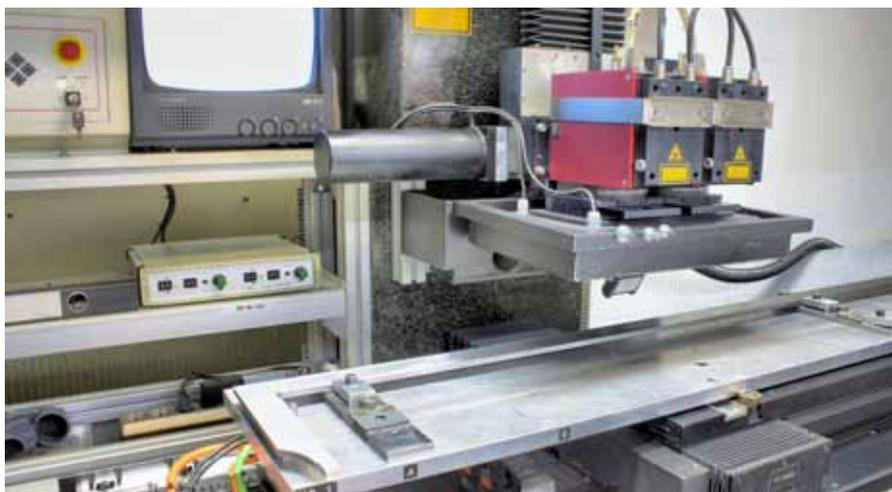
Per Laseranlage von Rofin wird die Skala auf den Stab der Messschieber eingraviert. Die 6,7 Tonne schwere Anlage ist so präzise, dass dieser Vorgang mit einer Genauigkeit von 0,0025 Millimetern erfolgt.
