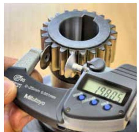
Eine Bügelmessschraube mit Tellermessfläche eignet sich besonders zum Prüfen von Zahnrädern mit großen Zähnen.
