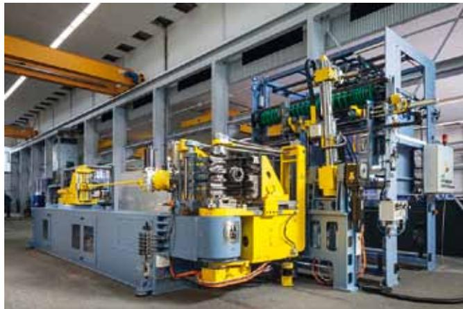
Maschinen der Serie ›CNC MR‹ sind mit Mehrfachbiegewerkzeugen für die effiziente Herstellung von Rohren ausgestattet.
