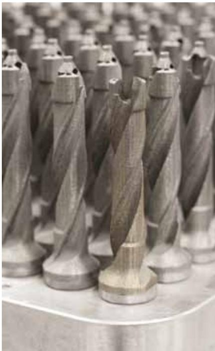
Das Laserschmelzen ermöglicht es, Grundkörper im Durchmesserbereich 8 bis 12 mm mit gewendelten Kühlkanälen im 3D-Druckverfahren herzustellen.
