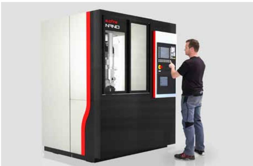
Beim Planfinish-Prozess geht es um die Bearbeitung einer Werkstückstirnseite mit der Stirnseite einer Topscheibe. Die »Nano« von Supfina ist darauf spezialisiert.
