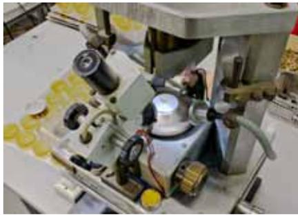
Skala und Magnetscheibe werden unter dem Mikroskop mithilfe eines künstlichen Magnetfeldes exakt ausgerichtet.
