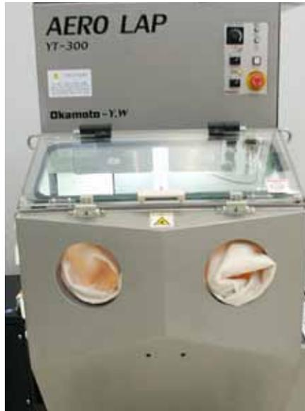
Mit ›Aerolap‹ sind neben HSS und Hartmetall auch Komponenten mit PVD- und CVD-Beschichtungen läppbar.
