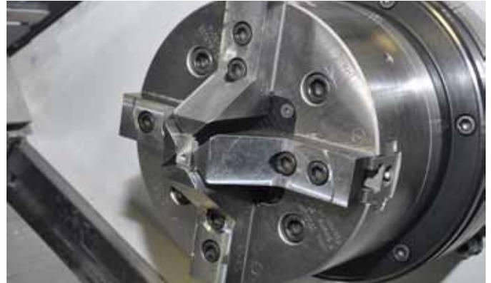
Das ausgleichend spannende Vierbackenfutter »Inoflex« von HWR ist auch für geometrisch unförmige Teile einsetzbar.
