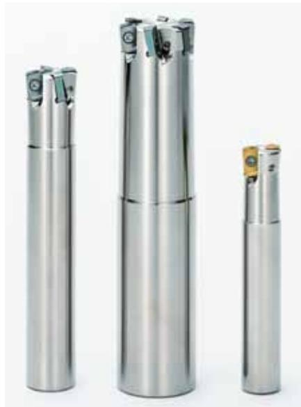
rate, die hervorragende Spanabfuhr und eine optimale Plattenauswahl erlauben dem MFH mini eine hocheffiziente und stabile Bearbeitung und tragen zu verbesserter Produktivität bei. Die wohlüberlegt geformte Schneide wurde eigens entwickelt, um den Stoß beim ersten Kontakt mit dem Werkstück zu mildern. Die Wendeschneidplatte löst Probleme bei der Spanabfuhr, die typischerweise beim
