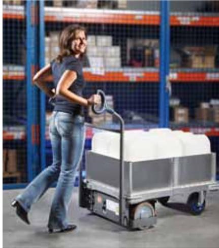
Das touch2move-Antriebskonzept lässt sich mit nahezu allen Vierradwagen und anderen Transportwagen kombinieren. Realisierbar ist dies durch den Einsatz der FSR-Technik in den wartungsfreien Sensorgriffen und den digital geregelten Radnabenmotoren. Gespeist werden die Antriebe durch zwei wartungsfreie Batterien in Vlies-Technologie mit jeweils 12 V. Ein besonderer Vorteil ist, dass diese beim Ladevorgang nicht gasen und somit das Transportgerät in beliebiger Umgebung beim Aufladen geparkt werden
