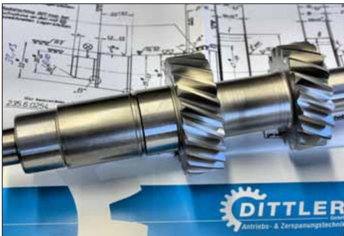
Hochwertige Dreh- und Frästeile, die noch verzahnt werden, sind die Spezialität der Dittler GmbH aus Straubenhardt.
