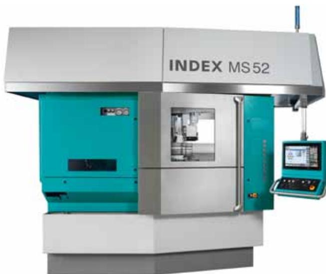
Der modular aufgebaute CNC-Mehrspindeldrehautomat ›MS52C3‹ von Index kann als Handhabungsmaschine oder Stangenmaschine betrieben werden.
