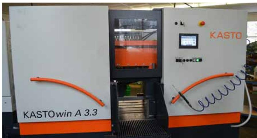
Die ›Kastowin A3.3‹ bietet einen Schnittbereich von 330 Millimeter und lässt sich per Touchscreen bedienen. Stangenmaterial kann damit mannlos zugeschnitten werden.
