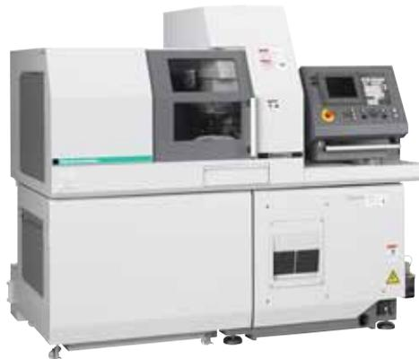
Die ›Cincom L20-XII‹ von Citizen verfügt über eine zusätzliche, schwenkbare B-Achse mit angetriebenen Werkzeugen.
