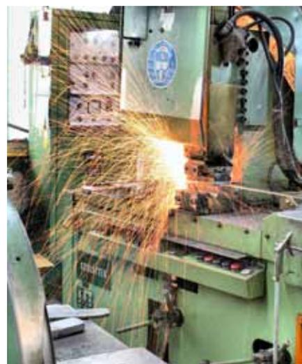
Per Abbrennstumpfschweißen werden die Messschieberteile zusammengeführt.
