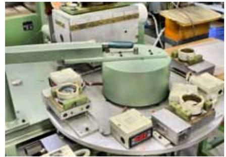
Bei 65 Grad Celsius werden Boden und Kapsel miteinander hochfrequenzverschweißt.
