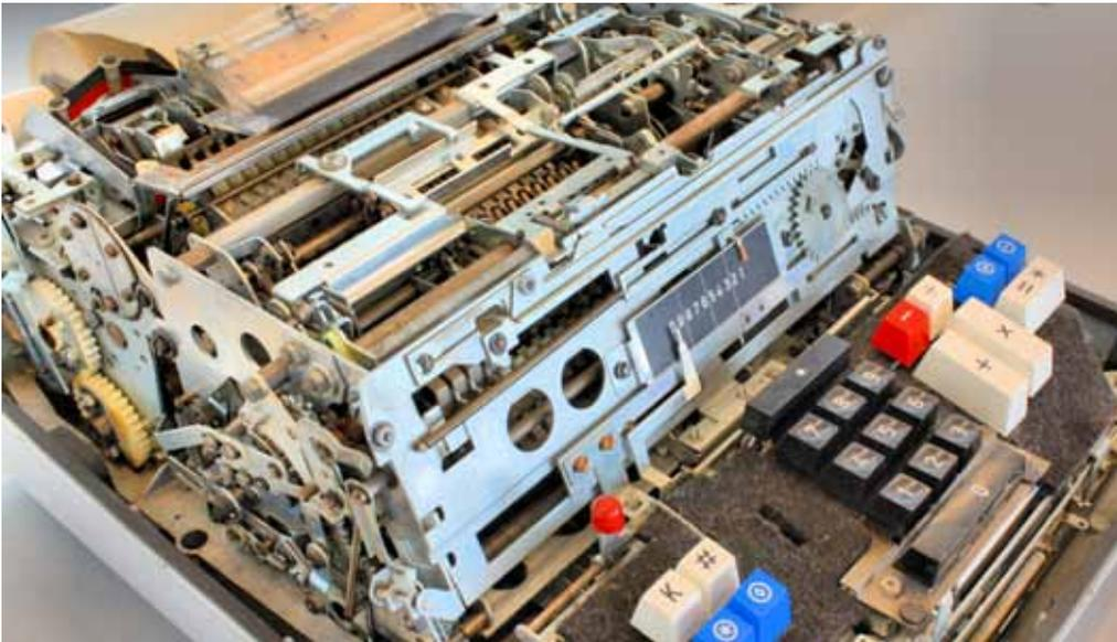
Die äußerst kompliziert aufgebaute ›Hamann 1630‹ von 1969 bildet das Ende der Ära mechanischer Rechenmaschinen. Danach wurden vermehrt Rechenmaschinen eingesetzt, die mit Röhren und Transistoren funktionierten.
