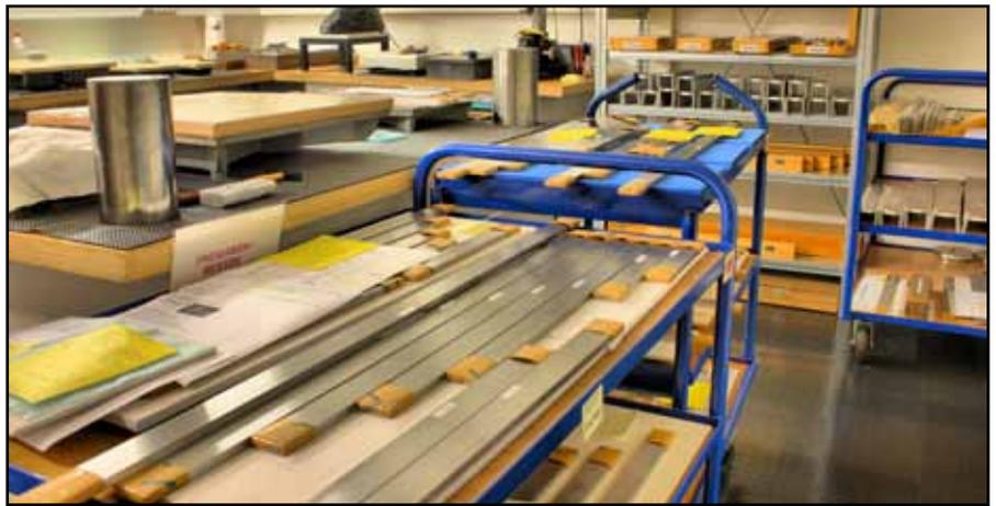
Bis zu 30 Stunden müssen besonders lange Endmaße auf Prüftemperatur gebracht werden, ehe sie bei exakt 20 Grad Celsius gemessen werden können.
