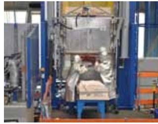
die durch mehrere Temperaturschichten geführt werden, lassen sich die Blechhaltekräfte besonders genau einstellen. Im Kaltbetrieb bringt die Presse eine Stößelkraft von 3150 kN und eine Tischkissenkraft von 1250 kN auf, im Warmbetrieb 800 und 250 kN. Die Umformgeschwindigkeit für Titan-Teile reicht bei der Heißumformung von 0,1 bis 2,0 Millimeter in der Sekunde, bei der Kaltumformung von fünf bis 30 Millimeter in der Sekunde.
