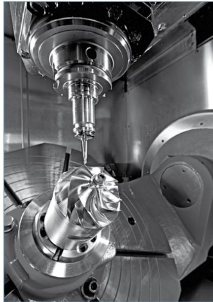
Selbst moderne Werkzeuge bilden bei Titan Aufbauschneiden oder verkleben mit dem Werkstoff. Abhilfe schafft die Kühlschmierstrategie ›Cryolub‹ des Schmier Spezialisten Rother Technologie.
