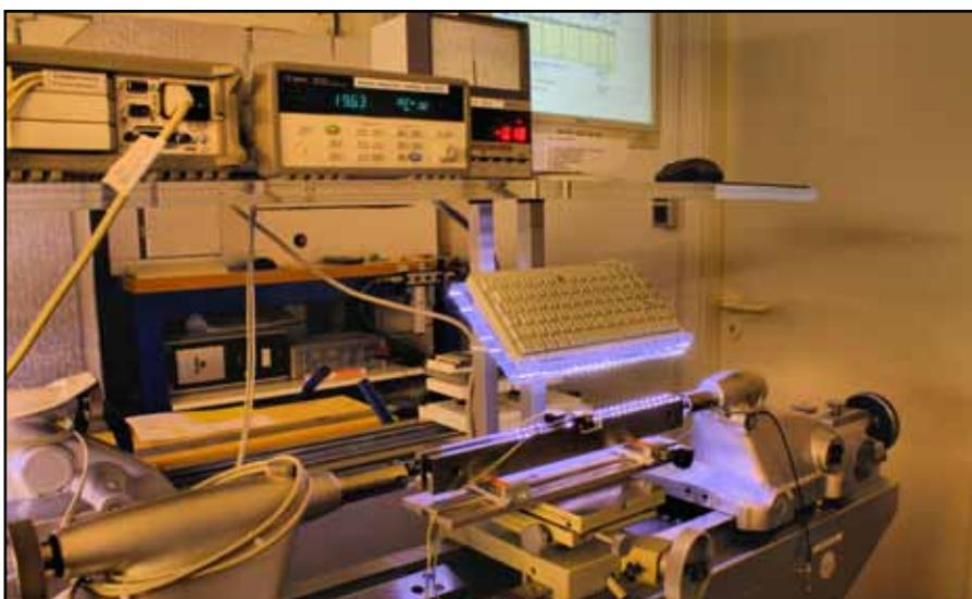
Modernste Messtechnik und ein klimatisierter Messraum sind nötig, um Endmaße mit der erforderlichen Genauigkeit auf Ist-Maß zu prüfen.
