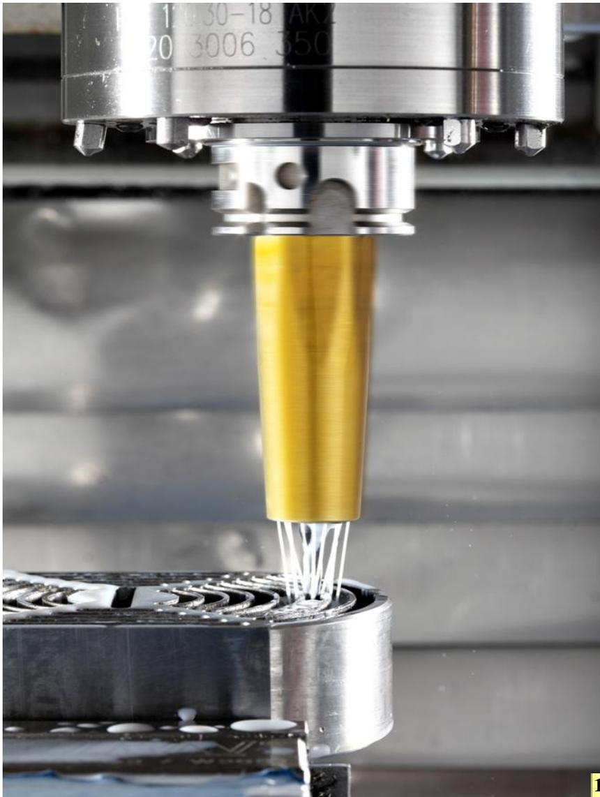
1 Der JetSleeve von Diebold sorgt dafür, dass beim Fräsen die Späne sofort weggeschleudert werden und dadurch der Nachteil des schlechten Spänefalls beim Senkrechtfräsen ab sofort Geschichte ist. Zudem sorgt diese Innovation dafür, dass sich die Fräserstandzeit mindestens verdoppelt.
