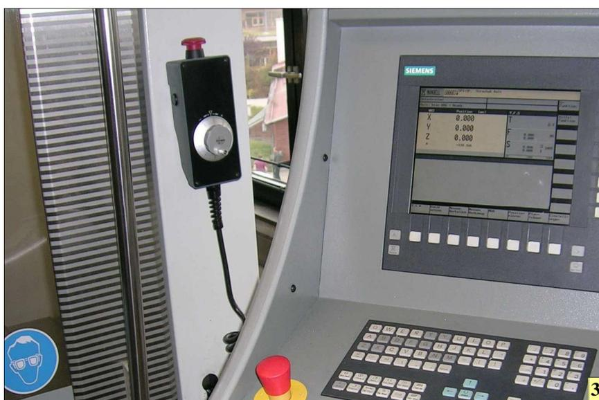
2 Nach dem Einschalten einer CNC-Maschine wird zunächst der Referenzpunkt (R) angefahren. Dieser Vorgang kann bei modernen Maschinen eventuell entfallen. Der Maschinennullpunkt (M) ist vom Hersteller vorgegeben und kann nicht verändert werden. Der Werkstücknullpunkt (W) ist der Startpunkt der Bearbeitung des Werkstücks.
