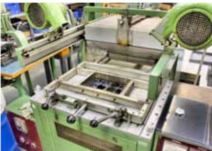
Per Vakuumtiefziehmaschine werden aus dem Material ›Genotherm‹ die Kapselgehäuse hergestellt.
