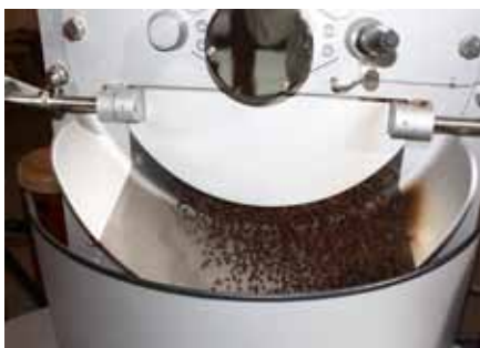
Nach dem Rösten fallen die heißen Bohnen in einen Behälter, wo sie mittels einblasener Luft abkühlen.
