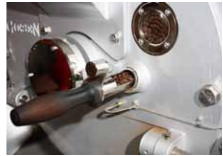
Ausschließlich das Auge des Experten entscheidet, ob die Kaffeebohnen den richtigen Bräunungsgrad erreicht haben.
