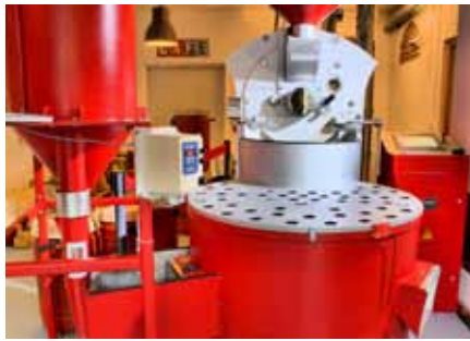
Per Vakuum werden die Kaffeebohnen in die Röstmaschine eingesaugt und bei 200 Grad Celsius 20 Minuten geröstet.
