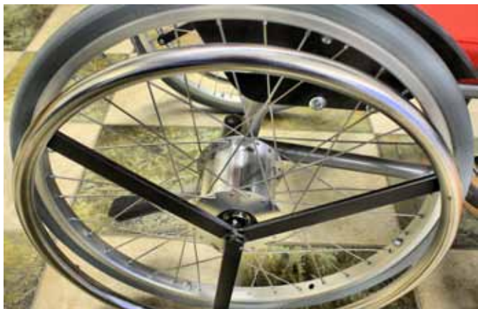
Mittels eines Übersetzungsgetriebes, das von Bräunig selbst entwickelt wurde, können auch weniger muskulöse Menschen mit einem Rollstuhl problemlos fahren.
