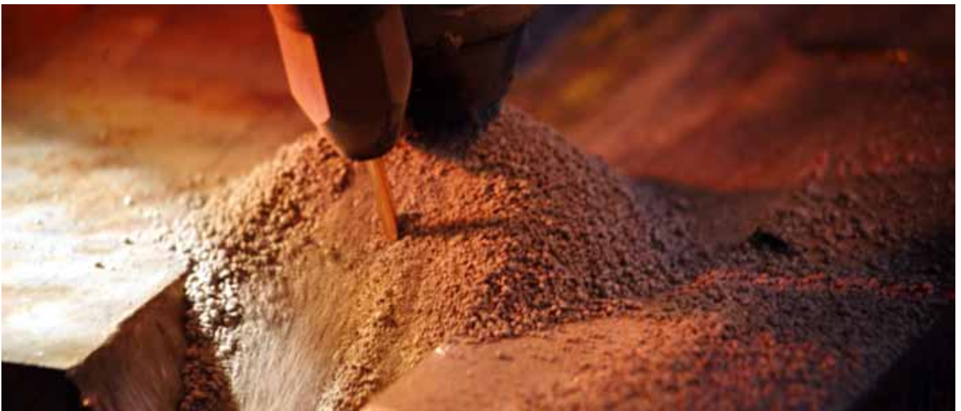
Beim Unterpulverschweißen brennt ein Lichtbogen verdeckt unter einer Pulverschicht und schmilzt das zu verschweißende Material auf. Zusammen mit dem Material der ebenfalls abschmelzenden Elektrode entsteht eine sehr homogene Schweißnaht.
