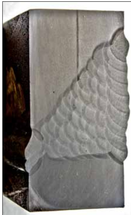
Absolut gleichmäßige Schweißnähte mit extrem homogener Struktur sind die überragenden Merkmal des Unterpulverschweißens.
