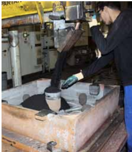
Die Formen werden mit einem Sand gefüllt, der von einem Harz-Härter-Gemisch durchtränkt ist und dadurch aushärtet.
