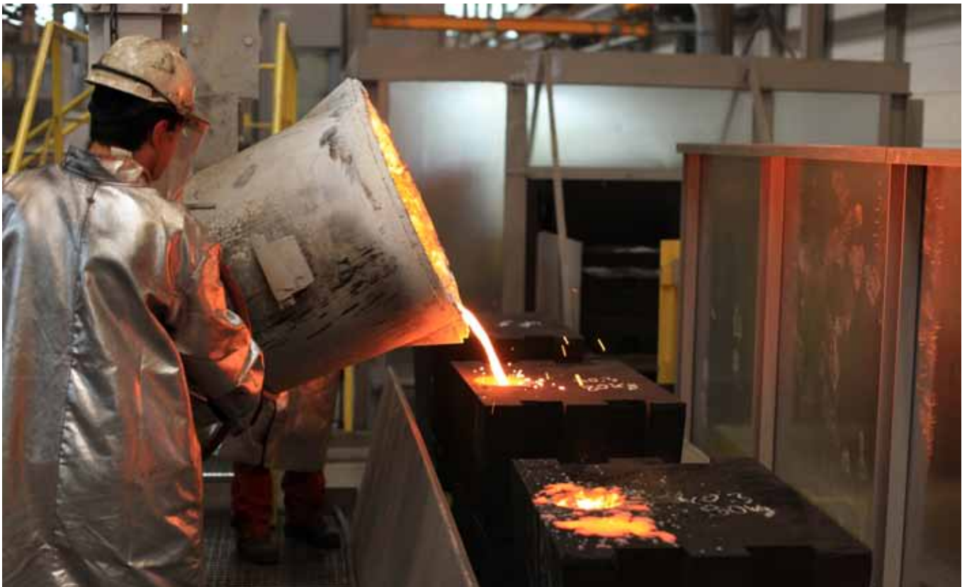
Behringer produziert Spitzenmaschinen zum Materialzuschnitt. Die dazu nötigen Gussteile aus Sphäroguss werden mit Hilfe von Gussformen in der eigenen Gießerei erzeugt. Das flüssige Material wird in die Form eingefüllt und erstarrt dort zu einem Werkstück.
