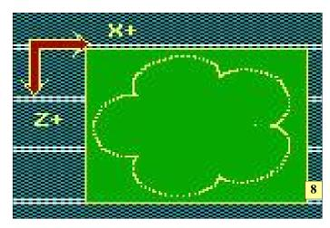
8Durch Veränderung der Formeln sind die Ergebnisse der gefrästen Formen abwandelbar. So wird beispielsweise durch die Änderung der Kreisdurchmesser aus einer Kardioide eine Epizykloide.
