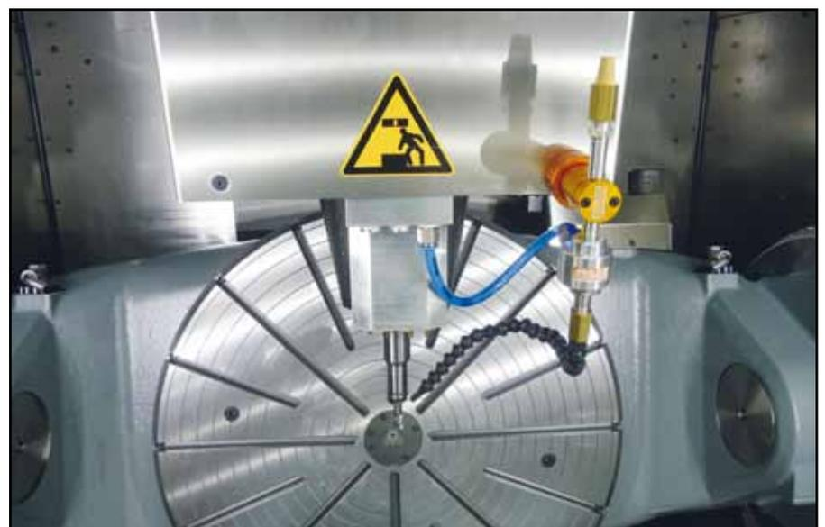
Die sogenannte Kaltluftdüse erzeugt durch einen physikalischen Effekt einen kalten Luftstrom, der eine Temperatur von bis zu minus 30 Grad Celsius erreichen kann. Dadurch wird die Zerspanungswärme abgeleitet und Späne weggeblasen, wodurch die Standzeit des Fräswerkzeugs um bis zu 30 Prozent steigt.
