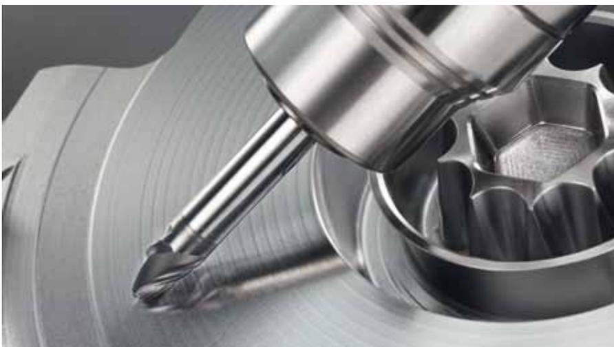
Die innovativen Kreissegmentfräser des Fräswerkzeugspezialisten Franken sind ein optimaler Ersatz für Kugelfräser. Damit sind wesentlich kürzere Bearbeitungszeiten und weit bessere Oberflächengüten möglich.
