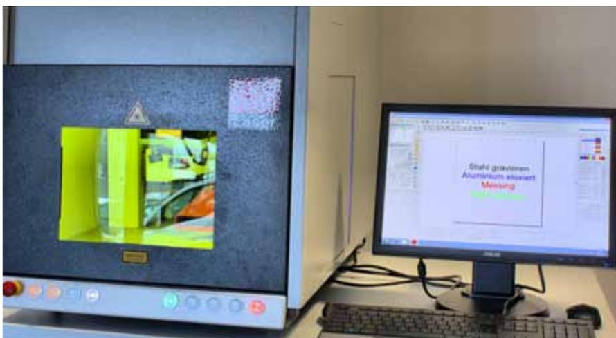
größter und kleinster Elemente. So sind beispielsweise 0,7 Millimeter im Durchmesser messende Auswerferstifte problemlos mit einer sechsstelligen, schrittweise erhöhbarer Nummer gravierbar. Selbst noch kleinere Objekte sind unkompliziert markierbar, da der Laser über einen Durchmesser von lediglich 0,02 bis 0,025 Millimeter verfügt, was sich nicht zuletzt dafür anbietet, an versteckter Stelle eines Produkts einen winzigen Text als Plagiatskontrolle einzubringen.
