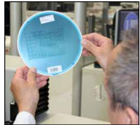
Biochips sind auf Glas aufgebrachte Kulturzellen oder Gewebeschnitte von Tierorganen, die der Untersuchung von Antikörpern in menschlichem Blut dienen.
