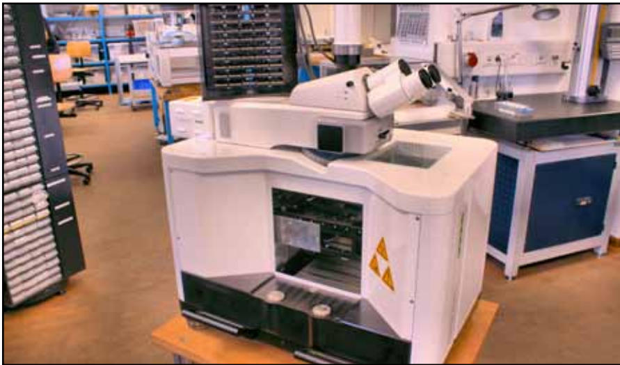
Das System ›Europattern‹ beinhaltet ein hoch entwickeltes, computergestütztes Immunfluoreszenz-Mikroskop, das vollautomatisch die Biochips, die sich auf den eingeschobenen Objektträgern befinden, analysiert.
