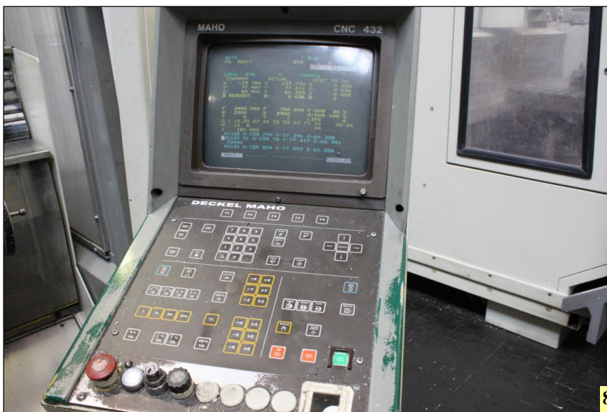
8 Die bedienerfreundliche Philips 432-Steuerung ist immer noch in vielen Betrieben zu finden. Insbesondere in der Ausbildung ist diese Steuerung noch weit verbreitet, nachdem die Maschinen aus der Fertigung ausgelagert wurden. Die Philips 432-Steuerung bildet die praxisgerechte Grundlage für das CNC-Simulationsprogramm SIM_WORK.
