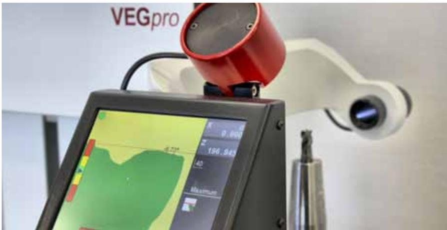
Ob Flankenwinkel, Radius, Fase oder Strecke – es gibt keine Kontur am Zerspanungswerkzeug, die mit der Messsoftware des VEGpro nicht vermessen wäre.
