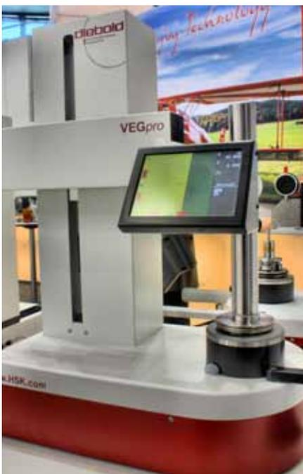
Diebolds ›VEGpro‹ ist ein hochpräzises Werkzeugvoreinstellgerät.
