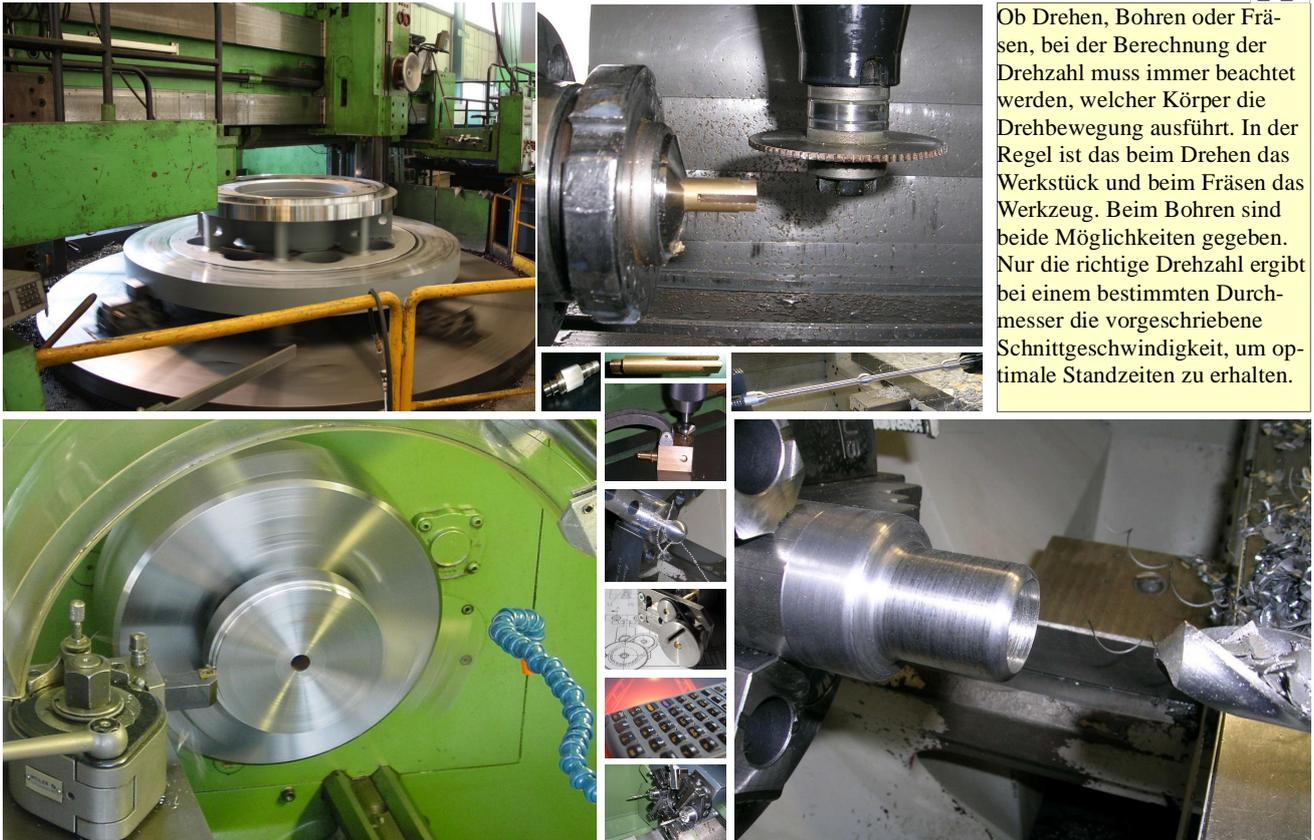
Ob Drehen, Bohren oder Fräsen, bei der Berechnung der Drehzahl muss immer beachtet werden, welcher Körper die Drehbewegung ausführt. In der Regel ist das beim Drehen das Werkstück und beim Fräsen das Werkzeug. Beim Bohren sind beide Möglichkeiten gegeben. Nur die richtige Drehzahl ergibt bei einem bestimmten Durchmesser die vorgeschriebene Schnittgeschwindigkeit, um optimale Standzeiten zu erhalten.
