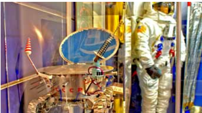
Mit dem Mondmobil Lunochod konnte der Mond erstmals mobil erkundet werden. Der aufklappbare Deckel lud tagsüber die Batterien auf und wurde am Abend geschlossen.
