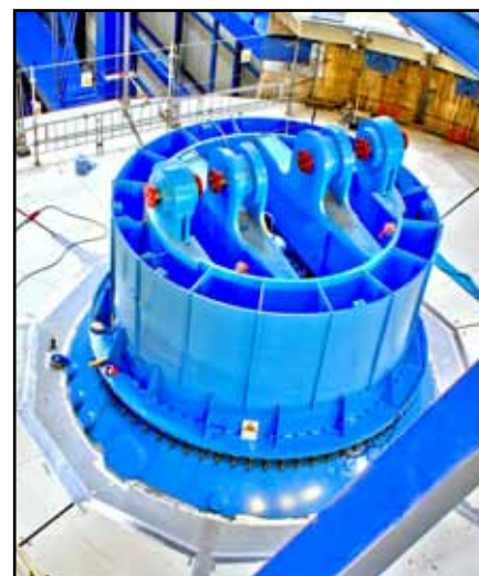
Eine imposante Hebeeinrichtung wird den Reaktorbehälter anheben.
