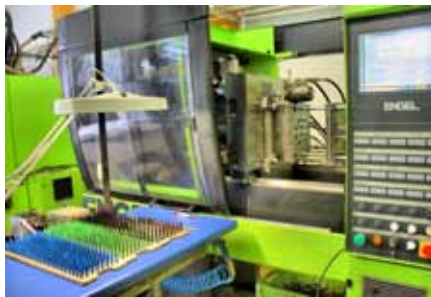
Hochwertige Spritzgießmaschinen von Engel produzieren exakt passende Kunststoffteile. Darunter den Tank für den Cleo-Kolbenfüllhalter.
