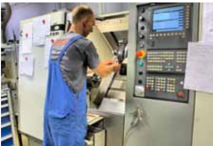
Auf hochwertigen Drehmaschinen, wie etwa einer DMG CTX 310, werden funktionswichtige Bauteile für Cleo-Schreibgeräte aus dem Vollen gedreht.
