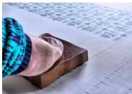
Handarbeit ist beim Direktdruck von Stoffen angesagt. Damit die Muster sauber anschließen ist ein gutes Auge nötig.
