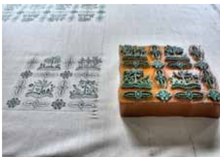
Formenstecher müssen spiegelverkehrt arbeiten, damit nach dem Druck das Muster sich korrekt am Stoff abzeichnet.
