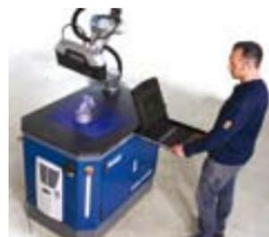
sungen erforderlich sind. Der Factory Array Imager ist ein auf Blaulicht-Technik beruhender neuer 3D-Sensor mit extrem hoher Messgenauigkeit, der rasch hochauflösende Daten für die Maßprüfung an Bauteilen, Baugruppen und Werkzeugen erfasst. In Verbindung mit einem kollaborativen Roboter ist der Robo-Imager eine betriebsbereite Lösung zur Automatisierung der Inspektion und Prüfung von Bauteilen überall in der Produktionsumgebung.
