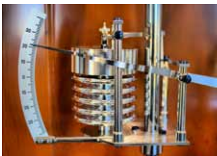
Zur Kompensation von Luftdruckschwankungen bewegt ein Barometerinstrument ein Gewicht auf oder ab.
