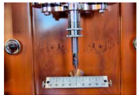
Die Längenänderung des Invar-Pendels wird durch die Längenausdehnung eines Baustahl-Elements ausgeglichen.
