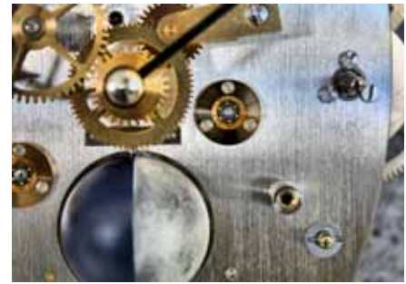
Kleine Präzisionskugellager sind ein wichtiges Detail, um die Präzision der Großuhren von Sattler sicherzustellen.
