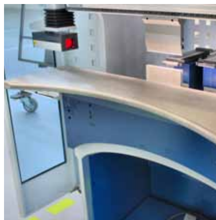
Ein Laser-Sicherheitssystem verhindert, dass Finger oder Hände der Bedienperson gequetscht werden.
