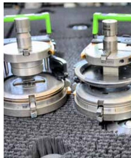
Die RTC-Werkzeugkassetten bestehen aus faserverstärktem Kunststoff, besitzen daher nur ein geringes Gewicht.
