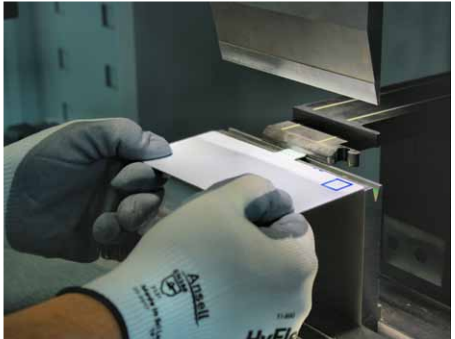
CNC-gesteuert Anschläge sorgen dafür, dass die Biegung von bis zu 500 Millimeter tiefen Blechlaschen sicher gelingt. Ein Biegelinienlaser zeigt zudem an, ob das Teil korrekt positioniert ist. Dies gibt Sicherheit, ehe der Biegevorgang gestartet wird.
