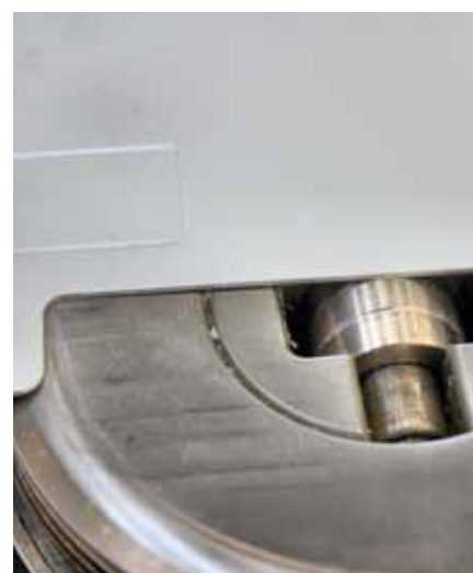
Ein besonderes Werkzeug erlaubt das Entgraten von Ausklinkungen.
