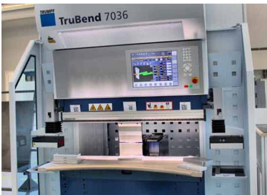
Bis zu 1020 Millimeter lange Blechteile können mit der ›TruBend 7036‹ gebogen werden. Die Maschine überzeugt mit vielen Detaillösungen, die rasch zum Biegeteil führen.
