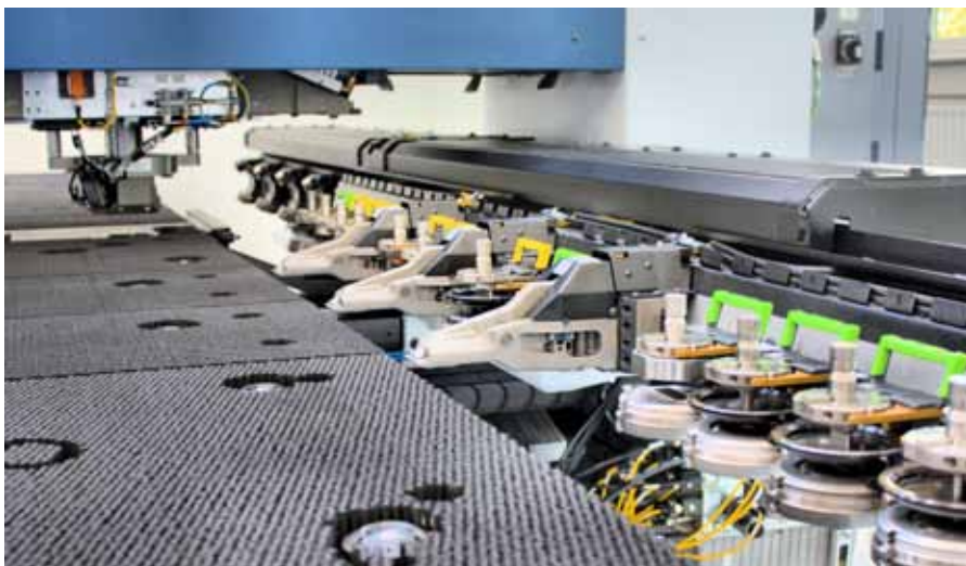
Je nach Ausführung kann die TruPunch 1000 zwischen 18 und 21 Werkzeuge im Magazin vorhalten. Mit dem ›MultiTool‹ ist es sogar möglich, bis zu zehn verschiedene Einsätze in einer einzigen Werkzeugaufnahme unterzubringen.
