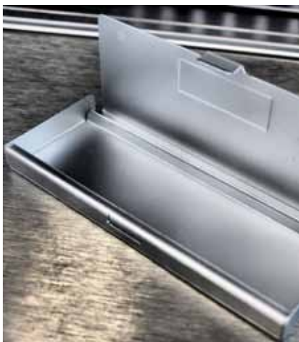
Rund 7,5 Minuten dauert die Fertigung dieses Biegeteiles unter Einsatz der TruPunch 1000 sowie der TruBend 7036.
